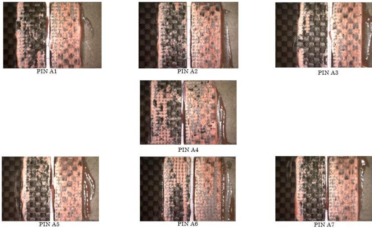
Fig. 4.31 Superfici di frattura degli aderendi (Pin) in seguito a prova di trazione
