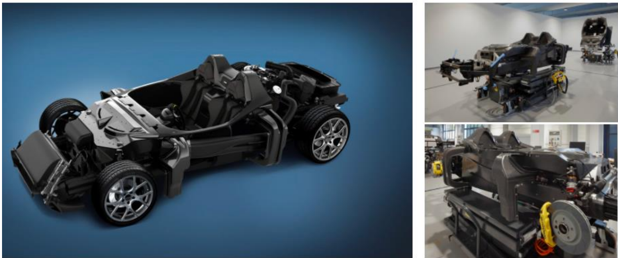
Fig. 1.5 linea di assemblaggio della Dallara stradale: produzione della monoscocca, realizzata da Dallara compositi, e installazione di telaietti anteriori e posteriori in alluminio. [8]
