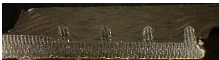
Fig. 4.42 rilevazione al microscopio ottico della zona di overlap
