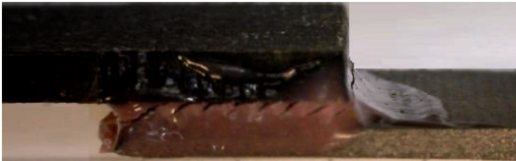
Fig. 4.27 vista laterale del provino 3: rottura dell'adesivo
