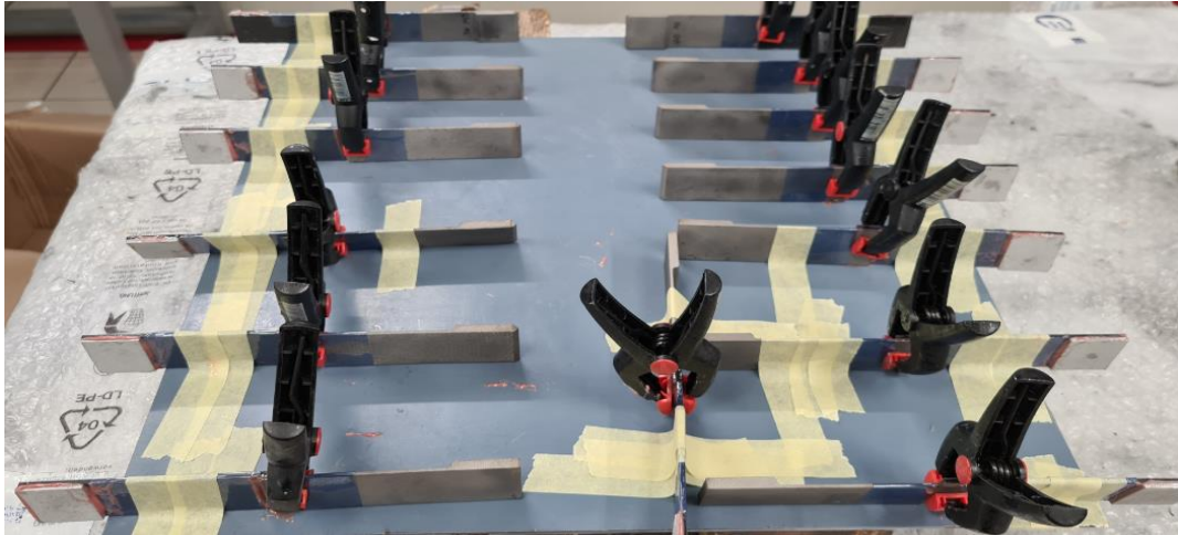
Fi g. 3.11 provini allineati con pinze di fissaggio e disposti su un pannello per il ciclo di cura in forno
