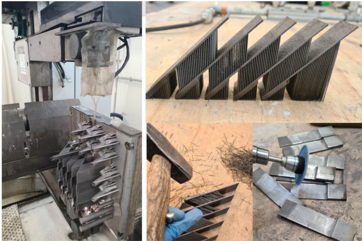
Fig.3.5 Taglio a filo EDM e rimozione manuale dei supporti
