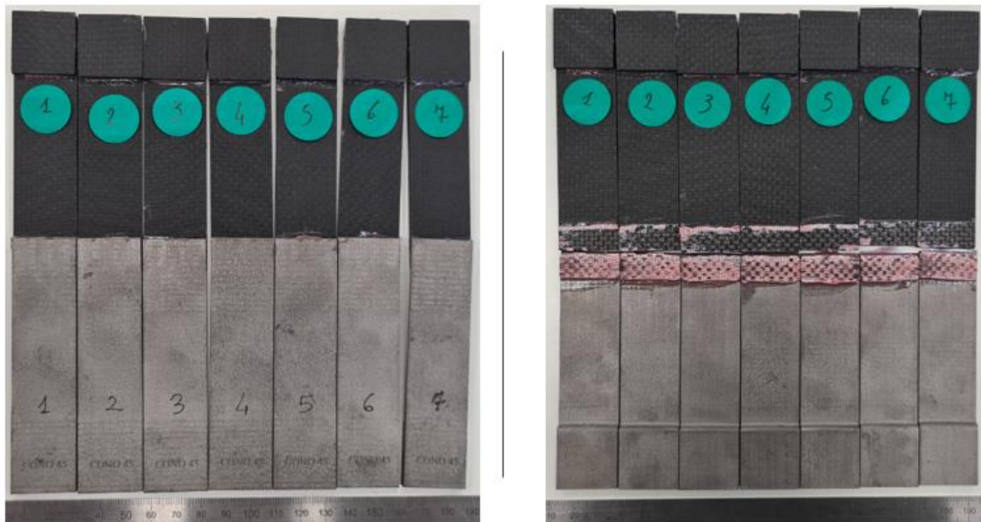
Fig.4.38 provini con struttura grip “cono 45°” prima e dopo rottura
