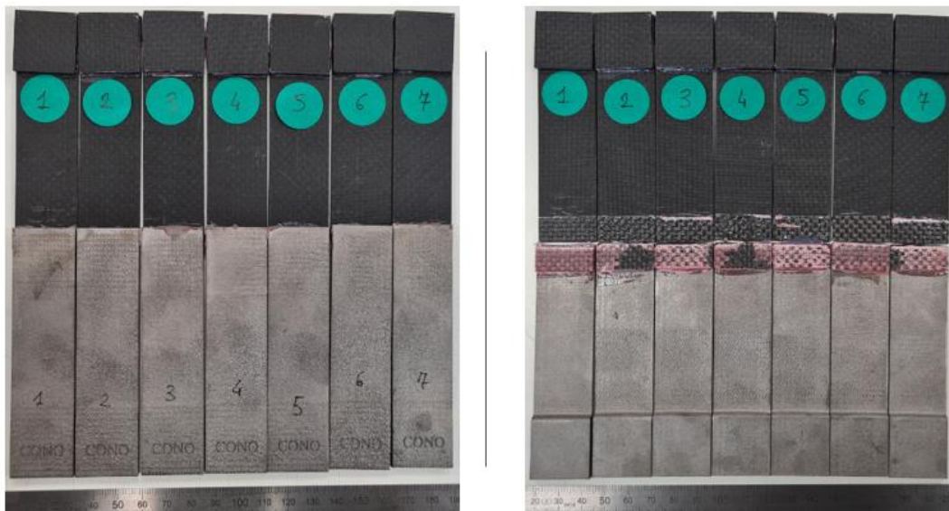
Fig.4.35 provini con struttura grip “cono” prima e dopo rottura
