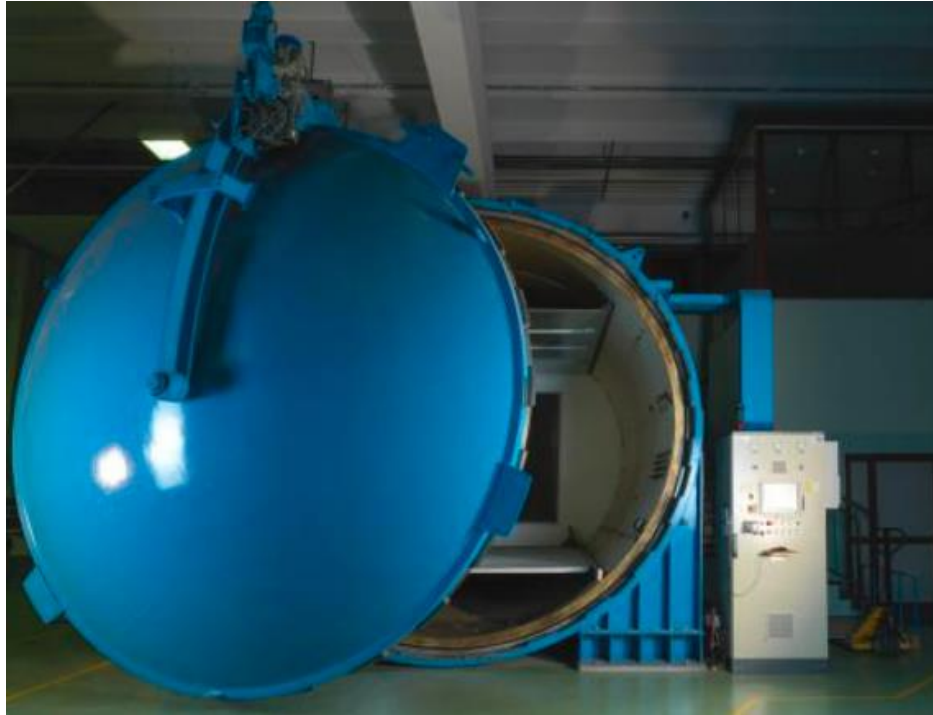
Fig. 1.4 tecnica di produzione del CFRP in autoclave [7]
