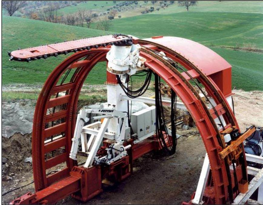
Figura 1.19: Macchina per l'esecuzione del pretaglio meccanico a piena sezione realizzata per la linea ferroviaria Sibari-Cosenza (Lunardi, 2006)
