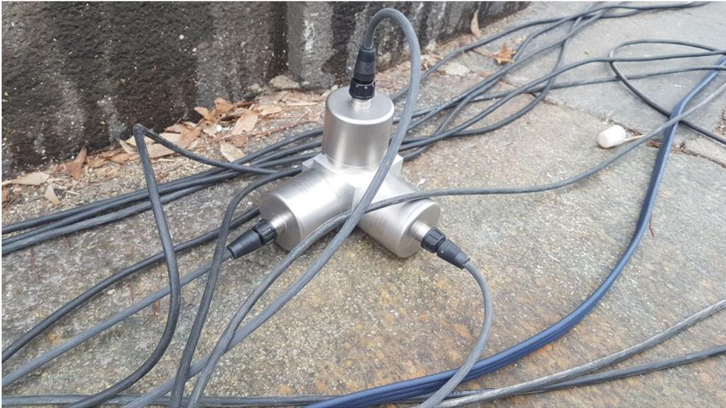
Figura 5.7. Accelerometro triassiale
