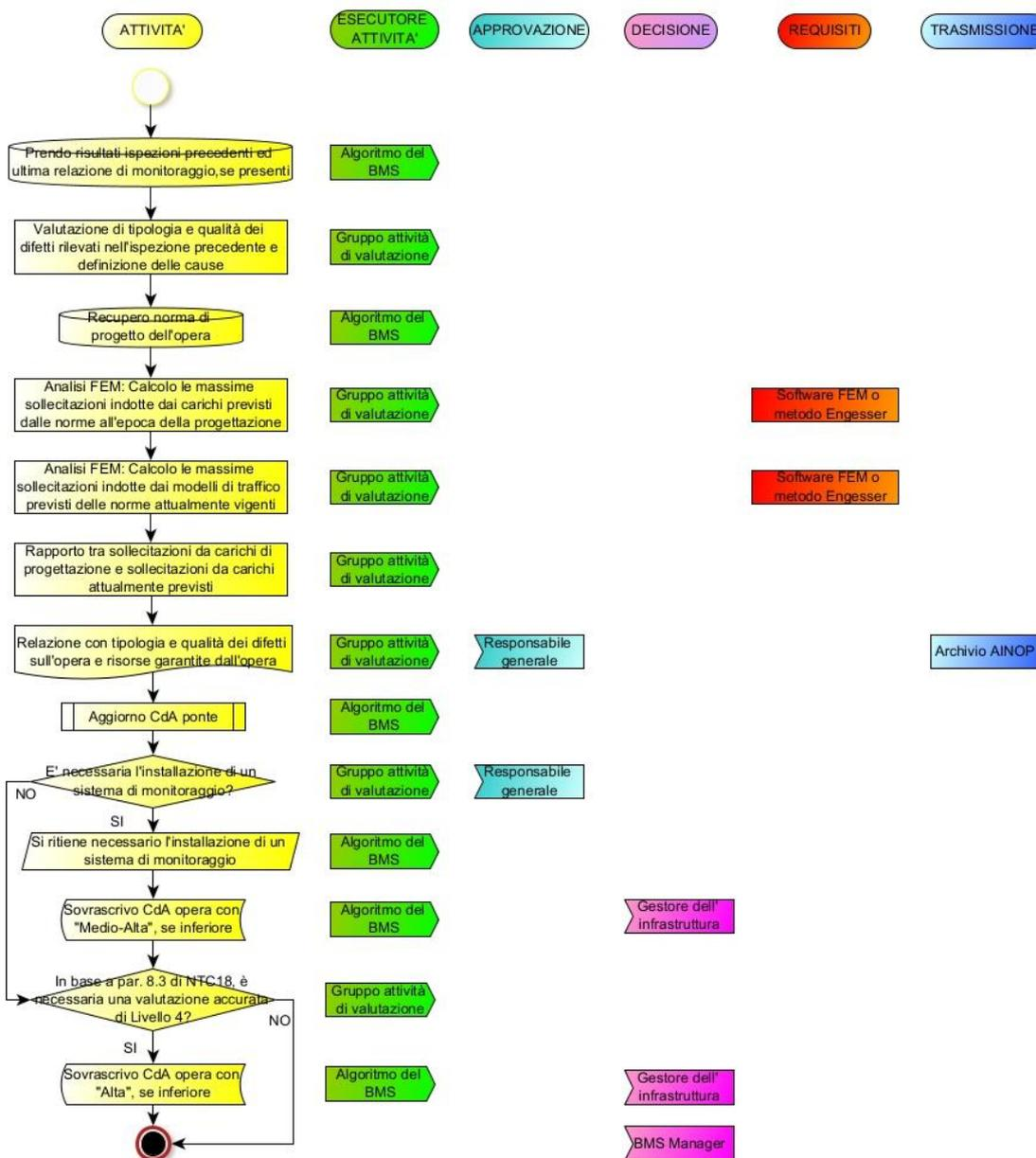
Fig. 5.17 – Processo "Valutazione preliminare dell'opera".
