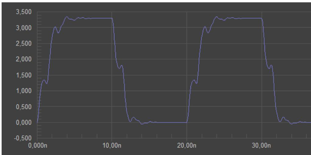
**Figura 2.11:** Signal Integrity del Segnale di un bit della SDRAM
