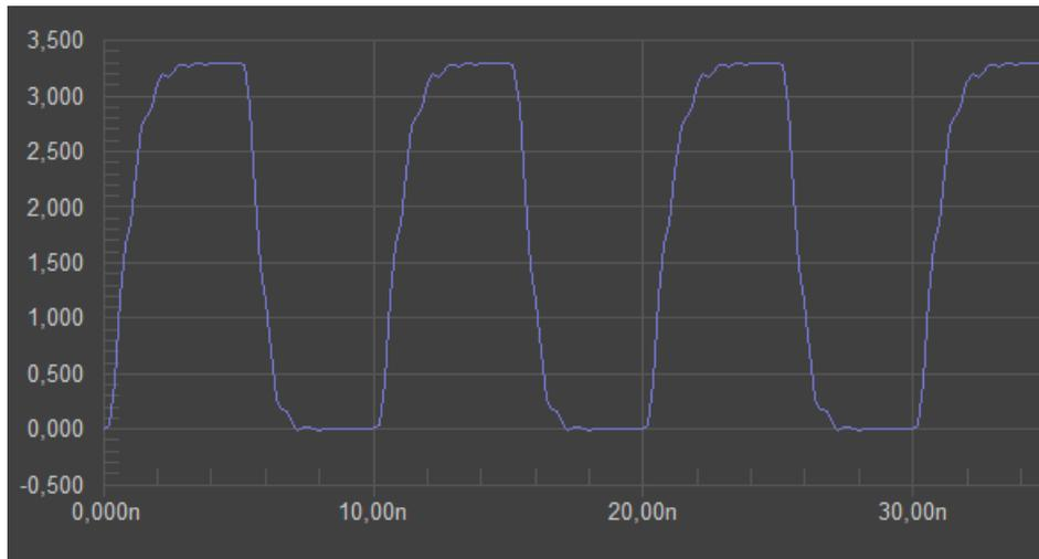
**Figura 2.10:** Signal Integrity del Segnale di CLK della SDRAM
