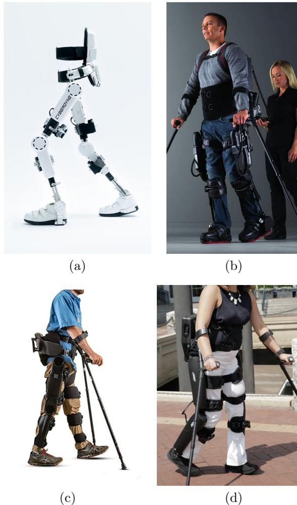
Figure 1.2: (a) HAL; (b) EKS0; (c) Indego; (d) ReWalk;
