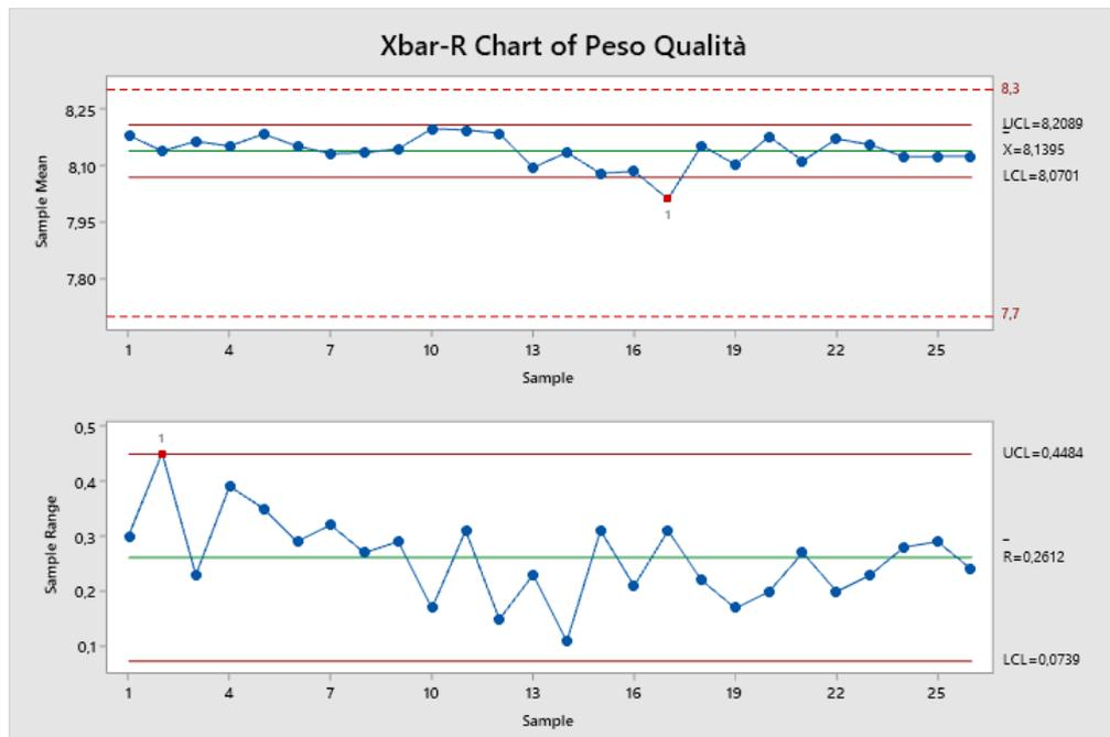
Figura 64: X-R carta di controllo del "Peso capsula" rilevato dagli operatori di qualità
