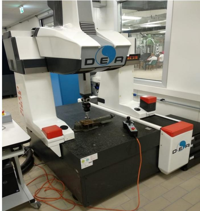
Figura 20. Macchina di misura a coordinate DEA Iota 0101
