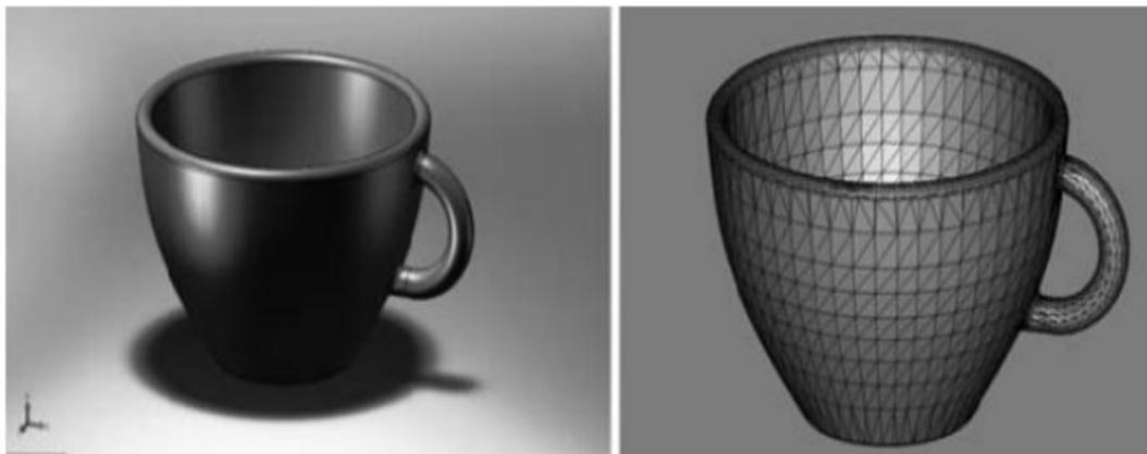
Figura 6. Esempio di transizione da modello CAD a formato STL [8]
