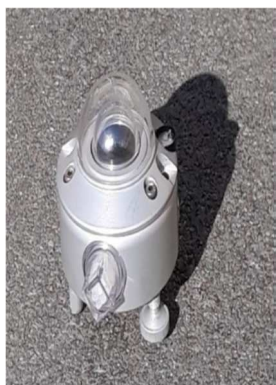
Figura 4-6: Piranometro per la misura dell'irradianza.
