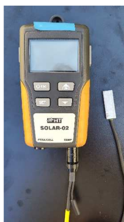
Figura 4-4: Strumento per la misura della temperatura delle celle del modulo
