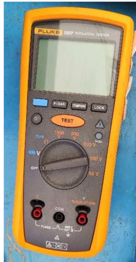
Figura 4-14: Fluke 1507 per la misura della resistenza d'isolamento
