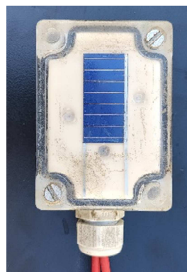
Figura 4-7: cella fotovoltaica per la misura dell'irradianza.
