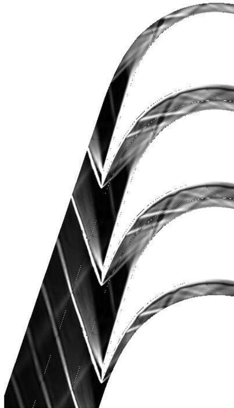
Figura 5.23: Ricostruzione Schlieren numerica schiera - beta 80.32°
