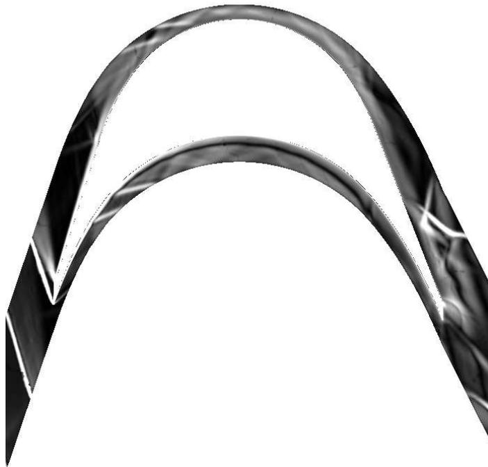
Figura 5.31: Mach - Simulazione 140000 celle - beta 77.32°
