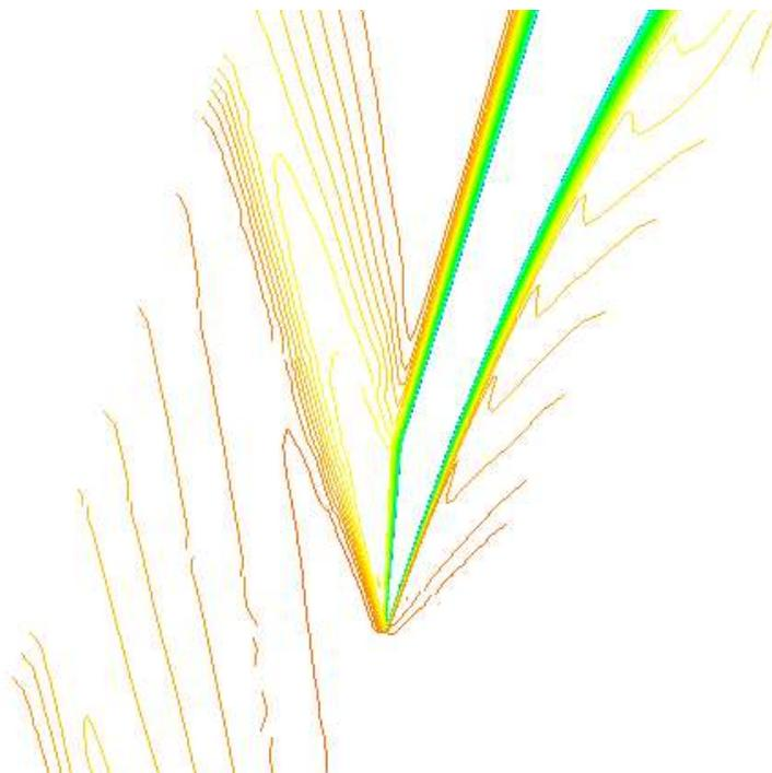
Figura 4.18: Urto e fascio di espansione al bordo d'attacco - linee iso-Mach
