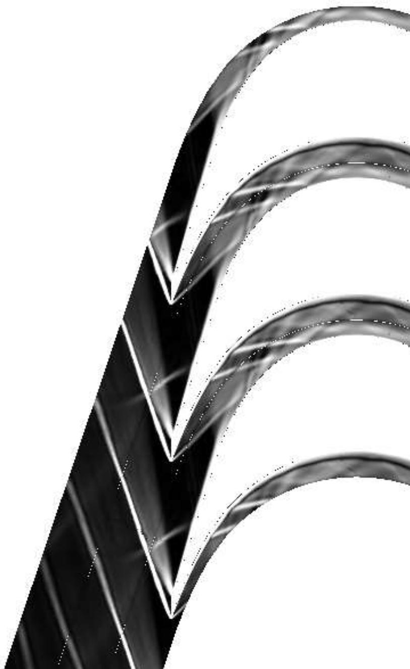
Figura 4.40: Ricostruzione Schlieren numerica della schiera - close up
