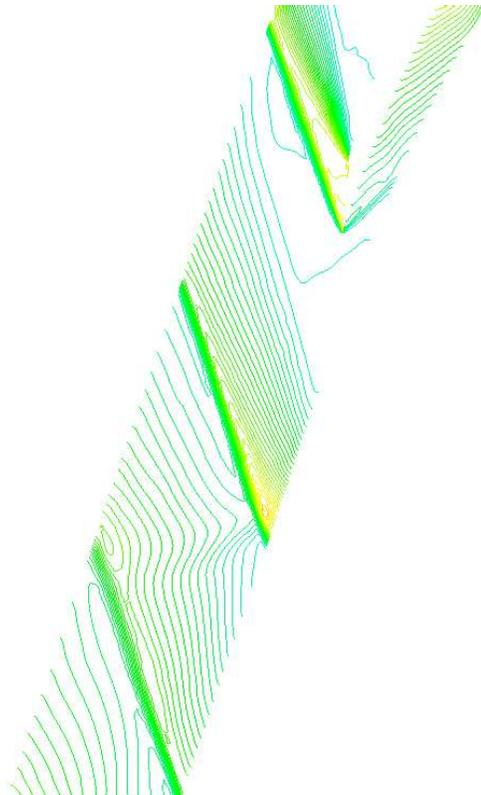
Figura 4.33: Linee iso-pessione - close up urto e fascio di espansione al bordo d'attacco
