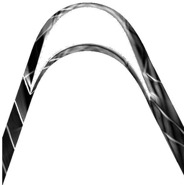
Figura 5.6: Riproduzione di Schlieren numerica paletta singola - beta  $78.32^\circ$
