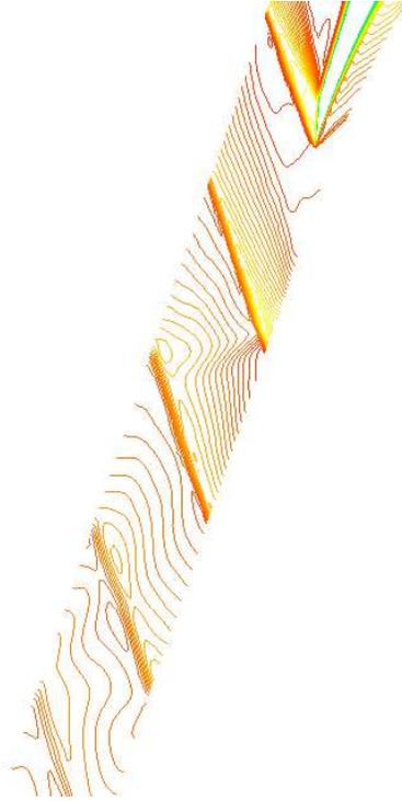
Figura 4.29: Linee iso-Mach - urti e linee d'espansione
