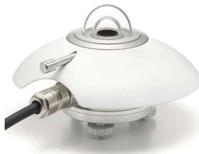
Figura 1.25 – Esempio di piranometro. [9]
