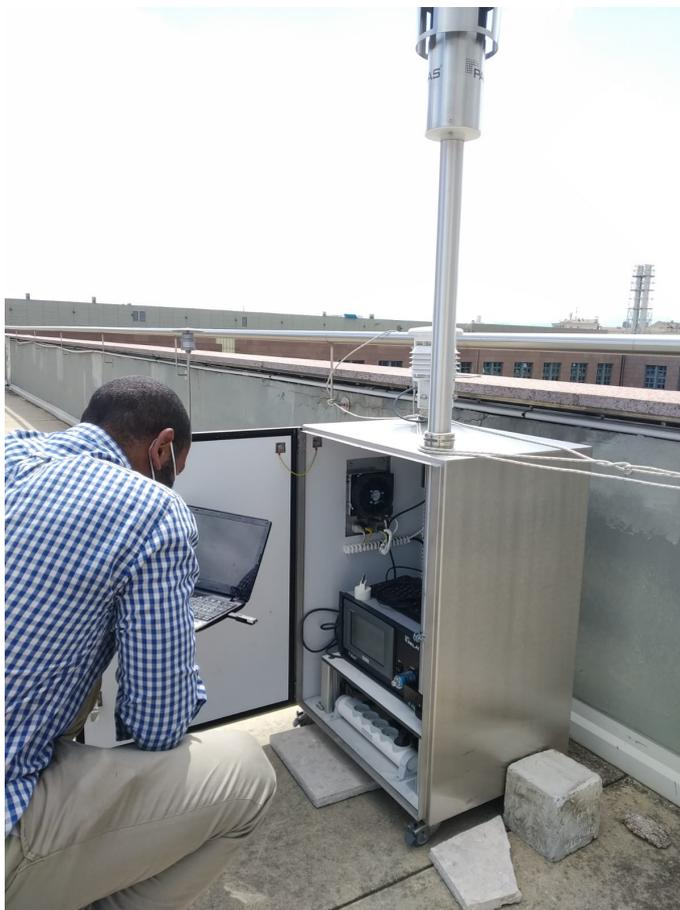
Figura 49: Fase di recupero dati dall'analizzatore Palas Fidas 200S
