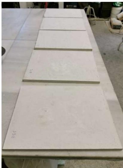
Fig. 3.16: Lastre da sottoporre a flessione
