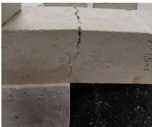
Fig. 5.2: Il provino dopo prova in flessione (1,5% di fibre di salviettine)
