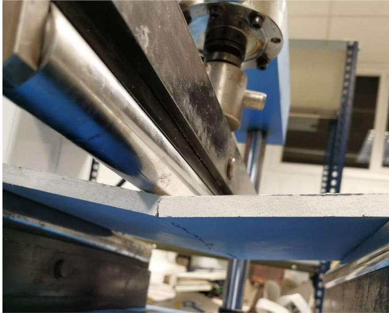
Fig. 5.7: Piastra spezzata con tamponi durante la prova
