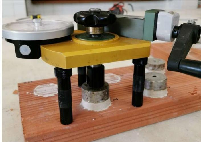
Fig. 3.15: Apparecchiatura utilizzata per la prova di aderenza
