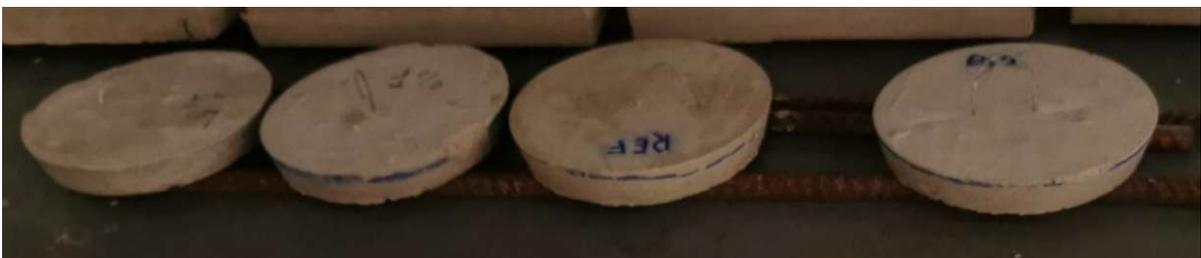
Fig. 3.11: Provini per la prova di permeabilità al vapore acqueo
