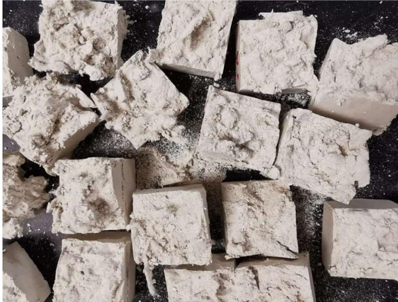
Fig. 5.6: Provini rotti a mano per poterne osservare delle fibre interne
