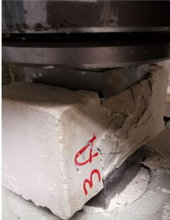
Fig. 5.4: Provetta durante la prova di compressione (1,5% di fibre di salviettine)
