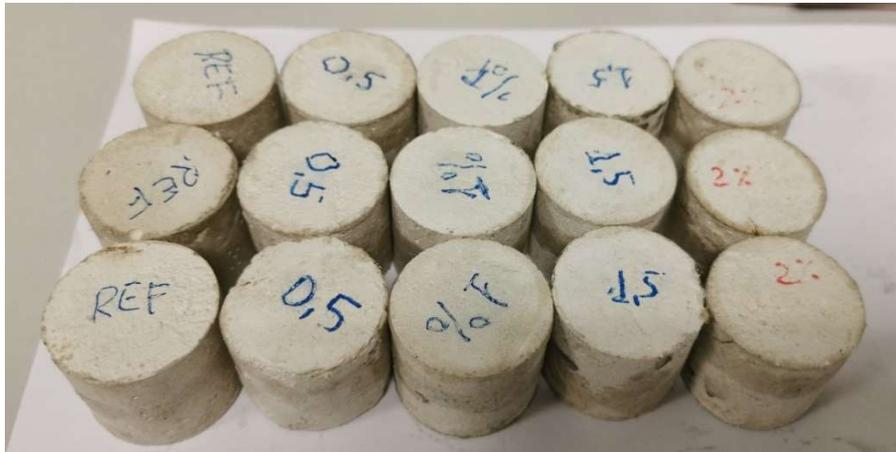
Fig. 3.23: Provini per il tubo di impedenza
