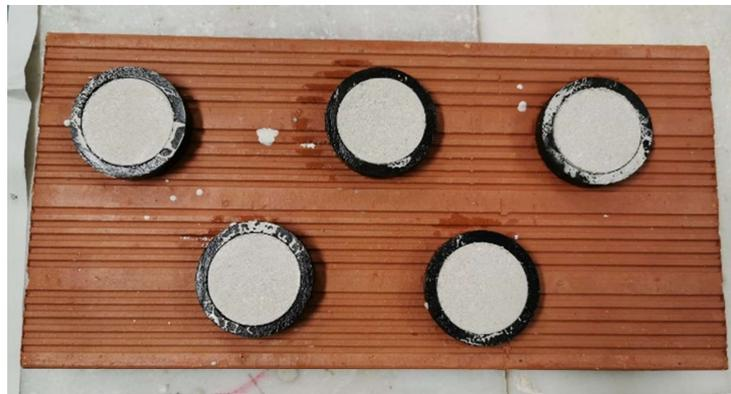
Fig. 3.13: Provini per prova di aderenza
