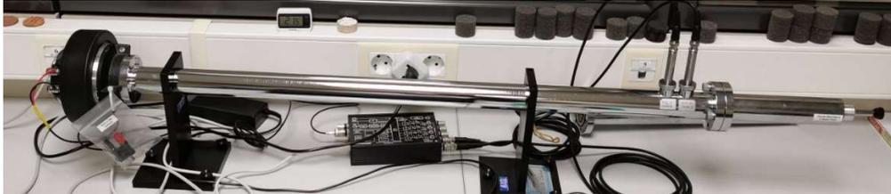
Fig. 3.22: Tubo di impedenza
