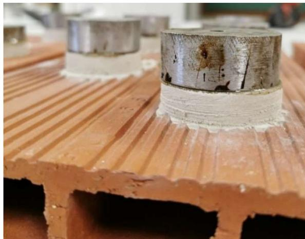
Fig. 3.14: Provino incollato al disco metallico per poterlo poi porre in trazione con la macchina
