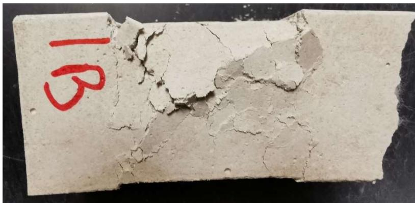
Fig. 5.5: Provetta dopo la prova di compressione (1,5% di fibre di salviettine)
