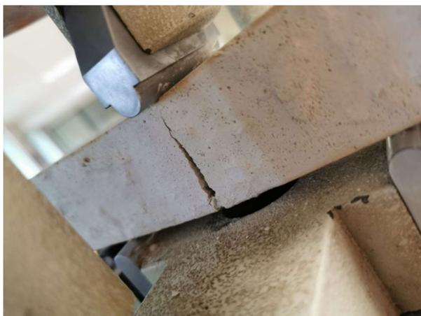
Fig. 5.1: Provino in flessione (1,5% di fibre di salviettine)
