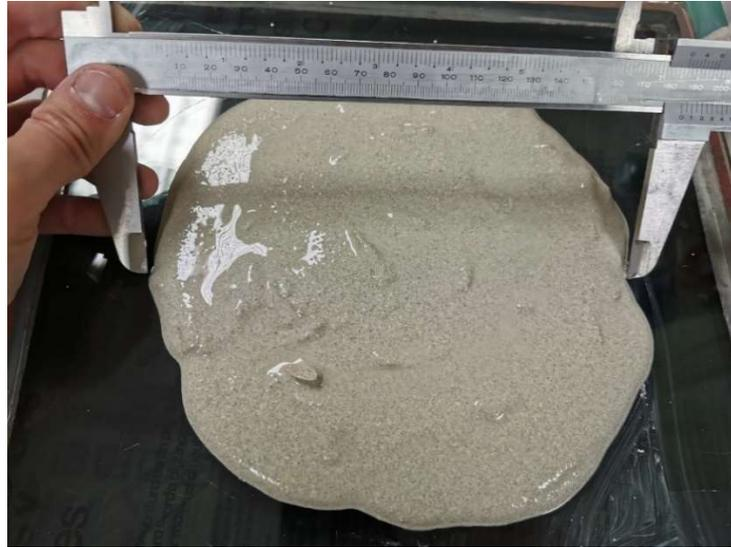
Fig. 3.3: Misura del diametro della forma della miscela di Iberplast YG con rapporto acqua/gesso=0,65 e % fibre in peso=0,3
