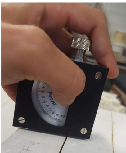
Fig. 3.6: Dispositivo misura durezza superficiale in SHORE C
