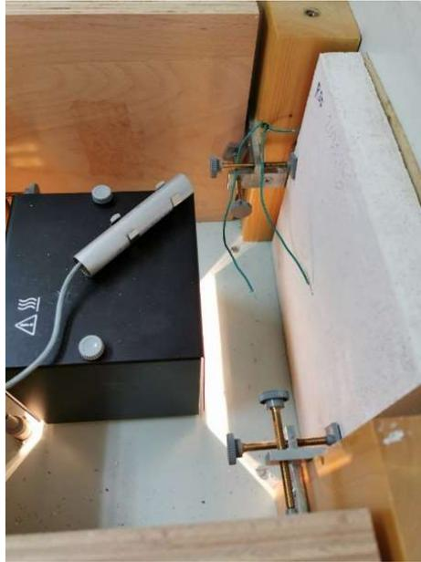
Fig. 3.21: Sensori di misura di temperatura interni all' apparecchio
