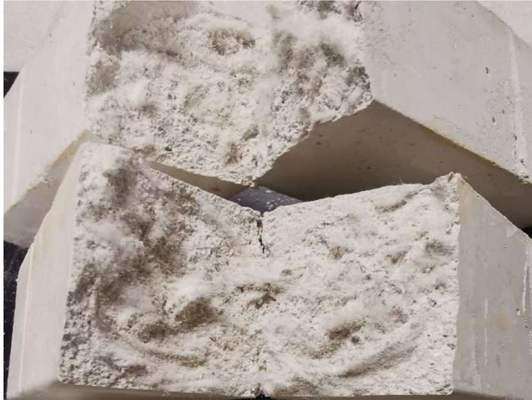
Fig. 5.3: Salviettine che resistono alla flessione nel mezzo della provetta, quindi alla rottura del gesso (1,5% di fibre di salviettine)
