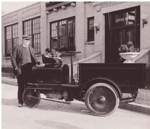
**Figura 5: Un membro della Clark Company con il primo prototipo di carrello elevatore**
