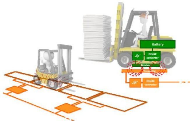
**Figura 22: Schema della tecnologia Enermove**
