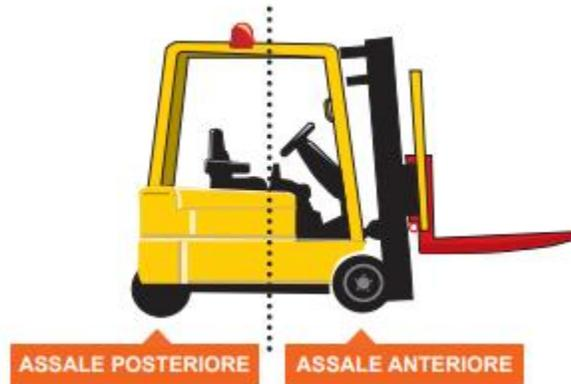
**Figura 12: Asse posteriore e anteriore di un carrello elevatore**
