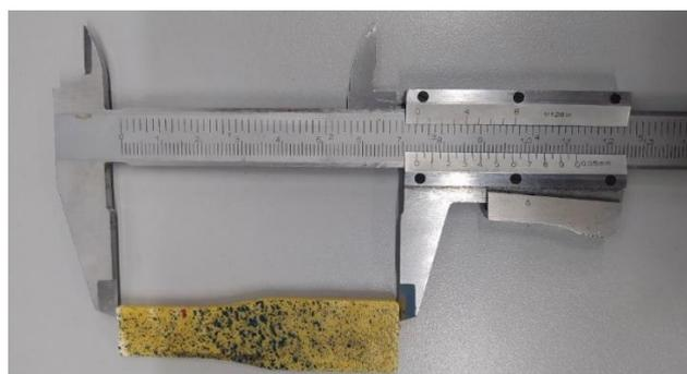
Figura 94. Misura sul provino fisico della distanza tra un'estremità e il punto di rottura con l'utilizzo di un calibro
