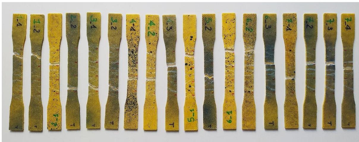
Figura 79. Provini dopo essere stati sottoposti a trazione
