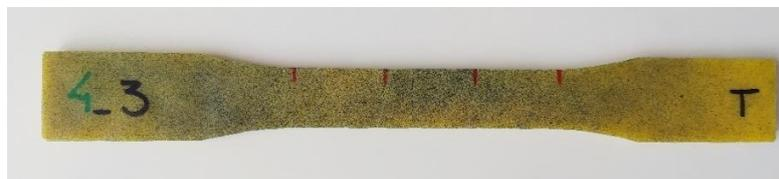
Figura 75. Trattamento della superficie di un provino prima della prova di trazione
