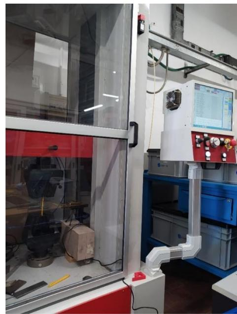
Figura 76. Configurazione della prova di trazione con monitoraggio DIC
