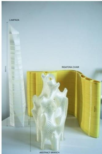
Figura 3. Esempi di oggetti comuni realizzati con tecnica FDM
