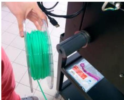
*Figura 44.* Bobina posta nella parte posteriore della stampante
