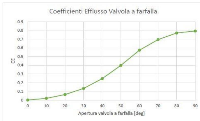
Figura 3-5: coefficienti di efflusso valvola a farfalla
