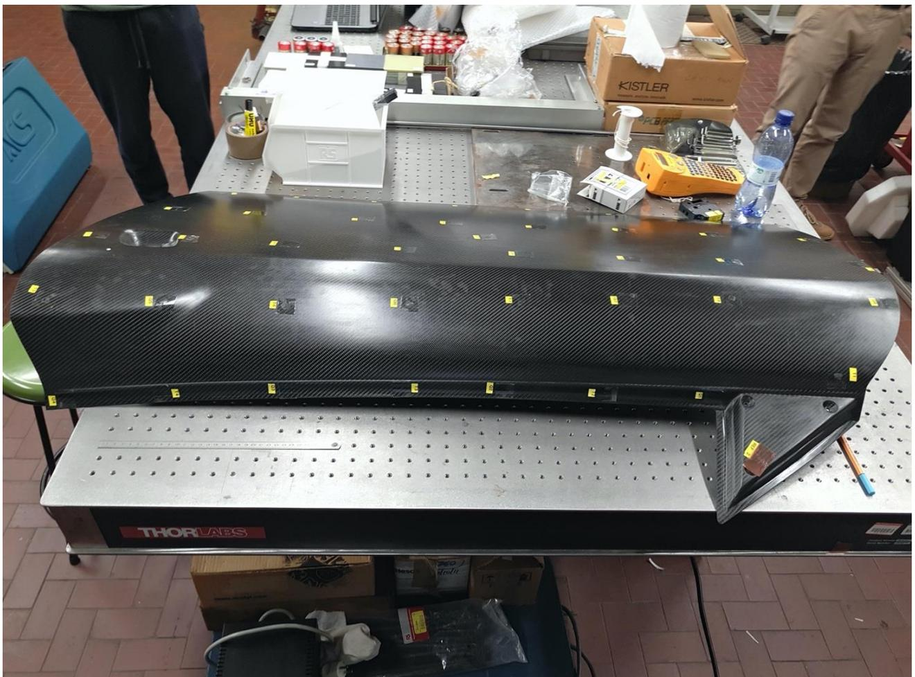
Figura 39 Rappresentazione della portiera con i punti di misurazione. Fonte [3]
