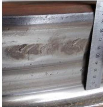
Figura 56 Fessurazione e rifollamento nelle zone di contatto
