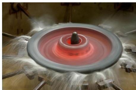
Figura 39 Trattamento termico superficiale delle ruote
