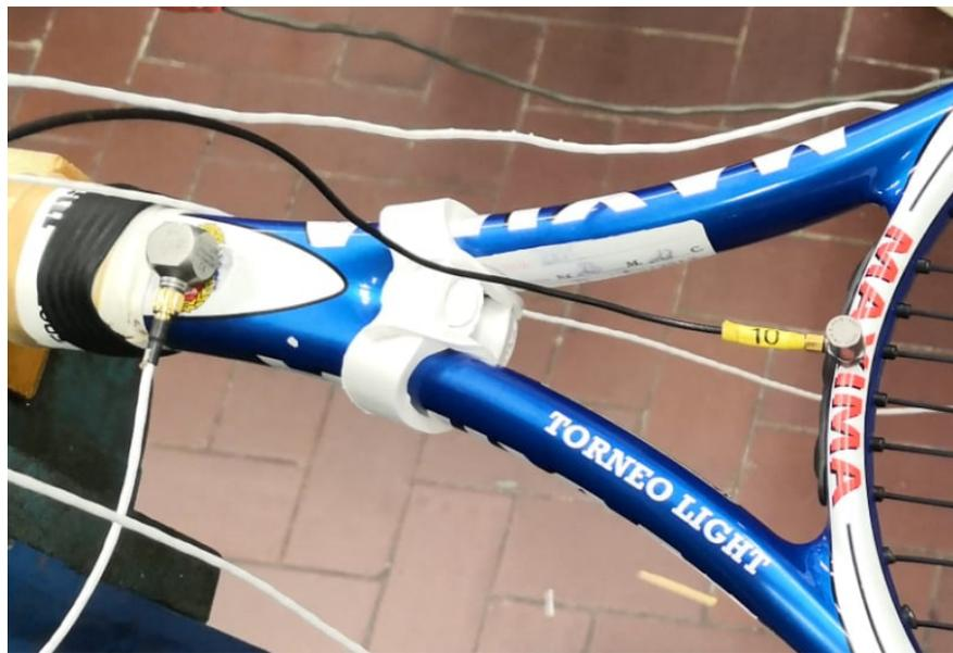
Figura 5.3: Posizionamento del dispositivo Fluendo sul telaio della racchetta
