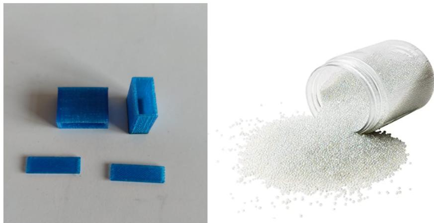
Figura 5.4: Elementi utilizzati per simulare lo smorzatore granulare: contenitori cavi e sferette in vetro
