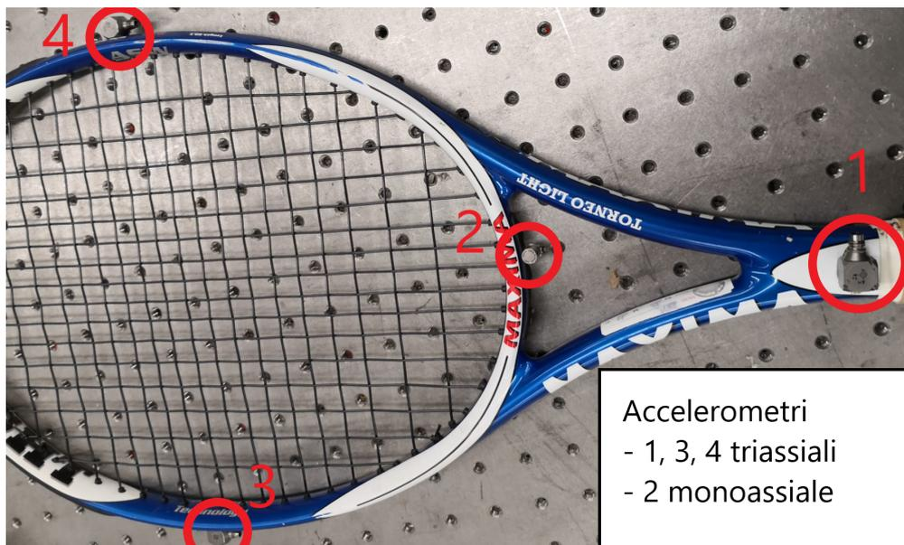
Figura 5.6: Posizionamento degli accelerometri sul telaio della racchetta
