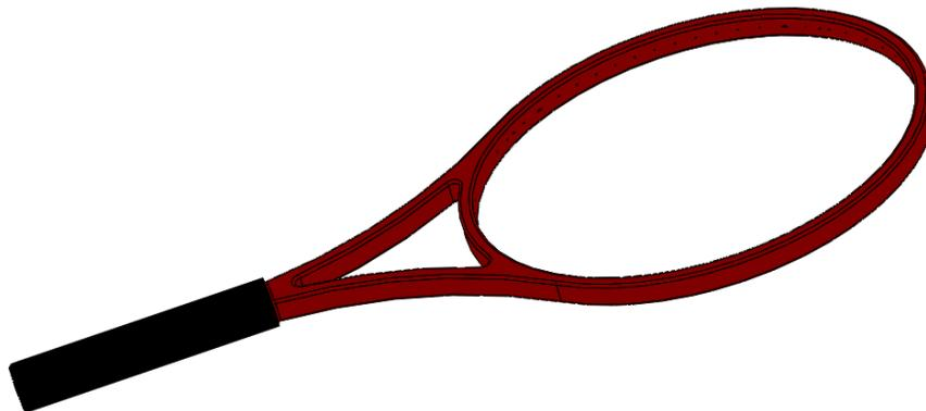
Figura 4.4: Modello del telaio di una racchetta da tennis
