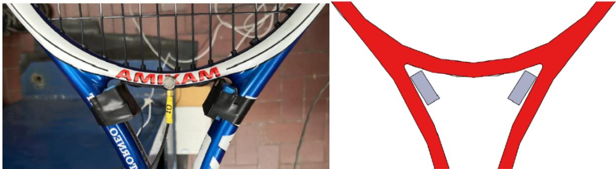
Figura 4.30: Rappresentazione dello smorzatore granulare: prototipo testato (sinistra) e modello CAD (destra)
