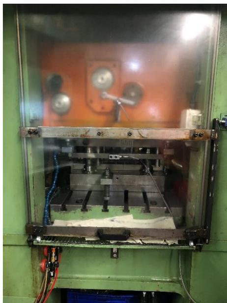
*Figura 5.1-Stampo montato in pressa.*
