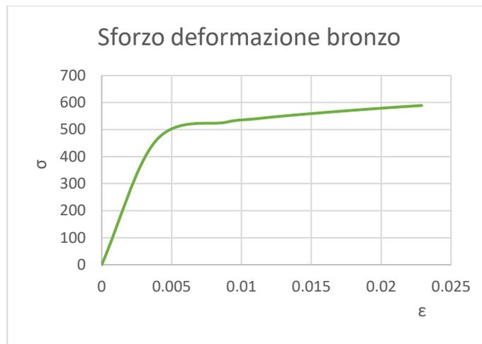
Figura 4.8-Curva stimata sforzo deformazione  $\sigma$ - $\epsilon$  bronzo.
