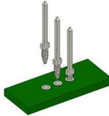
Figura 2.2-Schematizzazione operazione di inserimento.
