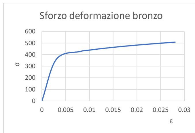
Figura 4.6-Curva stimata sforzo deformazione  $\sigma$ - $\epsilon$  bronzo.
