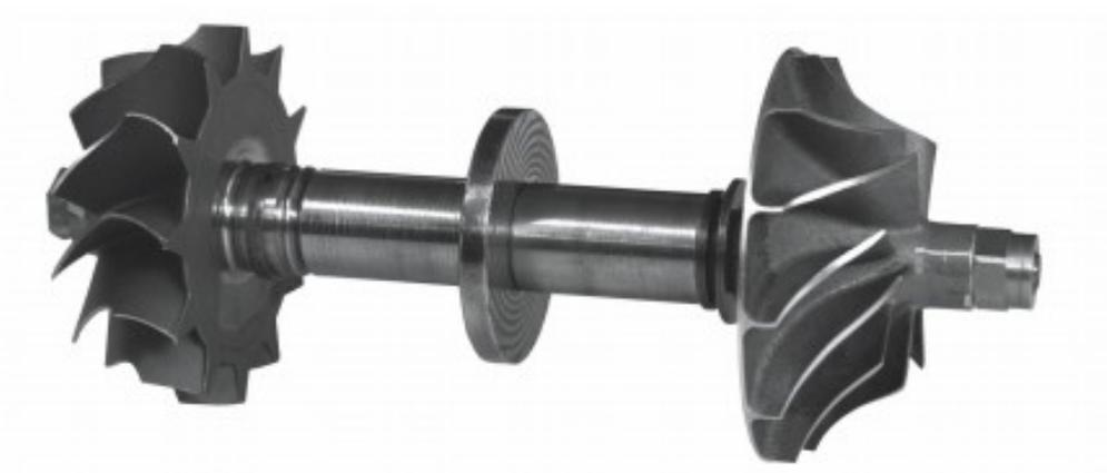
*Figura 6.4 – Gruppo rotore modificato con perni radiali maggiorati e disco con scanalatura a spirale assiale centrale*
