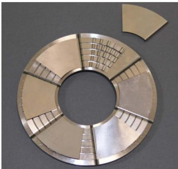
*Figura 7.9 – Cuscinetto ad aria assemblato e supporto separato*
