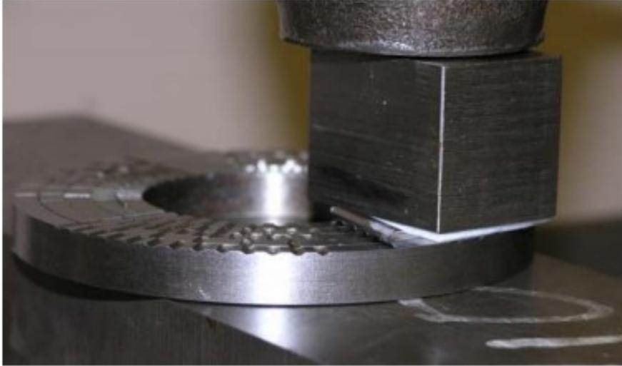
*Figura 7.7 – Processo di formatura del Bump foil*
