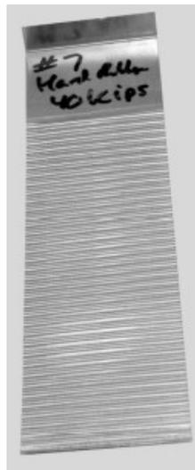
*Figura 7.1 - Lamina del Bump foil dopo formatura*
