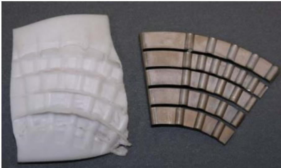
*Figura 7.8 – Anelli del Bump foil e stampo del Bump foil*
