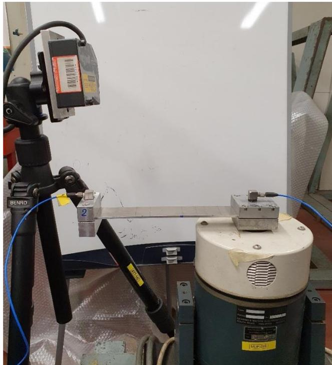
*Figura 28: componente in prova sulla tavola vibrante*
