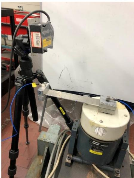
Figura 39: testina laser del trasduttore
