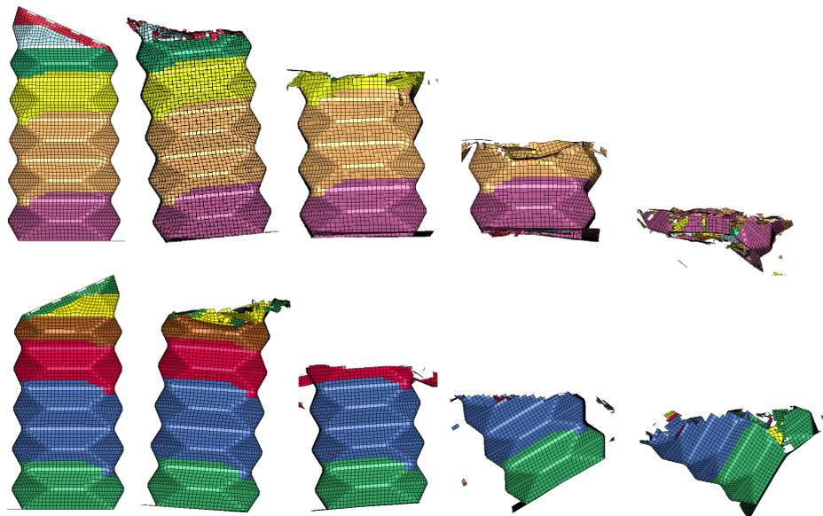
Figura 7.4: Deformazione della crash box Origami destra (in alto) e sinistra (in basso) con una velocità iniziale di 56 km/h.
