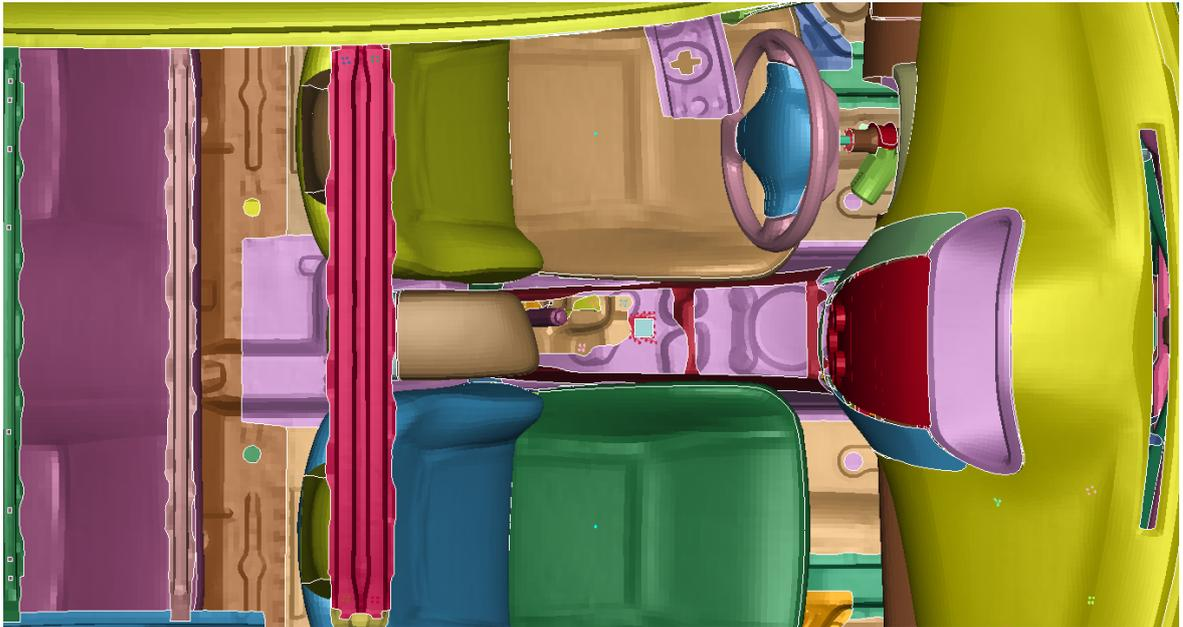
Figura 2.16: Posizione dell'ELEMENT\_SOLID per il calcolo dell'accelerazione nel centro di massa del veicolo.
