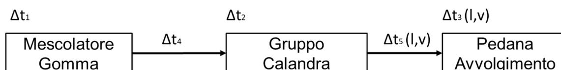
**Figura 86** Calcolo dei tempi ciclo di produzione per la sincronizzazione dei dati di qualità con i dati di vibrazione. Il tempo ciclo di trasporto del tessuto dal gruppo calandra verso la pedana di avvolgimento dipende dalla lunghezza  $l$  del prodotto e velocità  $v$  di avanzamento lineare della linea.
