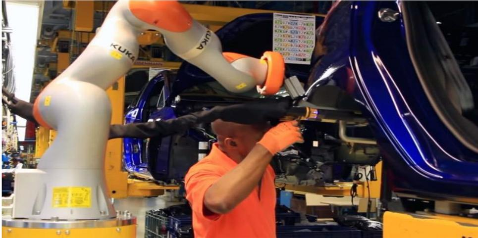
Figura 1.3: Cobot realizzato da KUKA per installare ammortizzatori su *Ford Fiesta* [5].
