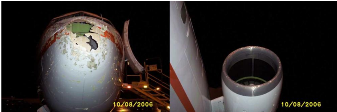
Figura 1.1 Danno causato dalla grandine al volo 705BX della BAX Global [13]
