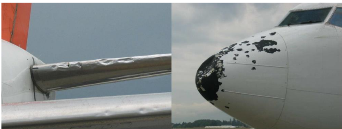
Figura 1.2 Danno causato dalla grandine ad un Boeing 737 [13]
