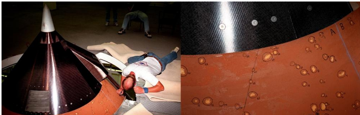
Figura 1.3 Danno causato dalla grandine, estremo superiore serbatoio combustibile, Shuttle Discovery missione STS-96 [11]
