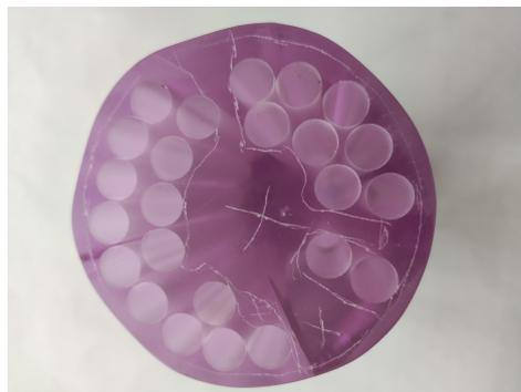
Figura 52: Superficie trasversale di un monocristallo di Nd:YAG dalla quale sono stati estratti dei rod
