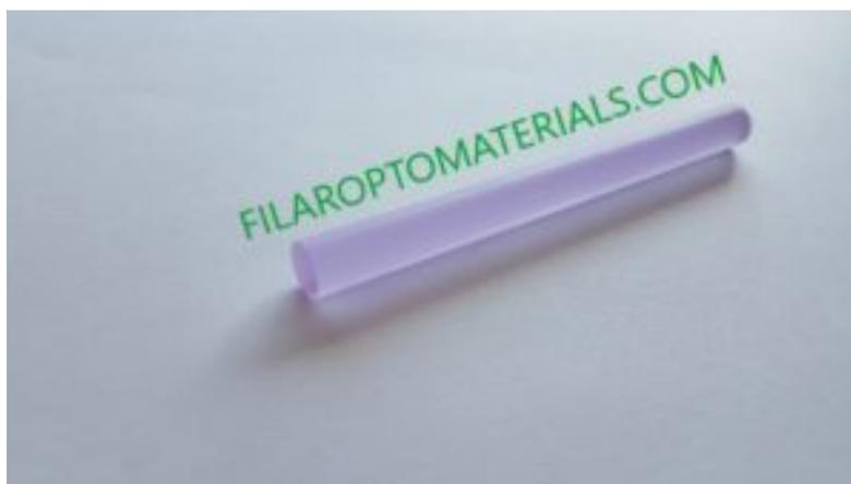
Figura 50: Rod di Nd:YAG
