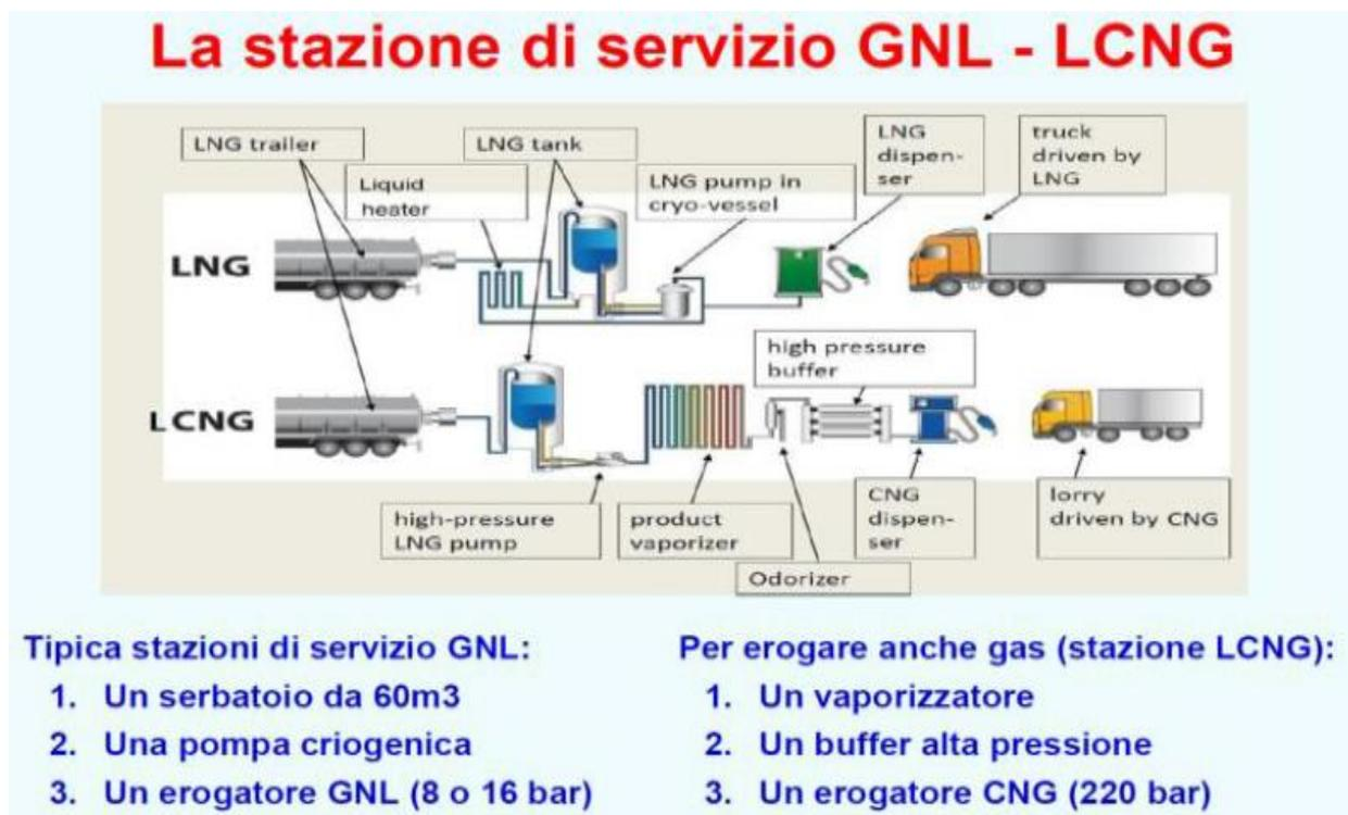
Figura 48: Schema tecnico distributore GNL e L-GNC, fonte [23]
