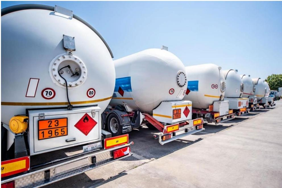
Figura 24: Foto di autocisterne per la movimentazione di gas, fonte Levorato Vettore.
