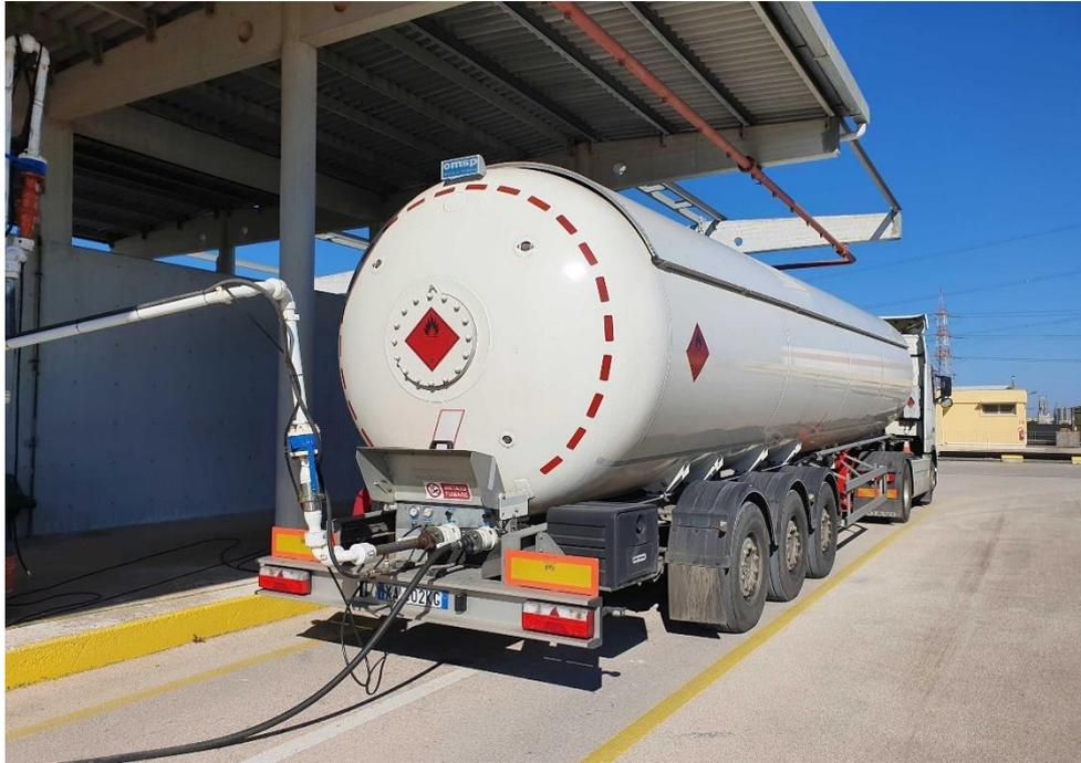
Figura 40: Foto dell'autobotte in fase di carico in IPEM, fonte aziendale.
