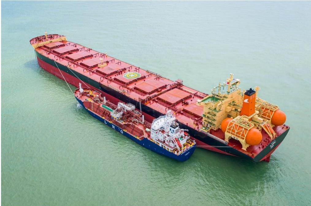
Figura 45: Foto nave a GNL con serbatoi a bordo in vista.
