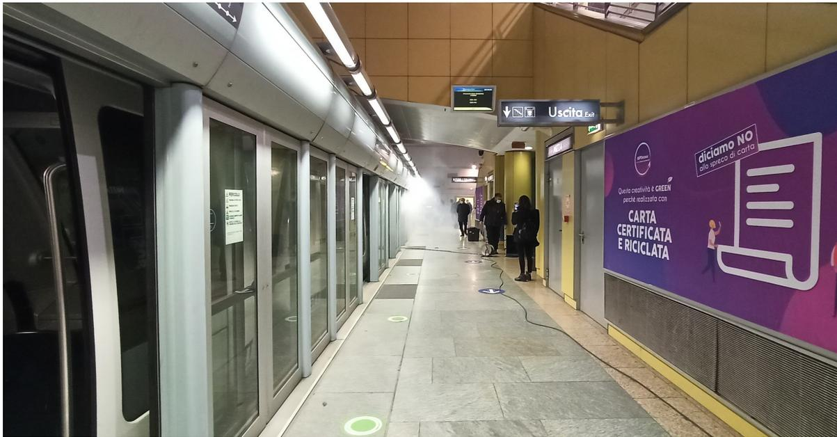
Figura 4.87 – Andamento dei fumi prova 1
