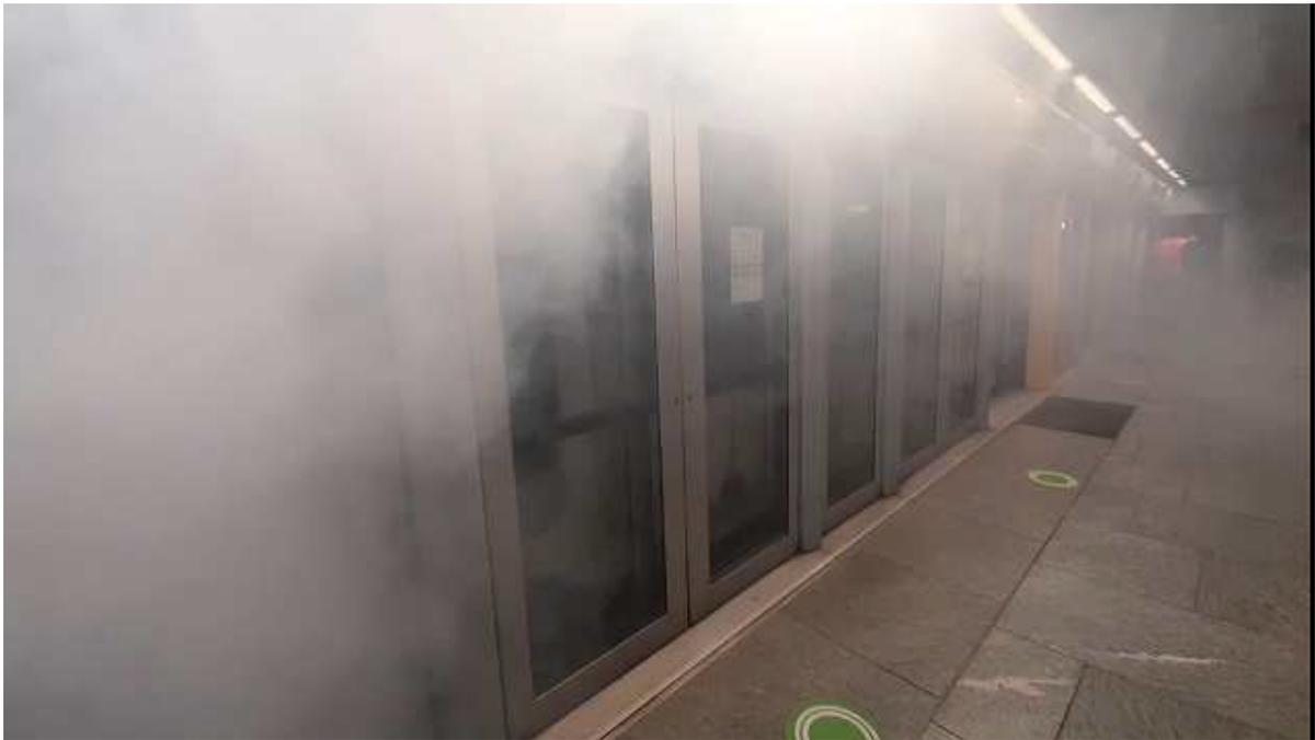
Figura 4.89 – Andamento dei fumi prova 2 con ventilazione di galleria attivata – tratta dal report di Infra.To
