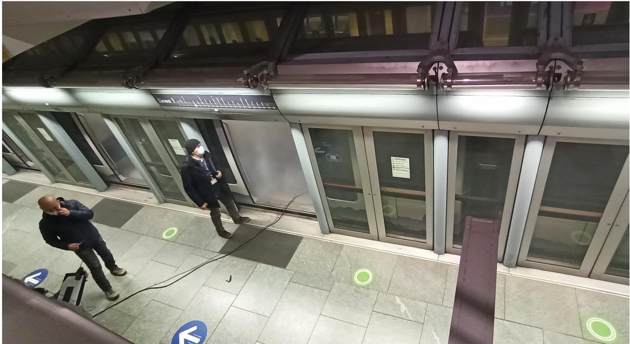
Figura 4.90 – Andamento dei fumi prova 3: il fumo rimane confinato negli interstizi tra le porte della banchina e le porte del veicolo
