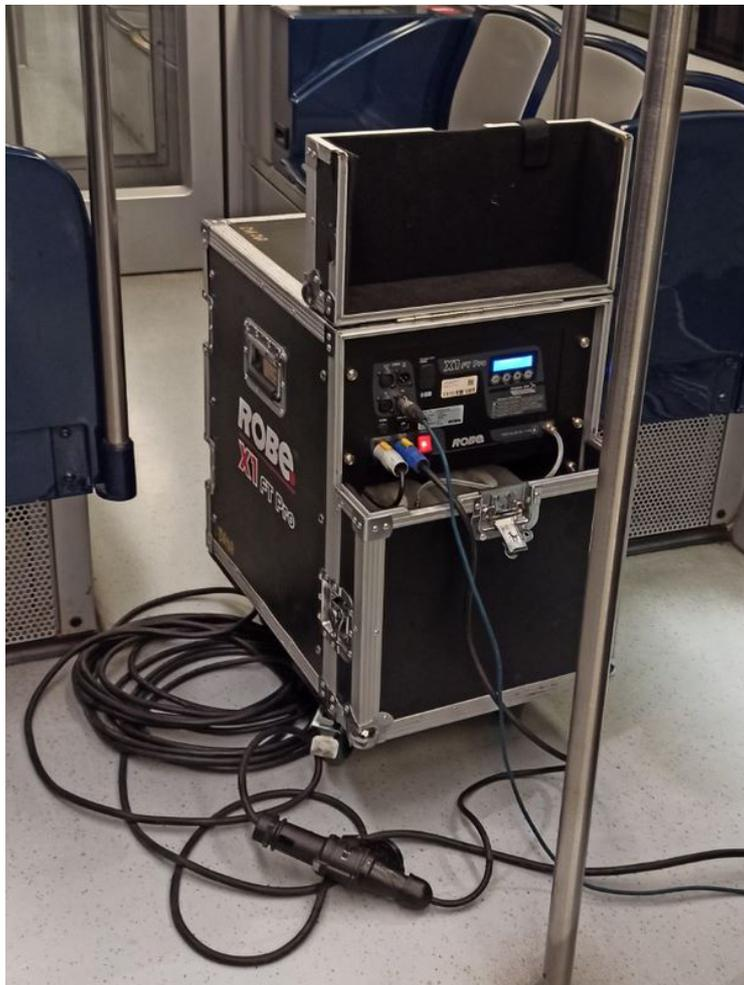
Figura 4.82 – Macchina del fumo utilizzata per le prove
