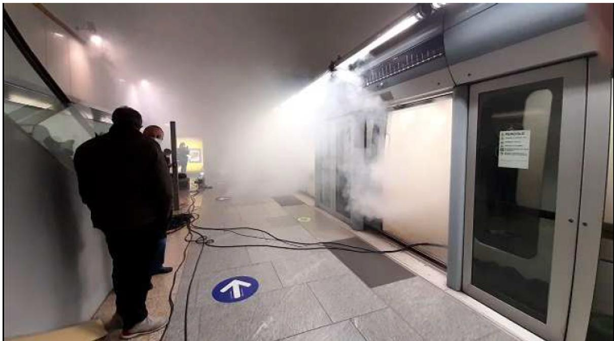
Figura 4.88 – Andamento dei fumi prova 2 senza ventilazione di galleria – tratta dal report di Infra.To
