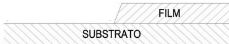
**Figura 3.1:** Schema di un sistema substrato-rivestimento con particolare dello scalino realizzato con la maschera di nastro adesivo [25].
