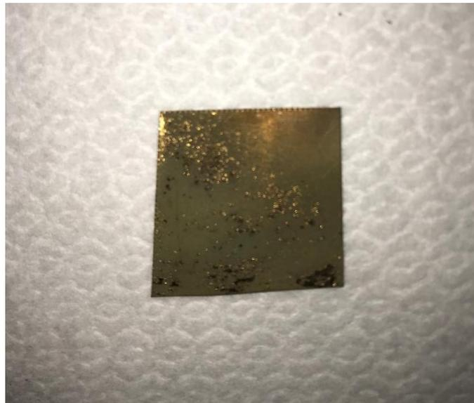
**Figura 4.11:** Tipica difettosità riscontrata nei rivestimenti depositata a temperatura superiore a  $100^\circ\text{C}$ .
