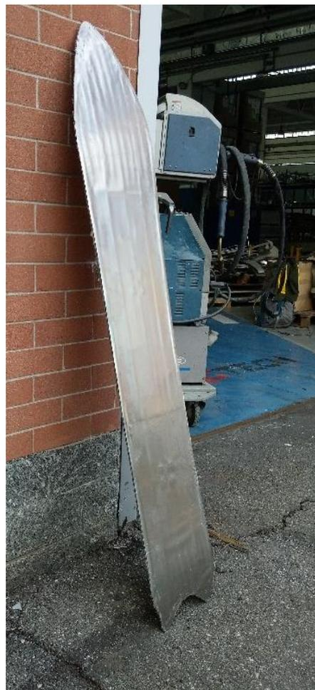
**Figura 1.13:** Prototipo di snowboard con base innovativa in acciaio armonico, realizzato in occasione del tirocinio curriculare presso RGtech™ [46].
