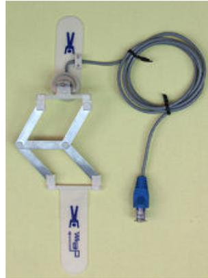
Figura 1.5: Elettrogoniometro del sistema STEP32
