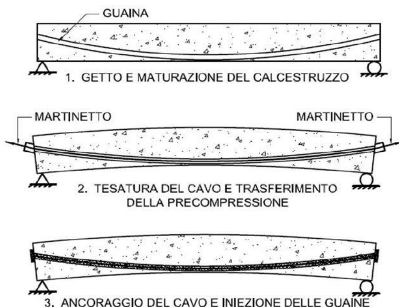
Figura 2.2 Realizzazione di elementi precompressi mediante post-tensione . I cavi, dopo le operazioni di tesatura, sono resi aderenti mediante iniezione. Figura tratta da [8].
