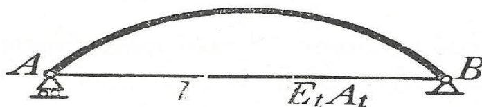
Figura 4.8 Arco a spinta eliminata . Il tirante di lunghezza l , area A_t e modulo elastico E_t ha il compito di assorbire la spinta H alle imposte sgravando così i vincoli esterni da quest'ultima. Figura tratta da [25].
