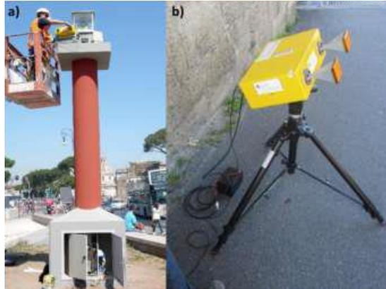
Figura 2 - Strumentazione radar su piattaforma permanente (a) e su treppiede (b)
