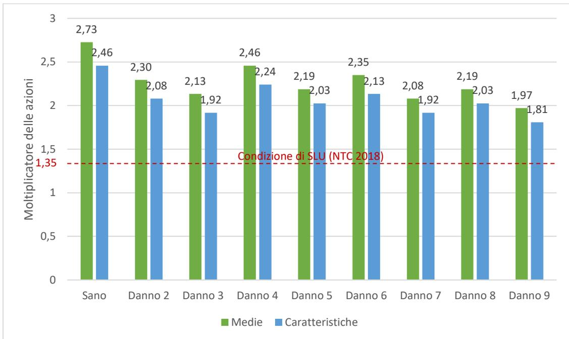
Figura 104 - Confronto delle risposte strutturali – Azione del vento ( $\gamma_w=0,9$ )
