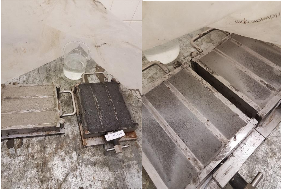
Fig. 2.15: provini prismatici appena riposti in camera di stagionatura (sx), dopo un giorno (dx).
