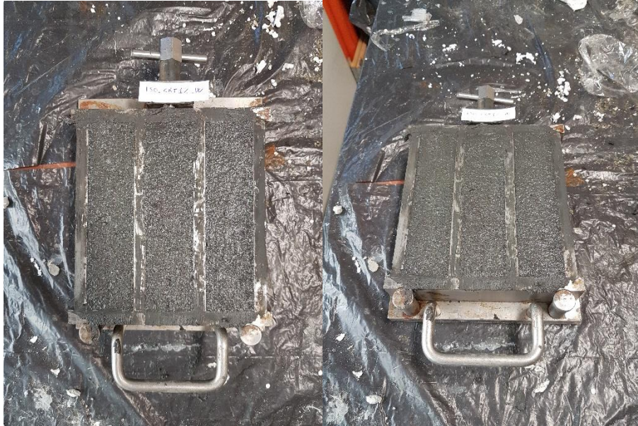
Fig. 2.29: provini prismatici con 5 gr di MWCNT dispersi in acqua.
