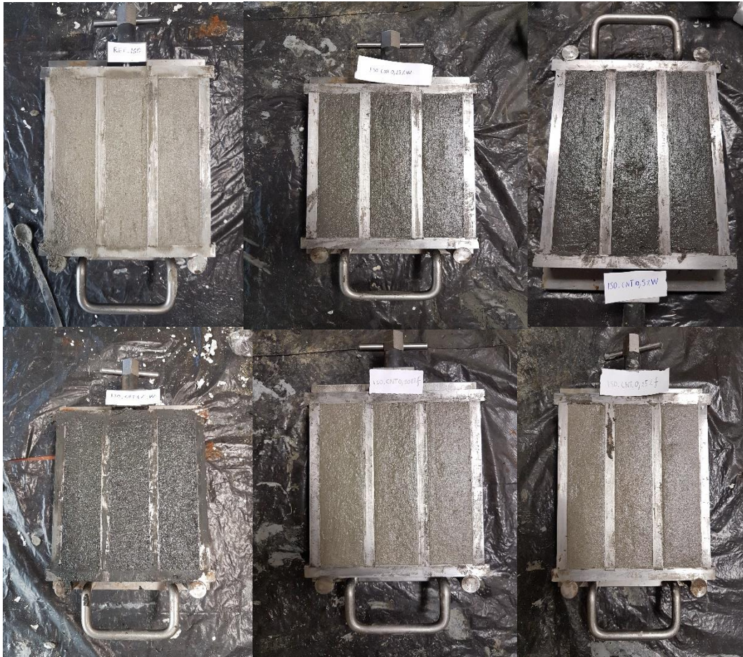
Fig. 2.33: prima fila da sx a dx: REF.ISO - ISO.CNT.0,25%w - ISO.CNT.0,5%w. Seconda fila da sx a dx: ISO.CNT.1%w - ISO.CNT.0,108%f - ISO.CNT.0,25%f.
