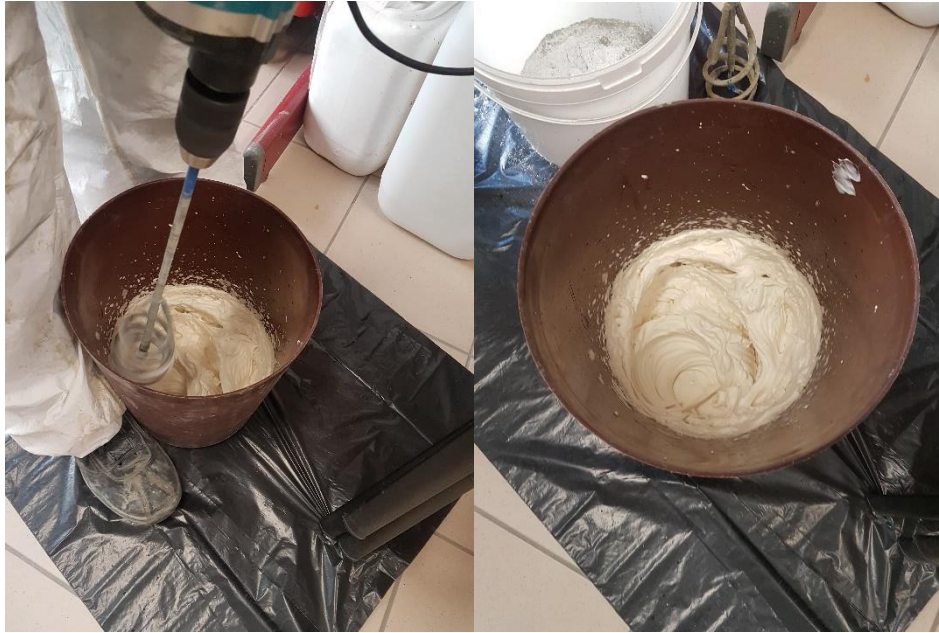
Fig. 2.7: agitazione meccanica con trapano della schiuma (sx) e schiuma omogenea a fine miscelazione (dx).
