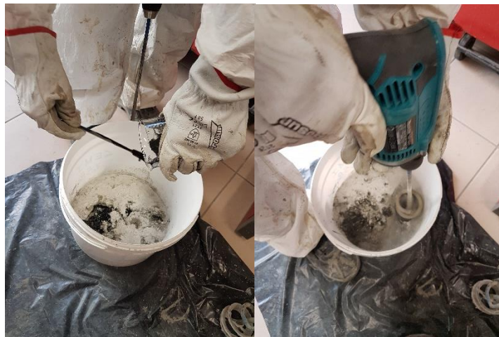
Fig. 2.27: addizione (sx) e miscelazione con trapano (dx) della frazione liquida con quella solida.
