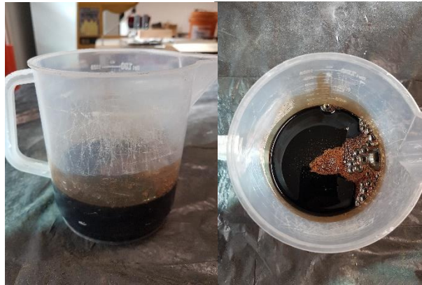
Fig. 2.6: tensioattivo ISOCEM in un baker durante il dosaggio.
