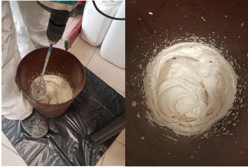
Fig. 2.19: miscelazione con trapano (sx) e miscelazione completa (dx) della schiuma.
