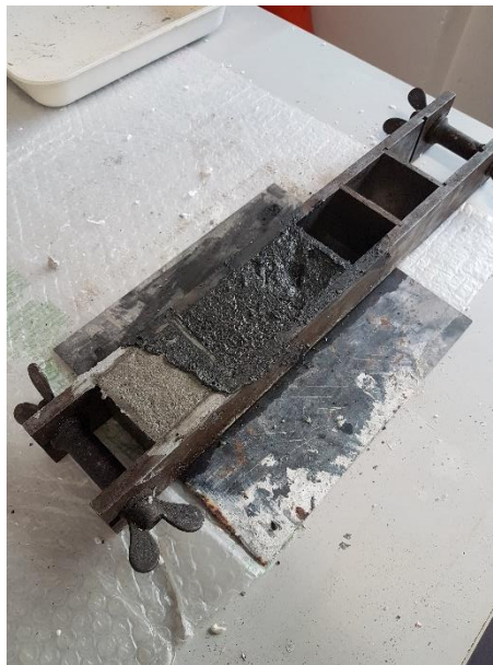
Fig. 2.30: provino cubico con 5 gr di MWCNT dispersi in acqua.
