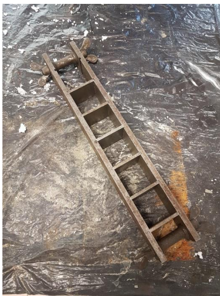
Fig. 2.14: cassero per campioni cubici di dimensioni 5x5x5 cm.
