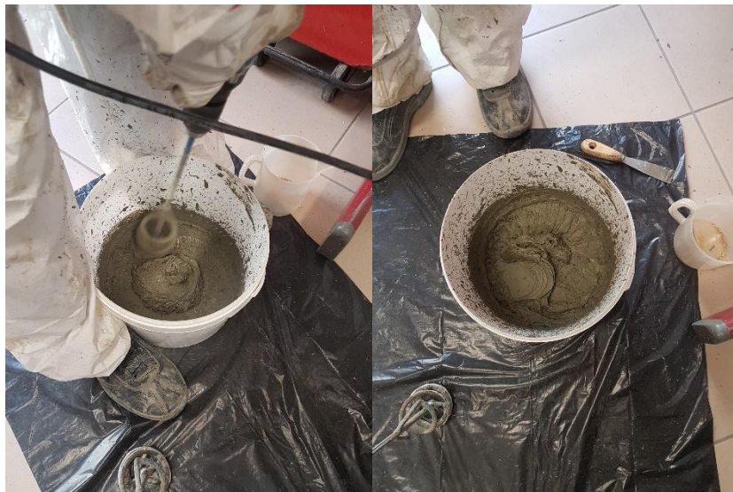
Fig. 2.18: miscelazione con trapano (sx) e miscelazione completa (dx) della frazione solida con quella liquida.
