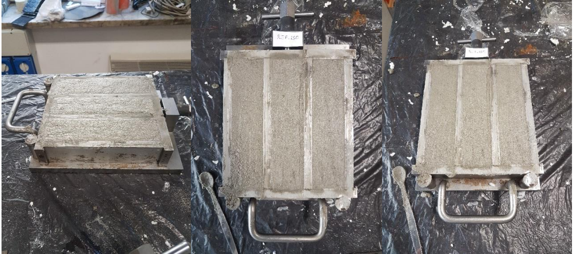
Fig. 2.22: provini bianchi prismatici da più angolazioni.
