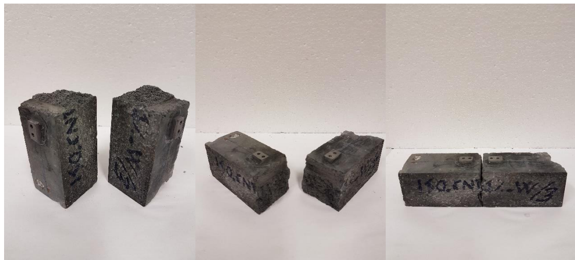
Fig. 3.15: provino ISO.CNT.1%W/3 al termine della prova di flessione su tre punti.
