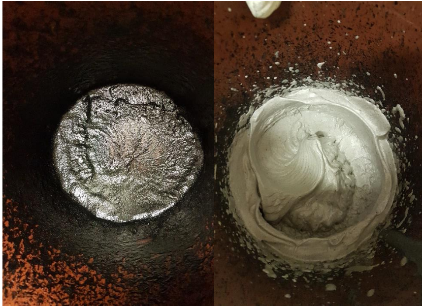
Fig. 2.32: confronto tra schiuma instabile (sx) e stabile (dx) a causa della presenza di MWCNT in diversa concentrazione.
