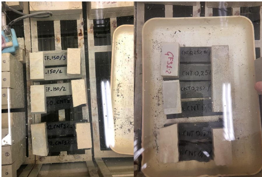
Fig. 2.16: provini prismatici immersi in acqua il terzo giorno della maturazione.
