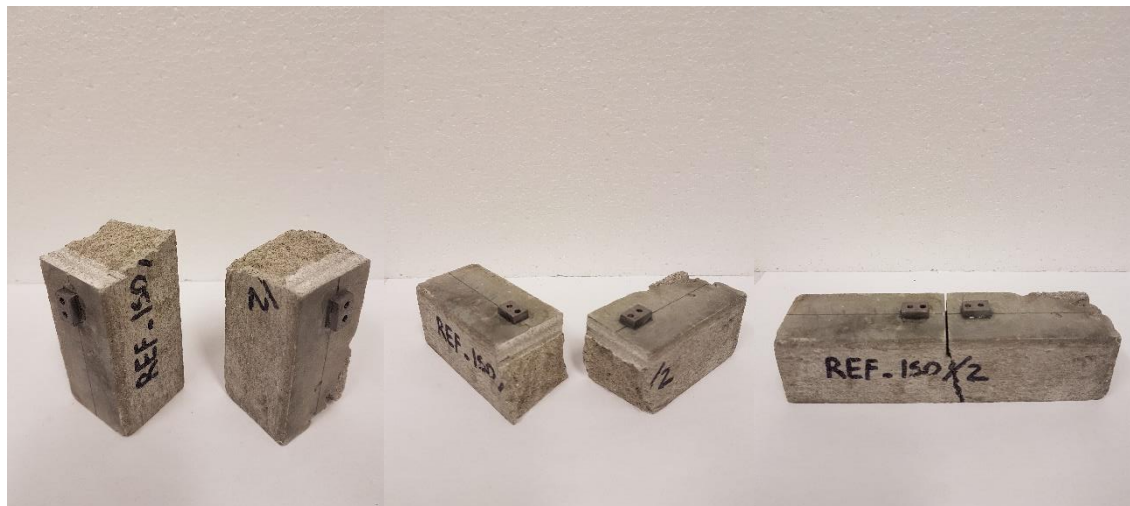
Fig. 3.5: provino REF.ISO/2 al termine della prova di flessione su tre punti.
