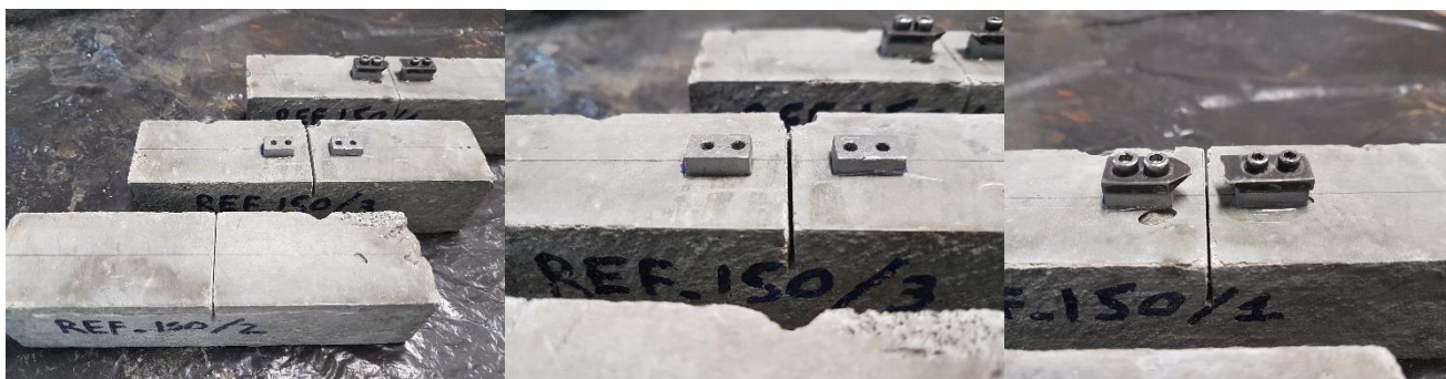
Fig. 3.3: dettagli di incisione, basi e lame (sx), basi (centro) e lame (dx).
