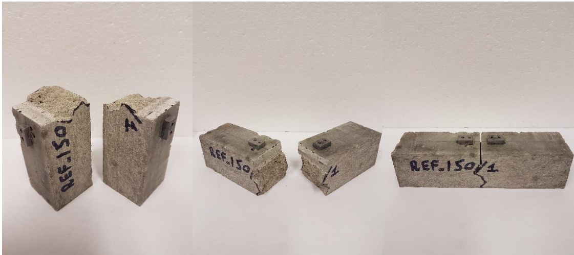
Fig. 3.4: provino REF.ISO/1 al termine della prova di flessione su tre punti.
