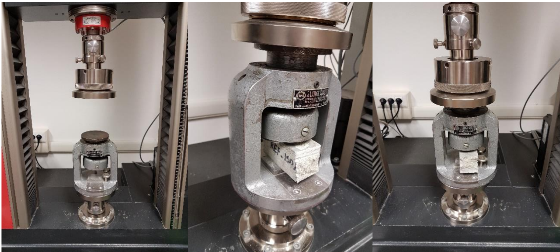
Fig. 3.16: macchinario e configurazione della prova di compressione.
