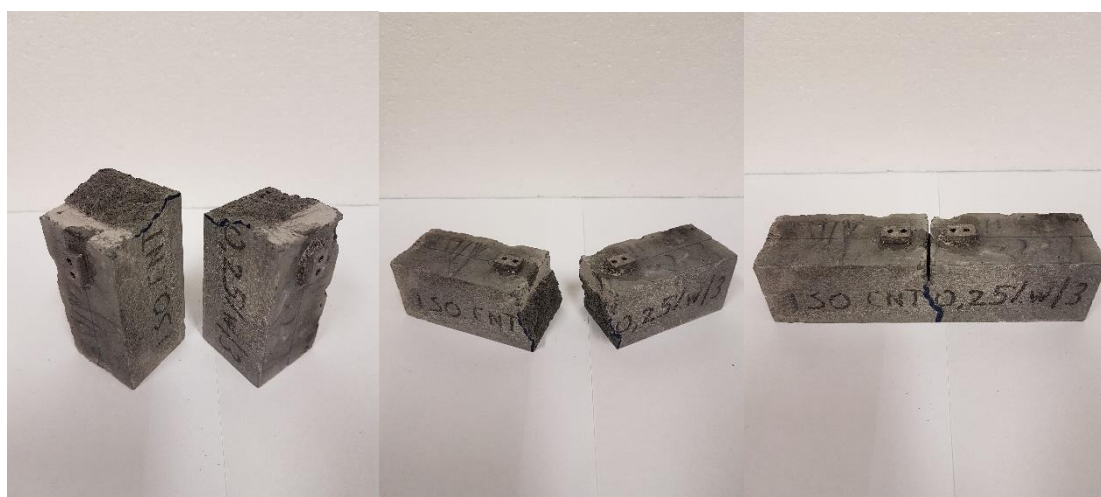
Fig. 3.9: provino ISO.CNT.0,25%W/3 al termine della prova di flessione su tre punti.
