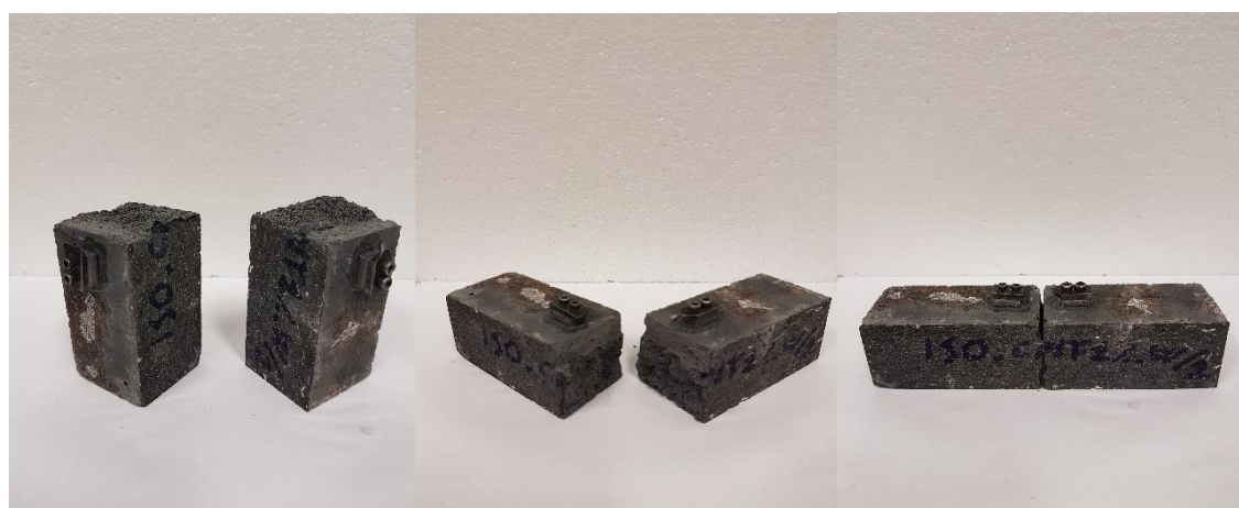
Fig. 3.13: provino ISO.CNT.1%W/1 al termine della prova di flessione su tre punti.
