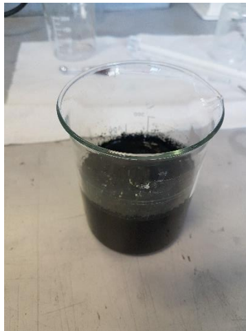
Fig. 2.24: miscela di acqua, superfluidificante, tensioattivo e MWCNT.
