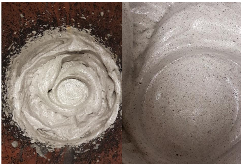
Fig. 2.31: schiuma con 0,5% in peso di MWCNT dispersi al suo interno (sx), dettaglio (dx).
