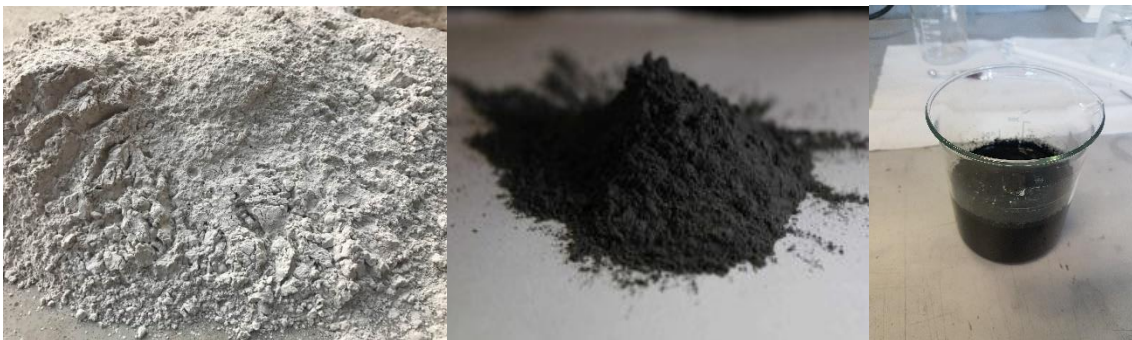
Fig. 2.3: additivi rinforzanti, fly ash (sx), fumi di silice (centro) e carbonanotubi a parete multipla (dx).
