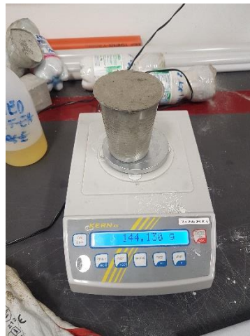
Fig. 2.21: campione di LWFC per la stima della densità fresca.
