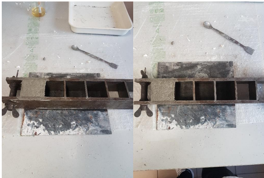
Fig. 2.23: provino bianco cubico da più angolazioni.
