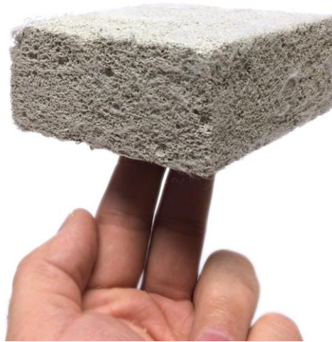
Fig. 2.1: campione prismatico di Lightweight Foamed Concrete, estremamente poroso e leggero.
