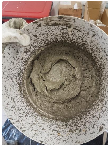
Fig. 2.20: miscelazione completa della pasta cementizia con la schiuma.
