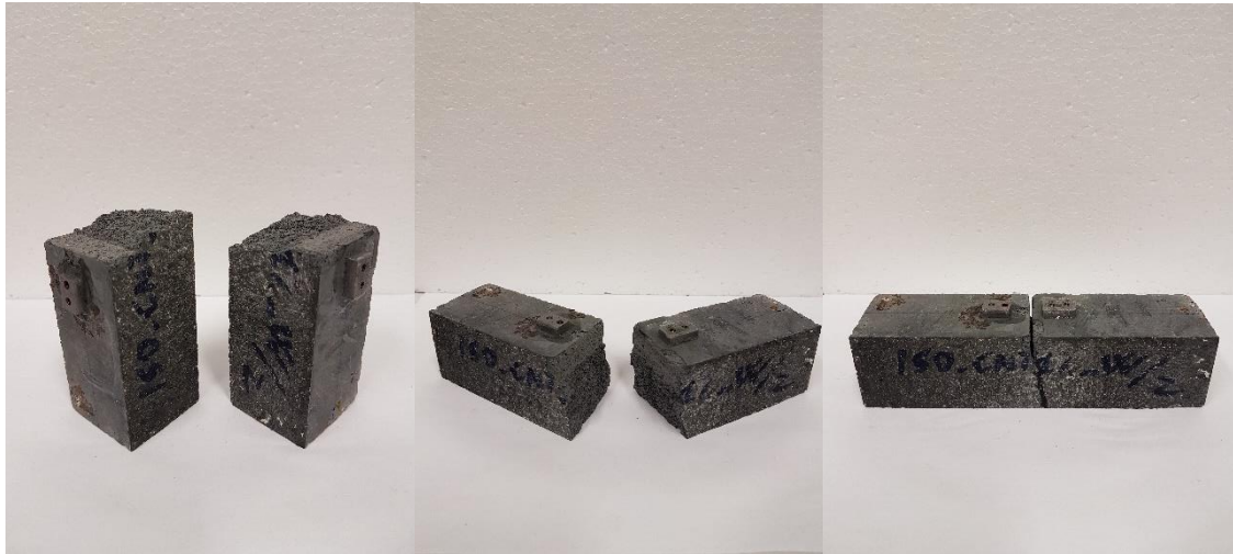
Fig. 3.14: provino ISO.CNT.1%W/2 al termine della prova di flessione su tre punti.
