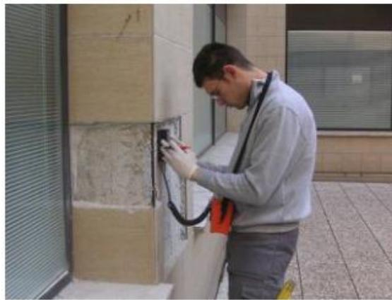
*Figura 42 - Svolgimento della prova SONREB [Valutazione della vulnerabilità sismica, Ing. Centioni, 2010].*
