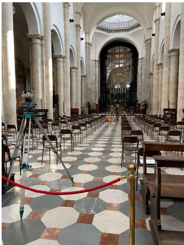
*Figura 5.27 - Rilievo dei piombi dei pilastri con la stazione totale*
