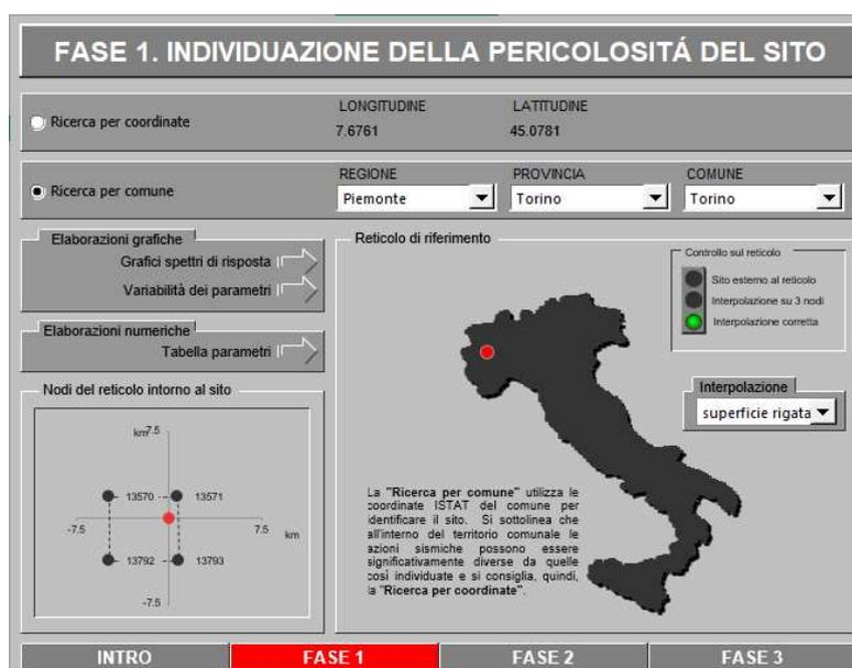
Figura 6.13 - Individuazione della pericolosità sismica del sito (Foglio di calcolo degli spettri di risposta - Fase 1)
