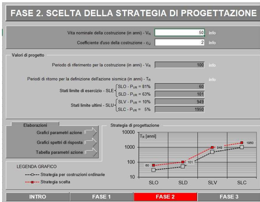
Figura 6.16 - Scelta della strategia di progettazione (Foglio di calcolo degli spettri di risposta - Fase 2)
