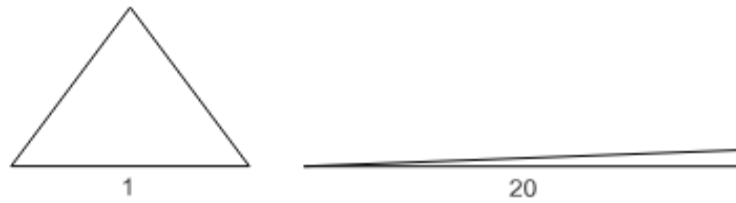
Figura 3.12 – Valori di Aspect ratio per due diversi triangoli
