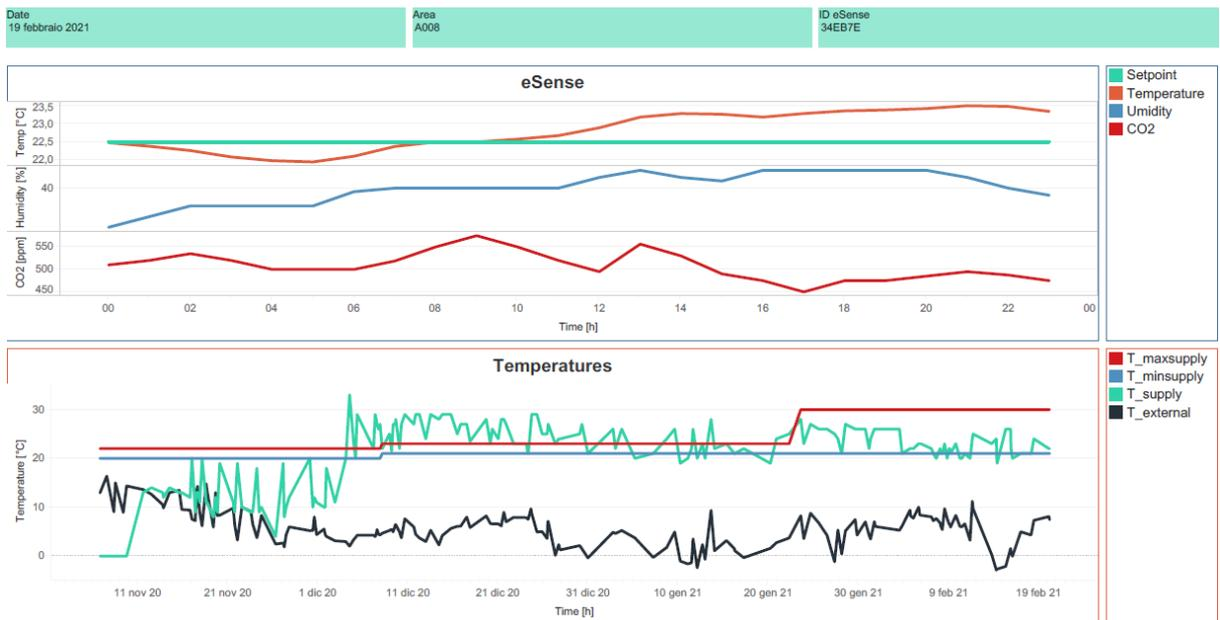
Figura 60: Videata della dashboard Tableau dell'area A008- UTA Diagnostica OVEST realizzata per il monitoraggio dell'Ospedale.
