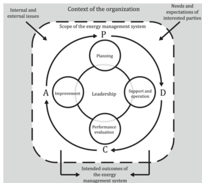
Figura 6 – Applicazione del Ciclo di Deming alla norma ISO 50001. Fonte: ISO
