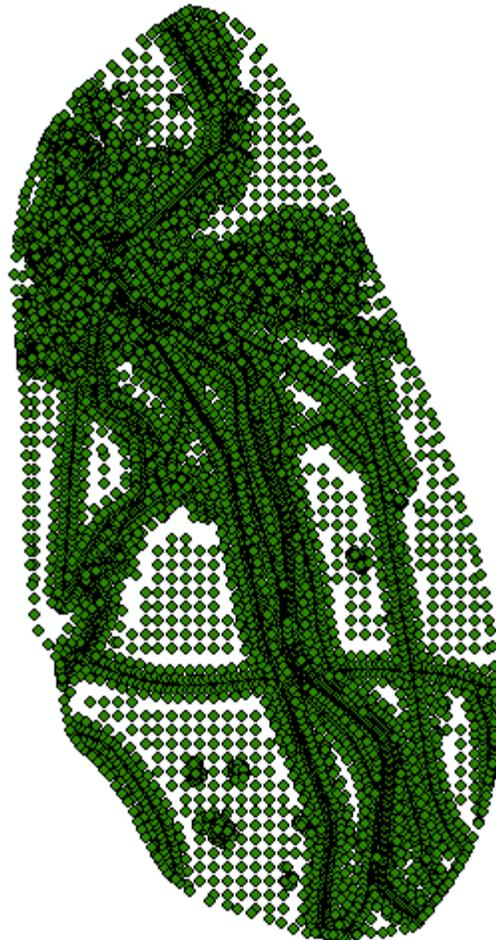
Figura 6.59: Rappresentazione dei punti corrispondenti ai centri delle celle della mesh
