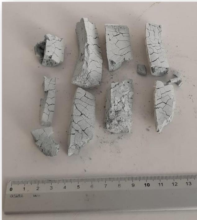
Figura 66: tipica colorazione e sgretolatura del Solidur dopo un mese di essiccazione
