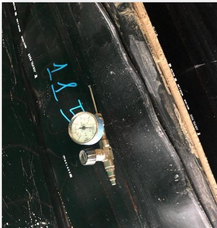
*Figura 51: manometro con ago metallico per l'insufflaggio dell'aria e la misurazione della pressione*
