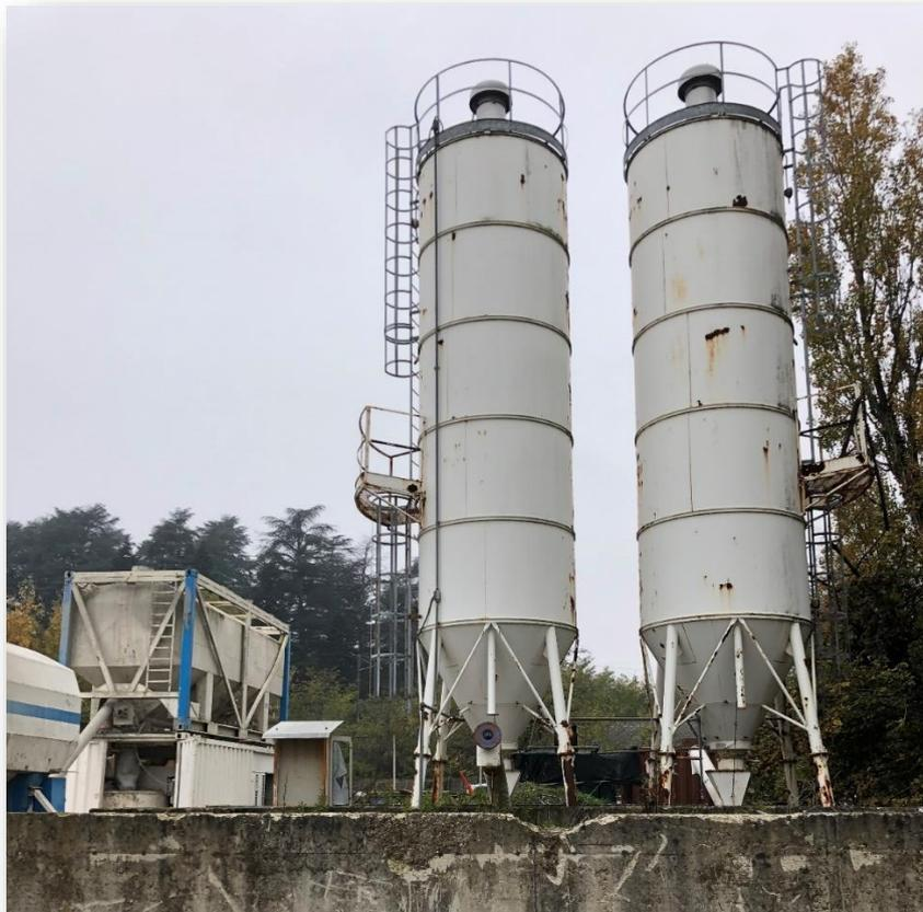
*Figura 11: silos di stoccaggio e impianto per la preparazione della miscela cementizia*
