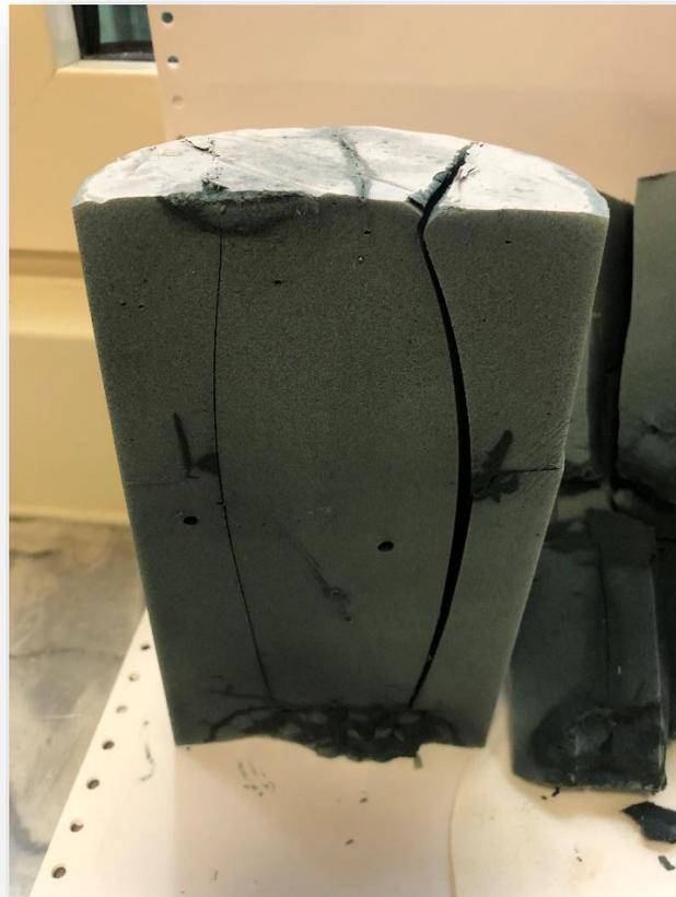
*Figura 67: campione 3 dopo il test di compressione monoassiale*
