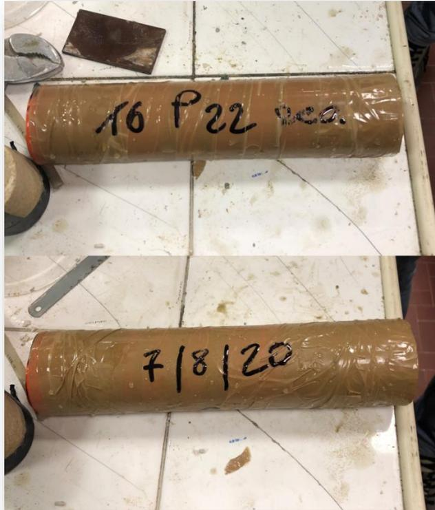
Figura 65: Solidur in fustella, riportante il numero del provino e la data di confezionamento
