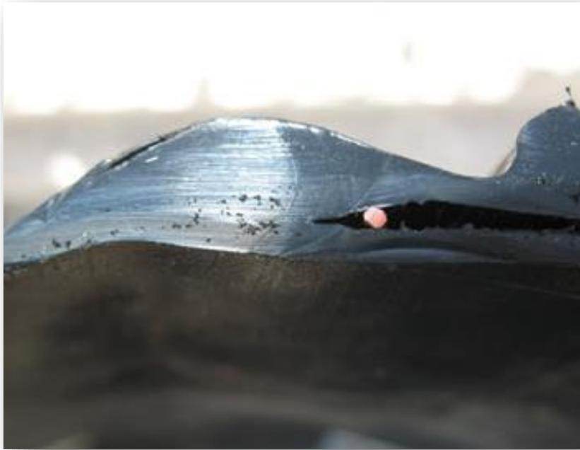
*Figura 56: dettaglio del filo di rame all'interno della saldatura (Kelsey, 2006)*
