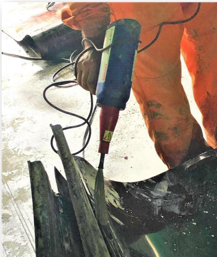
*Figura 57: esecuzione dello Spark test attraverso la spazzola in ottone*
