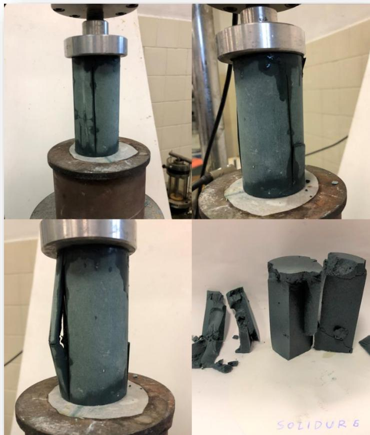
*Figura 62: sequenza di carico e rottura del provino 6*
