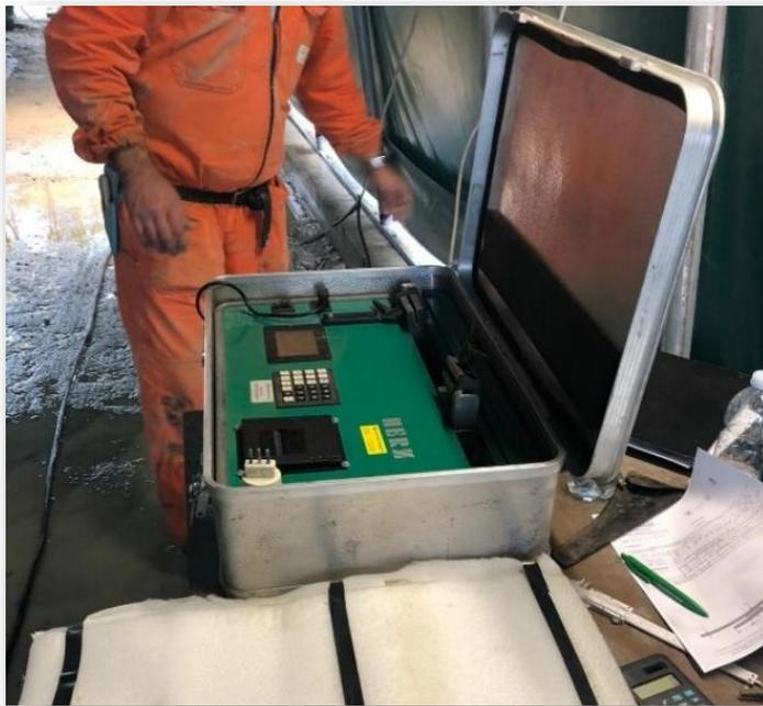
*Figura 53: dinamometro elettronico per il test di resistenza a pelatura*
