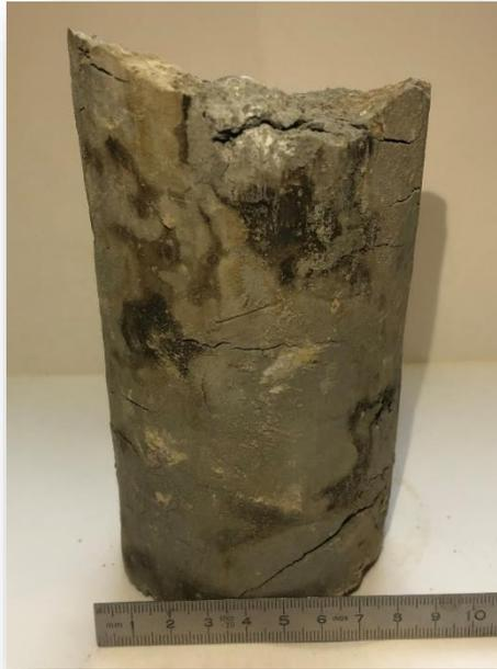
*Figura 1: campione di terreno con macchie di oli e combustibili*
