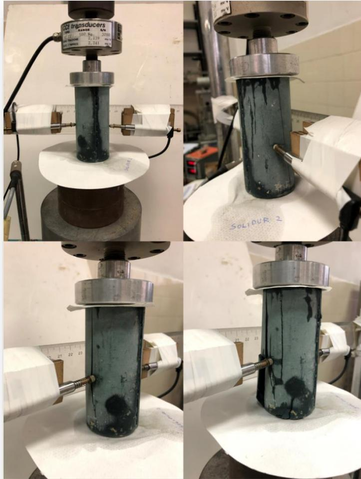
*Figura 64: sequenza di carico e rottura del provino 2*
