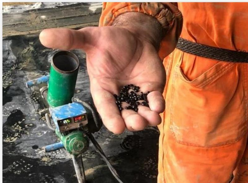
Figura 50: HDPE granulare
