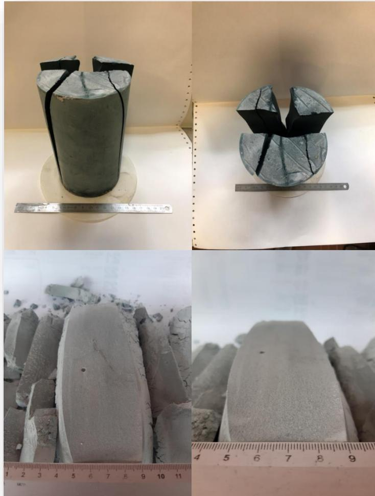
*Figura 70: campione di Solidur 3 subito dopo rottura e dopo un mese di essiccazione*
