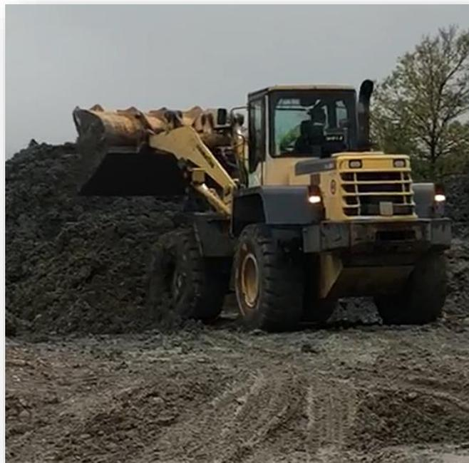
*Figura 60: pala gommata usata per caricare il terreno sul dumper e per sistemare i cumuli nelle aree di stoccaggio*
