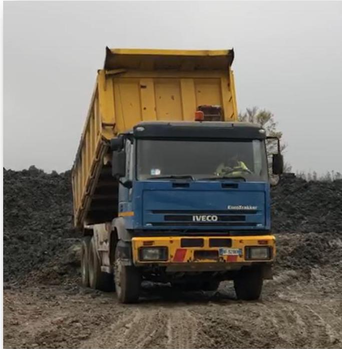
*Figura 59: dumper IVECO Euro Trakker utilizzato per il trasporto del terreno all'interno del cantiere*
