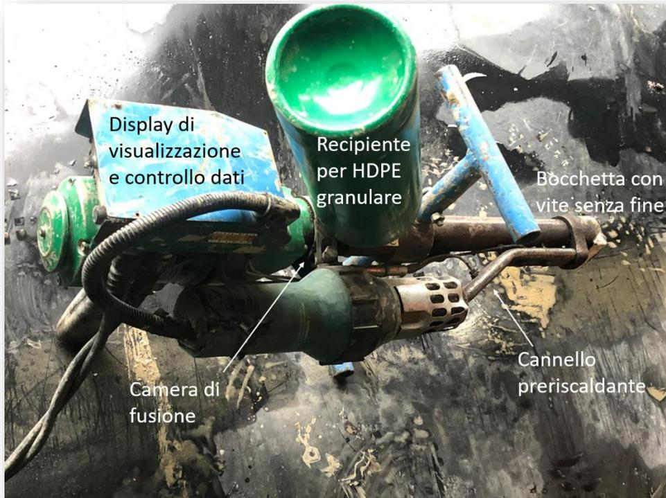
Figura 49: estrusore manuale per la correzione e la finitura di alcune parti della geomembrana
