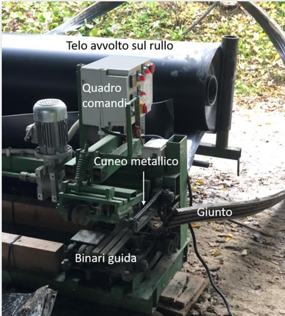
*Figura 43: alcuni degli elementi fondamentali in fase di saldatura*
