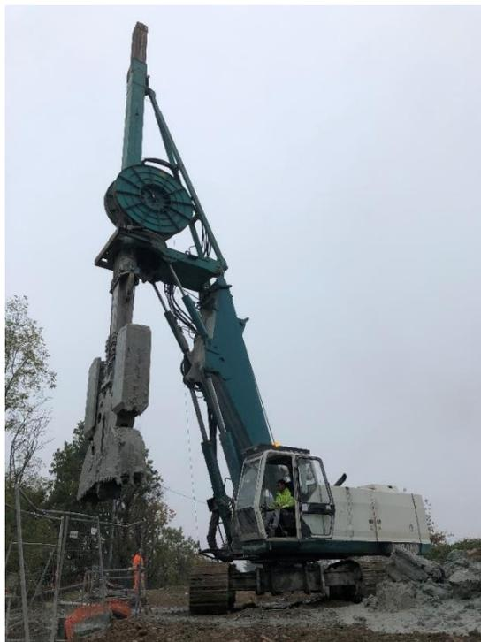
*Figura 6.19 - Benna mordente montata su sistema Kelly con guida telescopica utilizzata in cantiere.*
