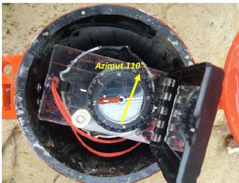
Figura 7.7 - Tubo inclinometrico I4 visto dall'alto con indicazione dell'azimut.
