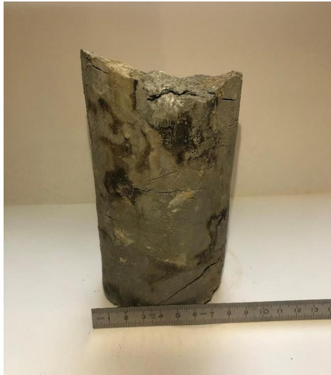
*Figura 2.2 - Spezzone di carota prelevato da un sondaggio eseguito precedentemente alla realizzazione del Lotto 2, nella quale si possono notare le macchie di inquinante.*
