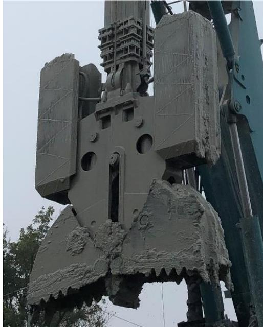
*Figura 6.22 - Dettaglio della benna mordente utilizzata nel cantiere.*
