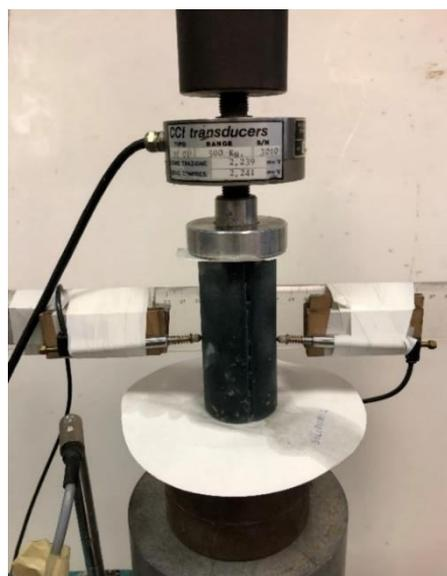
*Figura 8.9 - Prova di compressione uniassiale sul provino "Solidur 2" dotata di palpatori per la misurazione della deformazione laterale.*
