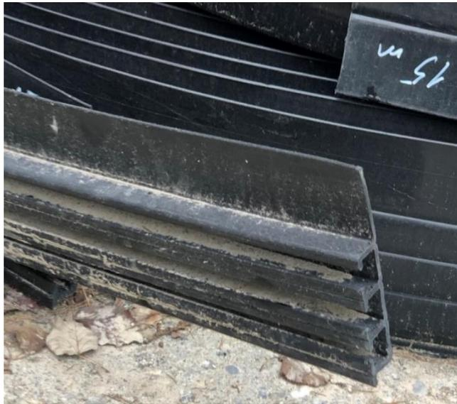
*Figura 6.9 - Particolare del giunto in HDPE prima della sua saldatura sul telo.*
