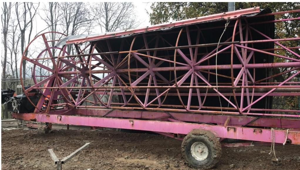
*Figura 6.35 - Telo in HDPE quasi completamente srotolato dalla bobina di supporto.*
