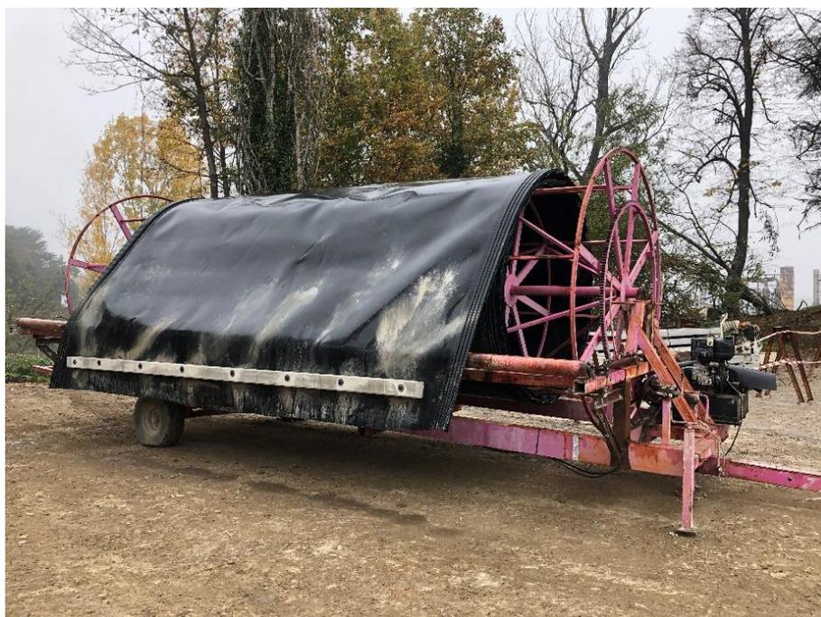
*Figura 6.31 - Telo in HDPE montato sulla bobina di supporto e dotato sia delle zavorre in calcestruzzo che dei profili giuntati.*
