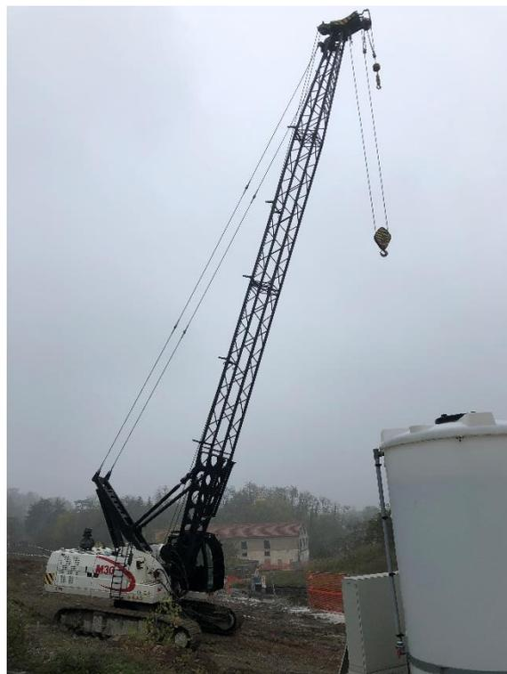
*Figura 6.33 - Gru impiegata per il calaggio ed il sollevamento della zavorra in ferro.*
