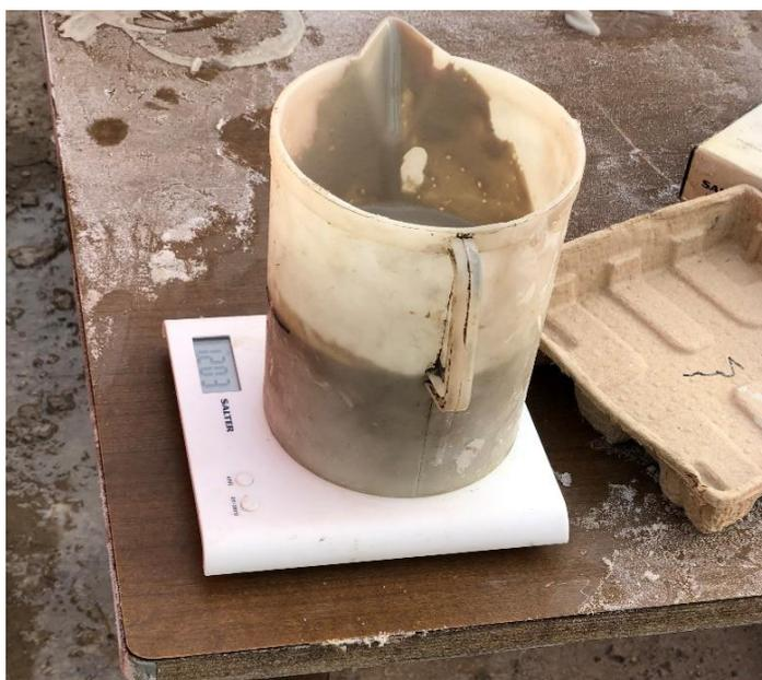
Figura 6.16 - Prova del peso specifico con l'utilizzo di un contenitore ed una bilancia elettronica.
