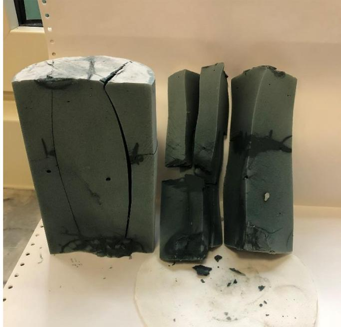
*Figura 8.11 - Rottura per spalling evidenziata a seguito dell'esecuzione della prova di compressione del provino "Solidur 3".*
