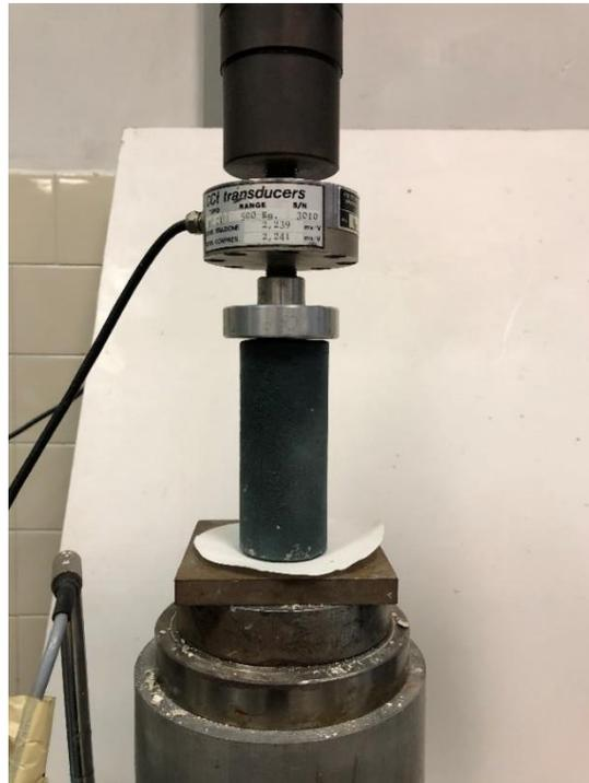
*Figura 8.5 - Campione "Solidur 1" disposto per la prova di resistenza alla compressione monoassiale.*
