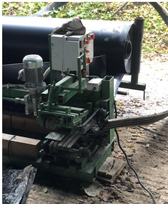
*Figura 6.10 - Macchinario utilizzato per la saldatura a doppia pista.*
