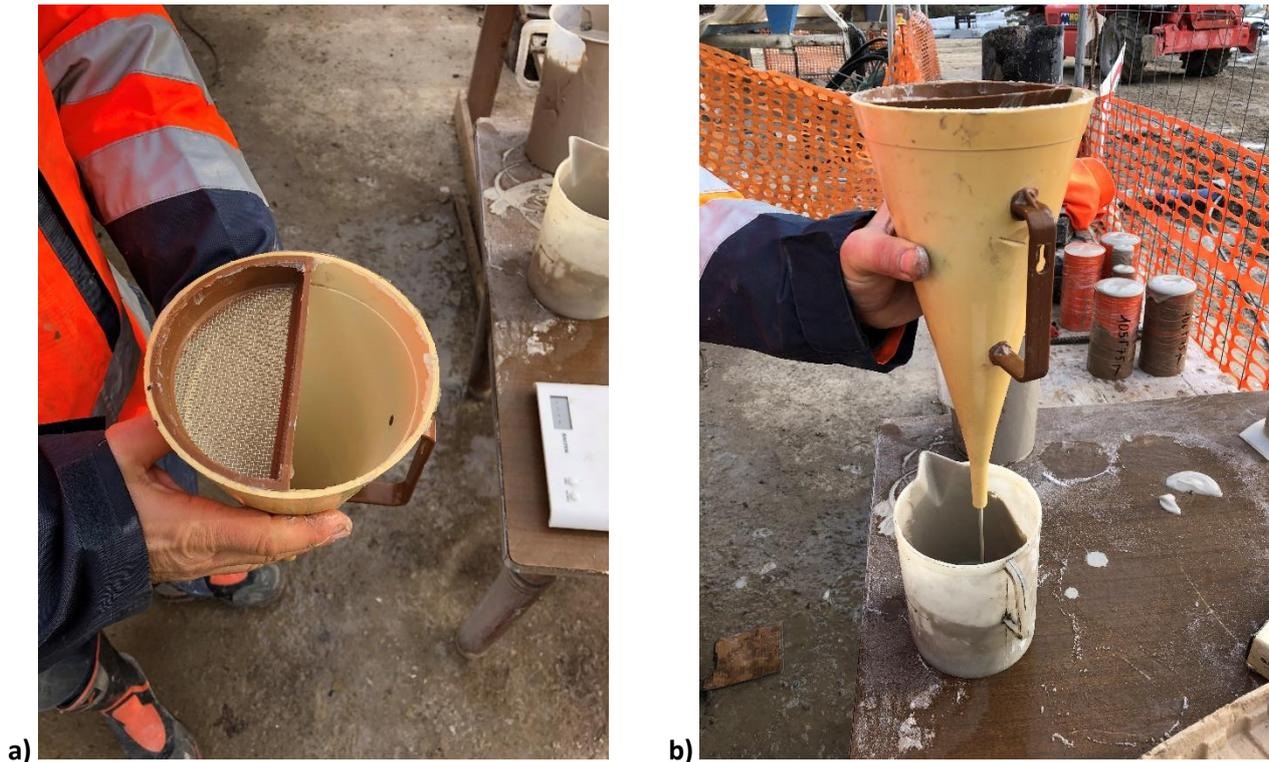
Figura 6.18 - a) Cono di Marsh visto internamente. b) Esecuzione della prova di viscosità.
