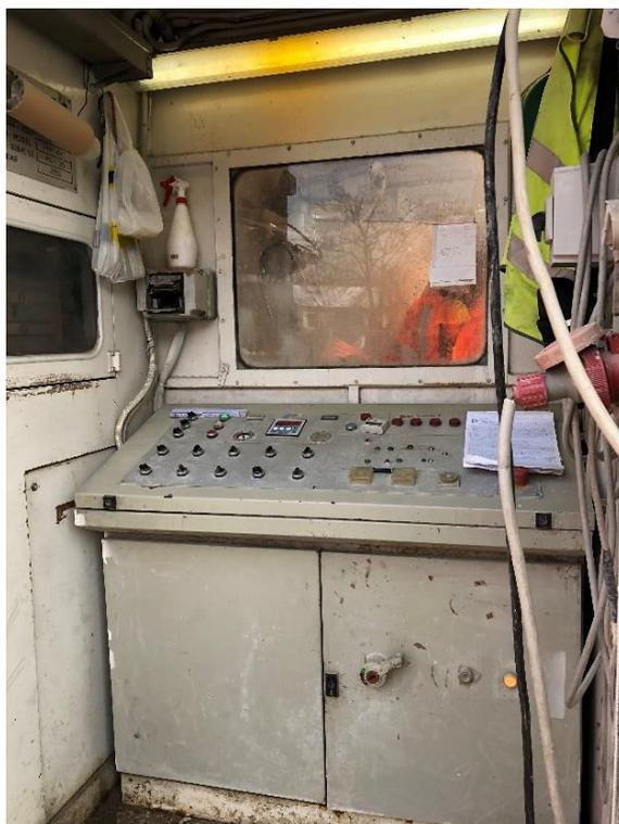
*Figura 6.11 - Cabina di controllo per l'immissione di acqua e Solidur® all'interno del mixer.*
