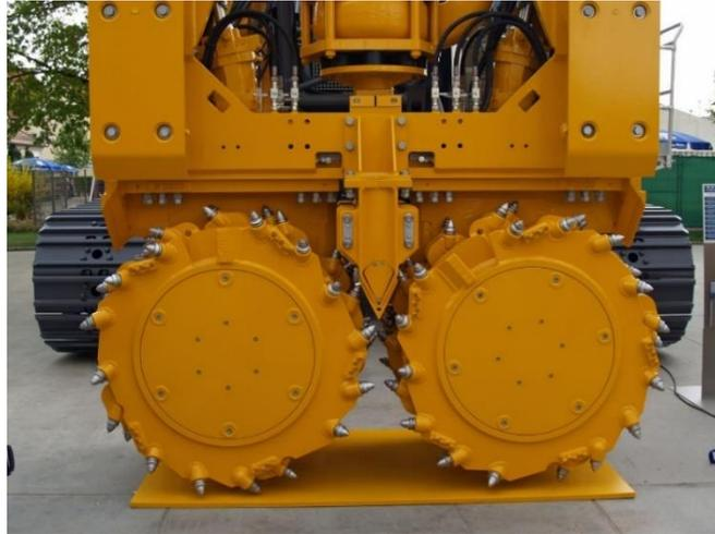
*Figura 4.10 - Particolare della testa fresante dell'idrofresa. [57]*
