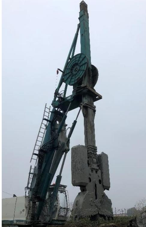
*Figura 6.21 - Rappresentazione del Kelly KRC2 HD e della benna idraulica K.*
