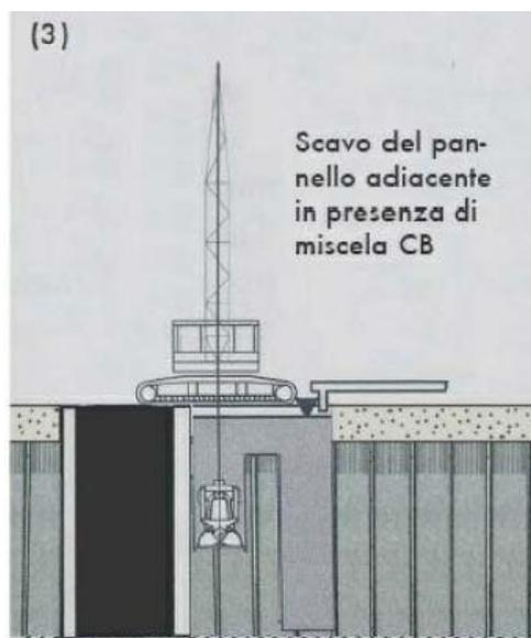
Figura 6.27 - Rappresentazione schematica della fase 3: scavo dei pannelli adiacenti. [1]
