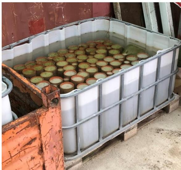
*Figura 8.1 - Vasca ripiena d'acqua e destinata al confezionamento dei provini di resistenza e permeabilità.*
