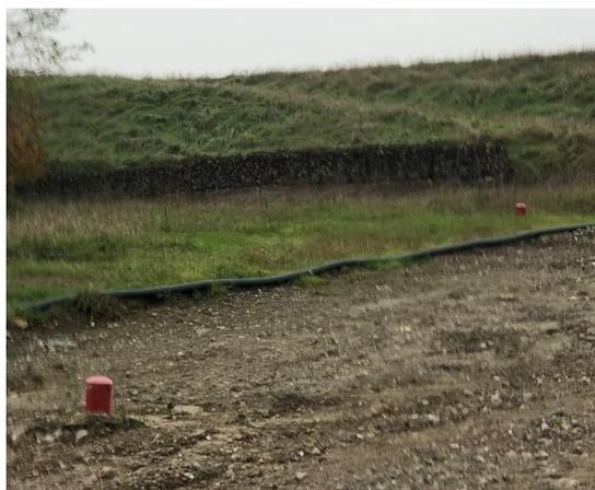
Figura 7.14 - Piezometri presenti all'interno del cantiere oggetto di studio.
