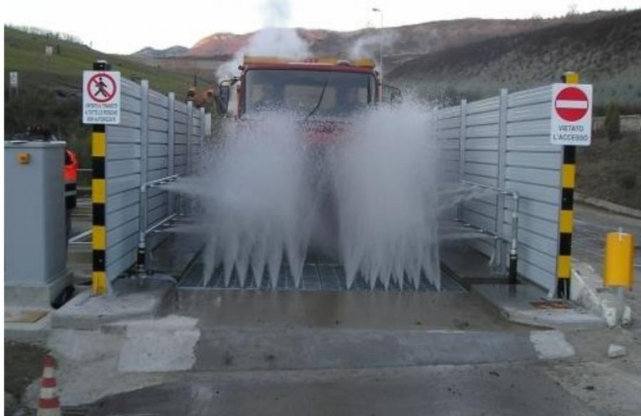
Figura 3.1 - Esempio di impianto di lavaggio ruote per mezzi di cantiere. [s<sub>4</sub>]
