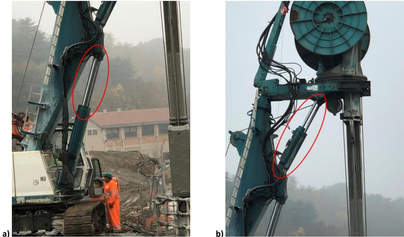
*Figura 6.24 - Pistoni per la messa a piombo della macchina evidenziati in rosso.*
