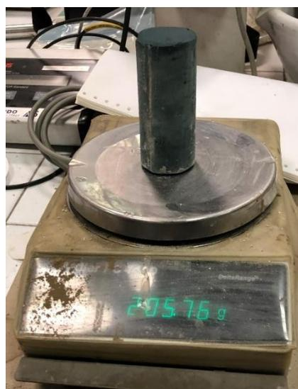
*Figura 8.4 - Misura del peso netto umido del provino "Solidur 1" mediante bilancia.*
