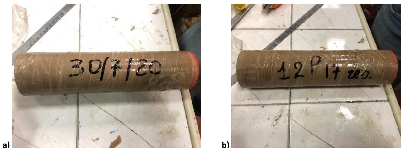
Figura 8.2 - Fustella contenente il provino "Solidur 4" con indicate: a) data del prelievo; b) numerazione e tipo di prova a cui sarà sottoposto (prova di resistenza).
