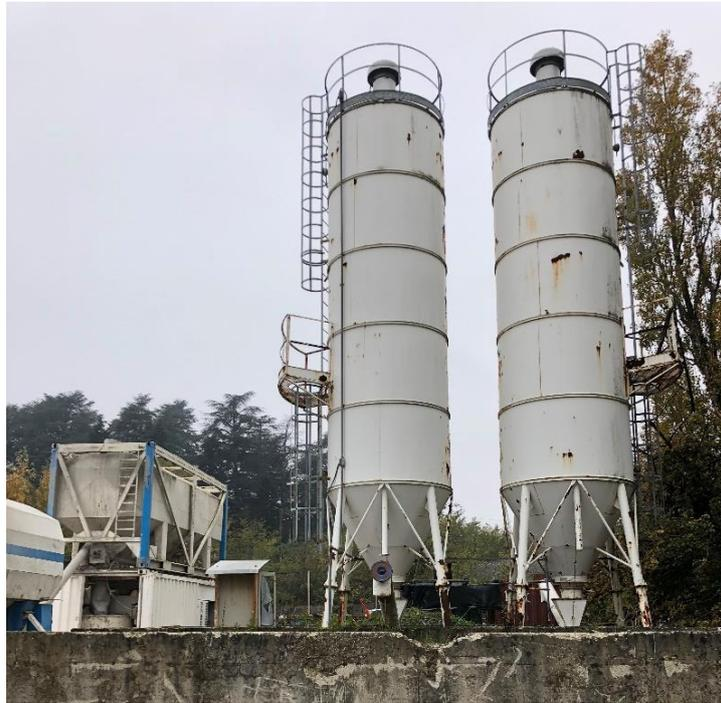
*Figura 3.6 - Rappresentazione dell'impianto di miscelazione (a sinistra) e dei due silos impiegati per lo stoccaggio della miscela (a destra) presenti nel cantiere.*
