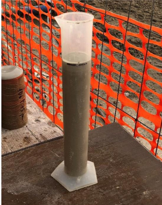
*Figura 6.17 - Cilindro graduato impiegato per la prova di decantazione.*
