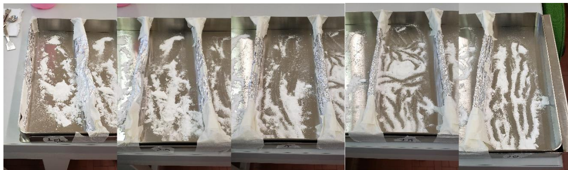
Figura 11. Immagine del vassoio contenente la polvere essiccata della soluzione di saccarosio al 40% ottenuta usando una diversa portata di alimentazione all'atomizzatore ultrasuoni.
