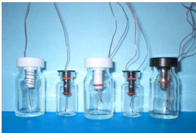
Figura 11 Esempi di termocoppie entro i flaconi (immagine tratta da SP Scientific , 2020 e riprodotta con modifiche).
