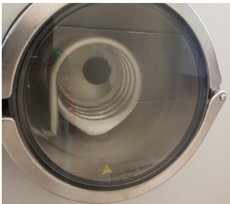
Figura 18 Condensatore del Micro-FD dopo un ciclo completo di liofilizzazione
