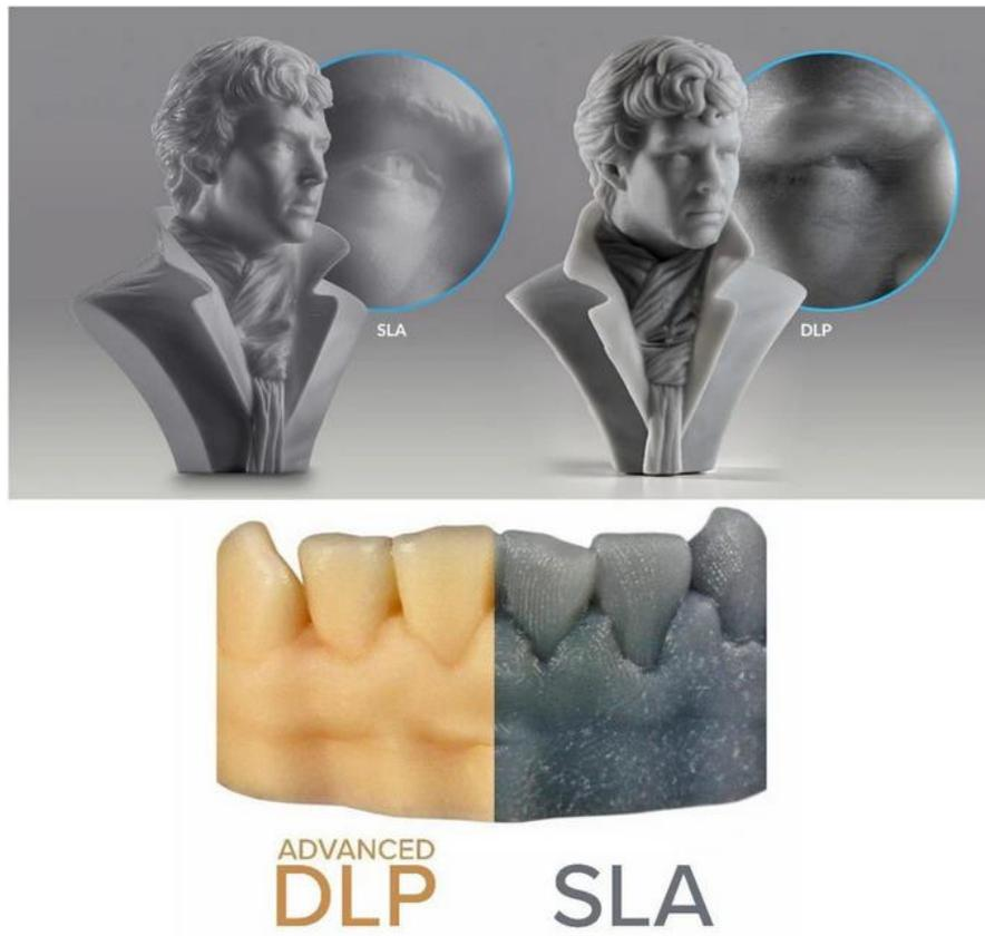
Figura 30: Confronto tra le due tecniche in termini di estetica e precisione [25]
