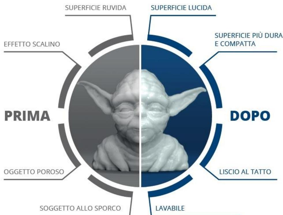
Figura 23: Esempio di oggetto prima e dopo la finitura superficiale. Sono elencati i difetti che si cerca di eliminare e gli achievement che si cerca di ottenere con la finitura superficiale [20]
