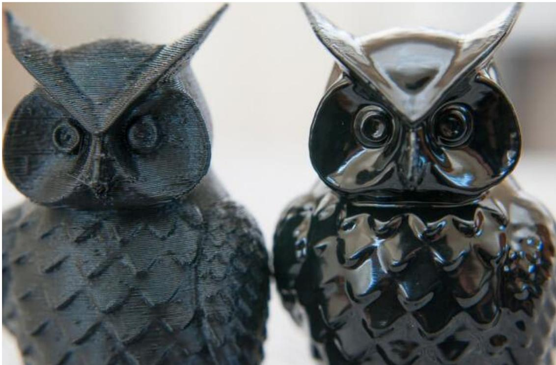
*Figura 26: Esempio di un oggetto di ABS stampato in FDM e successivamente trattato con fumi di acetone [20]*
