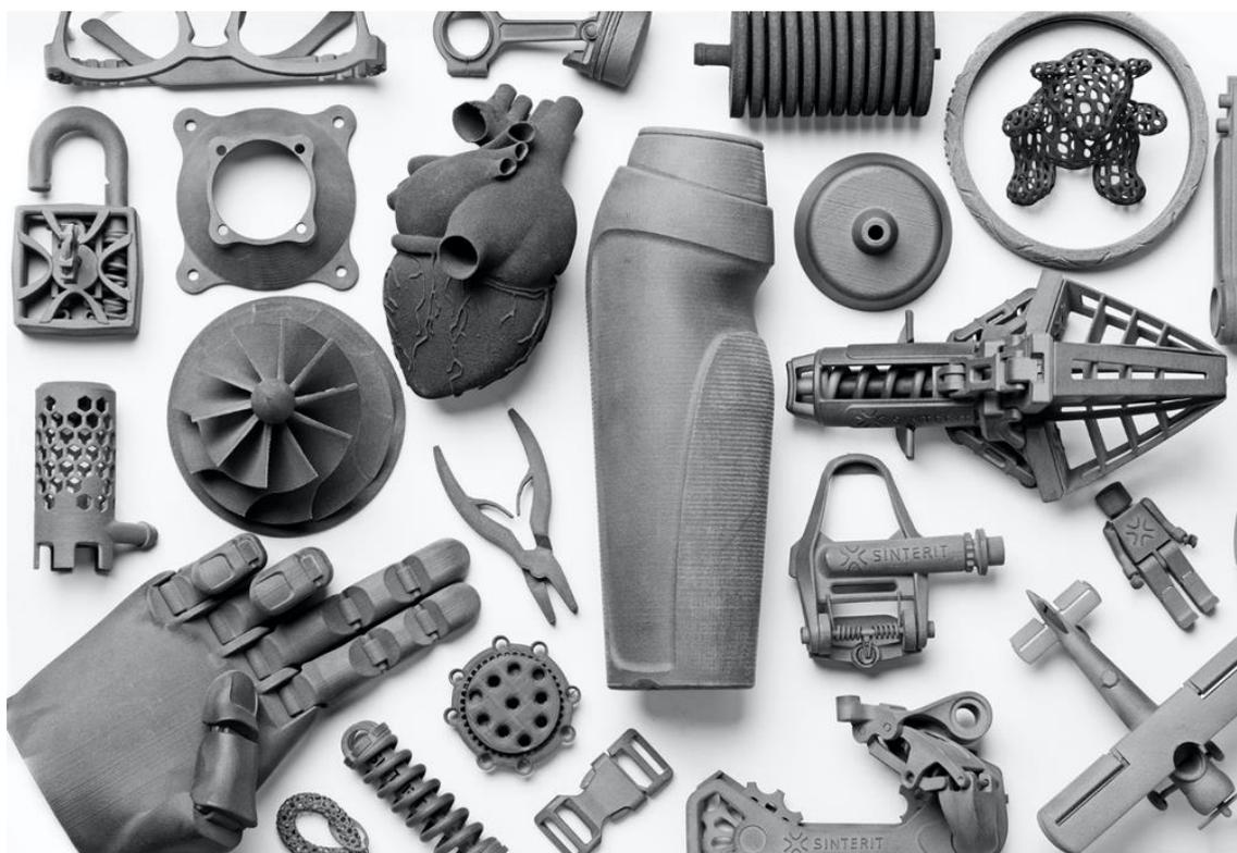
Figura 47: Esempio di parti stampate con tecnologia SLS, alcune di esse costituite da parti mobili già assemblate [35]
