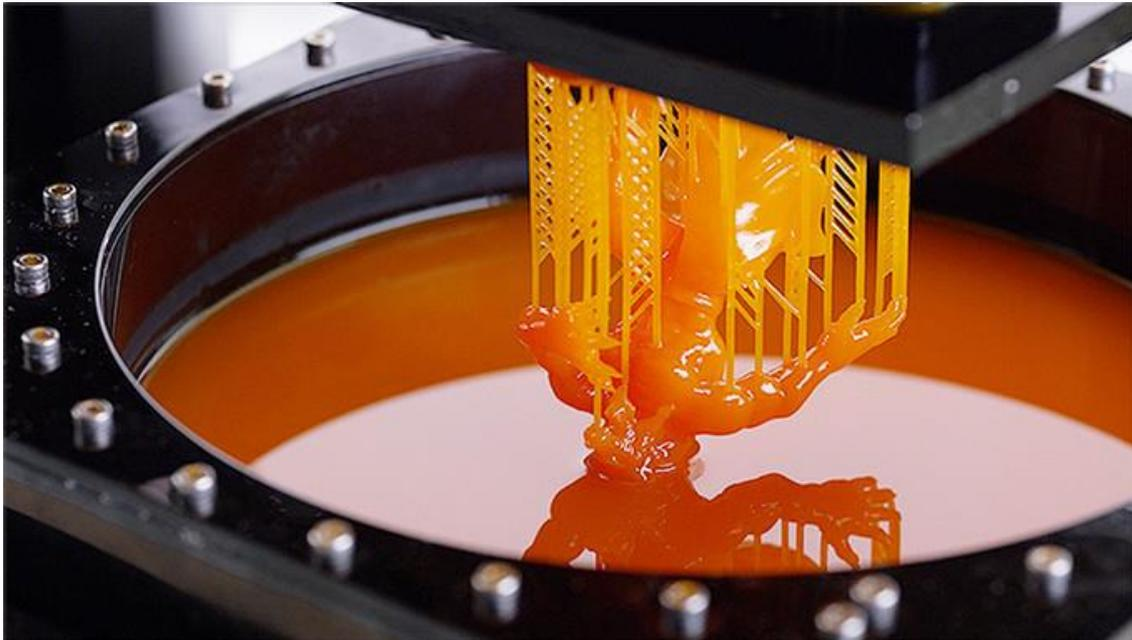
*Figura 27: Esempio di AM per fotopolimerizzazione, nella variante DLP [24]*
