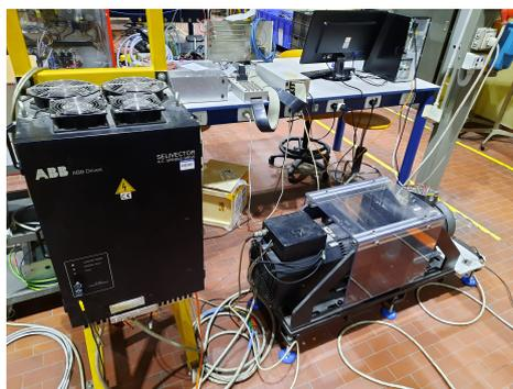
(b) *Load Inverter - Motor load - ABB motor - PC*
