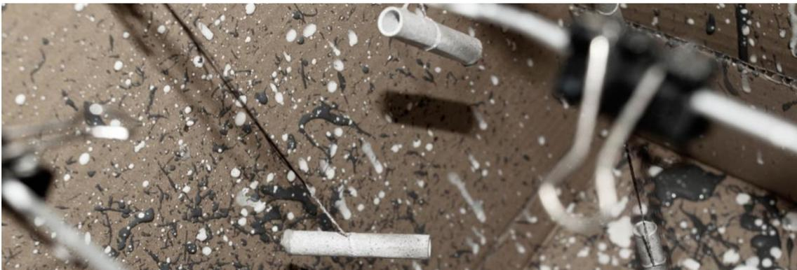
Figura 16: Capsule cementizie in fase asciugatura dopo il primo coating.
