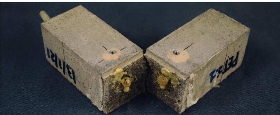
Figura 37: Fuoriuscita e la seguente reazione della resina poliuretanicca dopo la frattura del provino.
