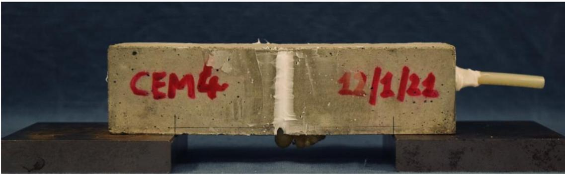
Figura 31: Risultato provino dopo la sigillatura dei bordi di frattura.
