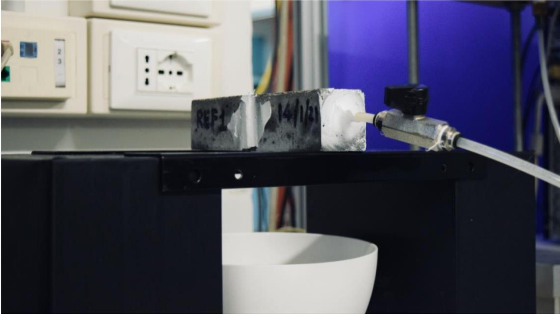
*Figura 33: Provino posizionato sul telaio in acciaio.*
