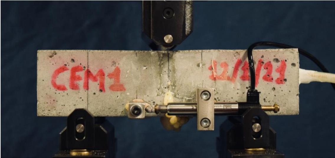
Figura 35: Trasduttore di spostamento posizionato sul provino.
