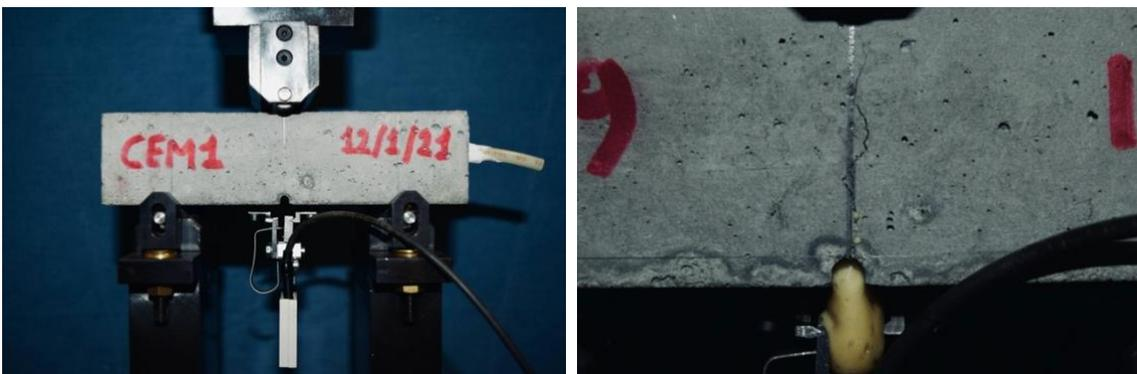
Figura 30: (a sinistra) provino sottoposto a carico flessionale su tre punti; (a destra) Fuoriuscita del poliuretano durante la prova di prefessurazione.
