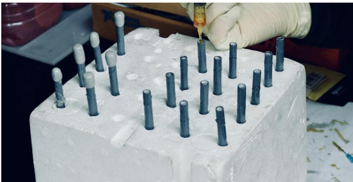
*Figura 20: Fase di riempimento e sigillatura delle capsule cementizie.*
