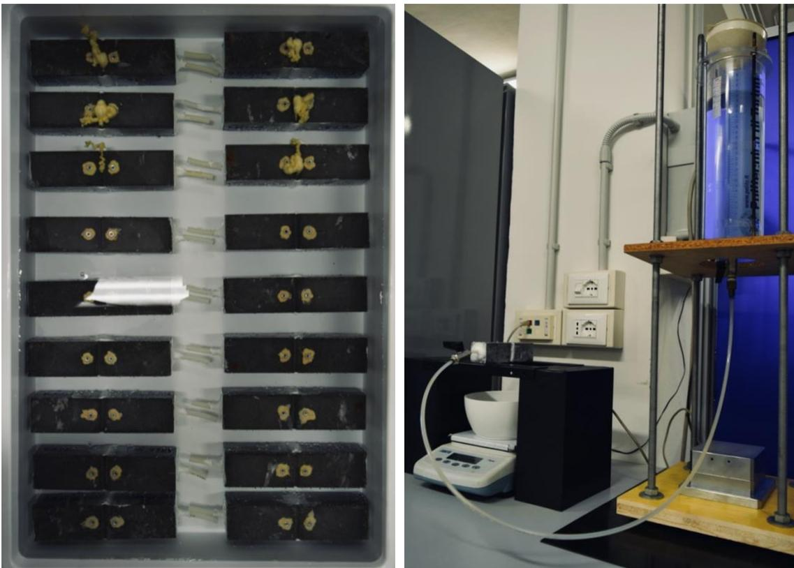
Figura 32: (a sinistra) provini immersi nell'acqua; (a destra) sistema utilizzato per svolgere la prova di permeabilità.
