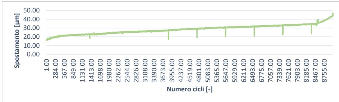
Grafico 26: Prova meccanica dinamica di un provino contenente una capsula PET, PET\_4.
