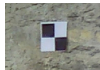
Figura 5.4 Esempio di target per la materializzazione dei GCP a parete. Foto acquisita dallo studente.
