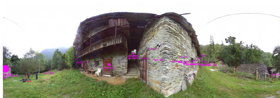
Figura 5.23 Visualizzazione planare di una delle scansioni effettuate, in cui sono identificati i target collimati per la georeferenziazione e la posizione degli altri scanner.
