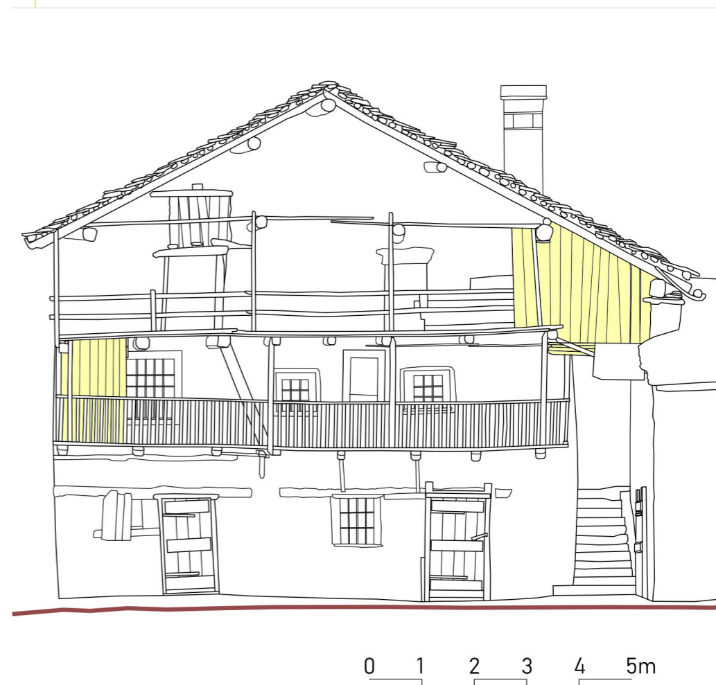
Figura 6.44 Spazi di immagazzinamento e deposito esterni, innestati sui balconi del corpo nuovo del Complesso Garnero con assito ligneo. Prospetto est Scala 1:100
