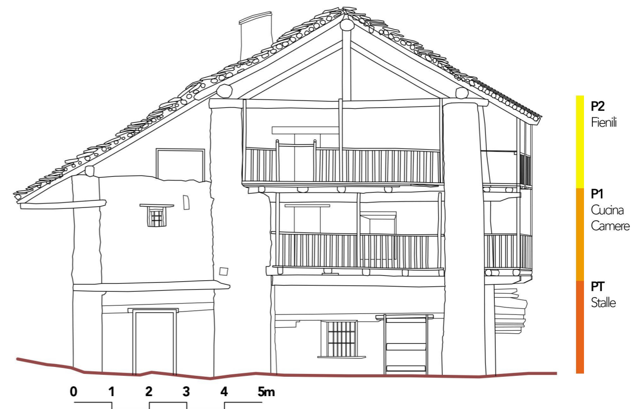
Figura 6.6 Prospetto principale della Casa delle Colonne, scala 1:100.
