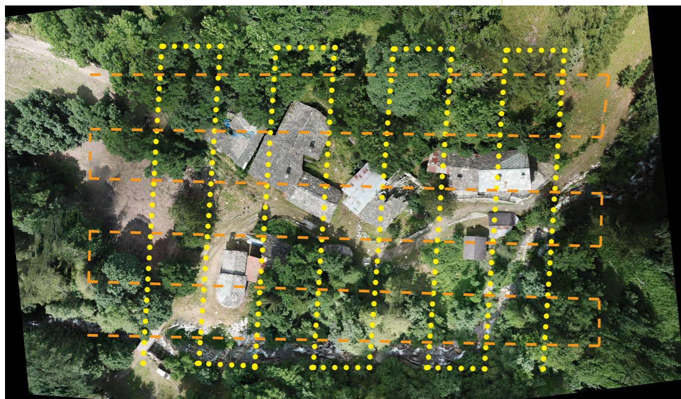
(Sopra) Figura 5.12 Direzioni delle traiettorie di volo per le acquisizioni fotogrammetriche a Molini Allioni (le linee non rappresentano le traiettorie reali effettuate, sono puramente indicative delle direzioni di volo).
