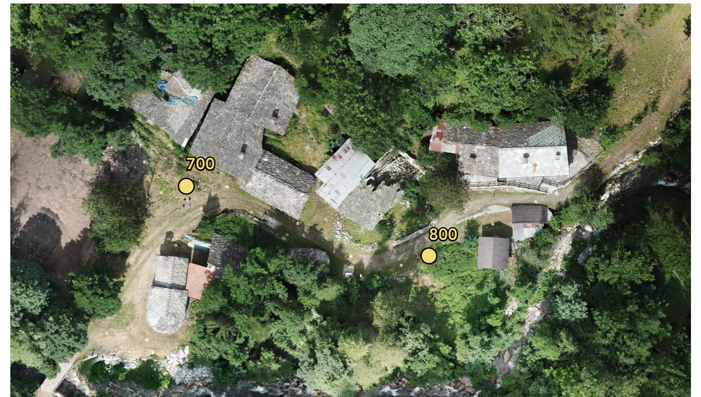
Figura 5.3 Posizione dei vertici della rete di inquadramento misurati. Ortofoto fotogrammetrica aerea georeferenziata in WGS84/UTM32N.
