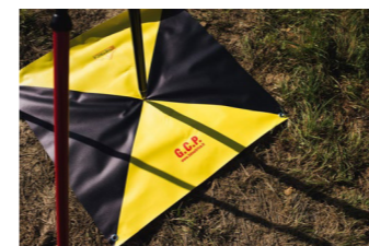
Figura 5.3 Esempio di target per la materializzazione dei GCP a terra. Fonte https://3dmetrica.it/wp-content/uploads/2017/10/Target-e-GPS-1024x684.jpg
