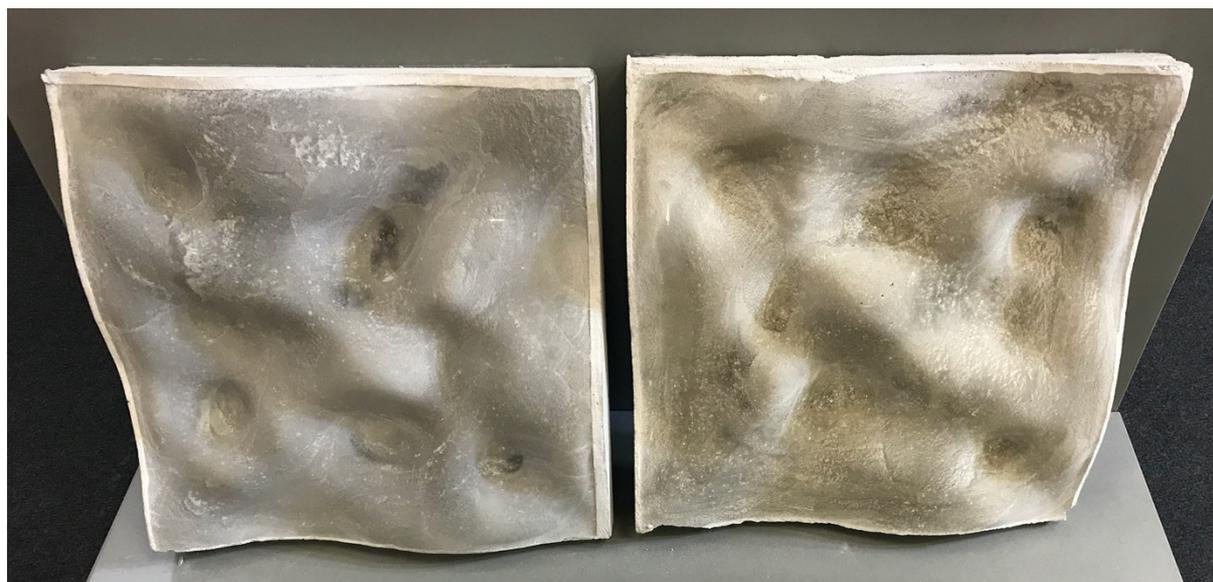
Figura 114 – Ripresa fotografica dei pannelli colati mono-densità esposti al SAIE di Bologna nel mese di ottobre 2020. I pannelli si caratterizzano per densità fresca pari a  $600 \text{ kg/m}^3$  (sinistra) e  $900 \text{ kg/m}^3$  (destra).
