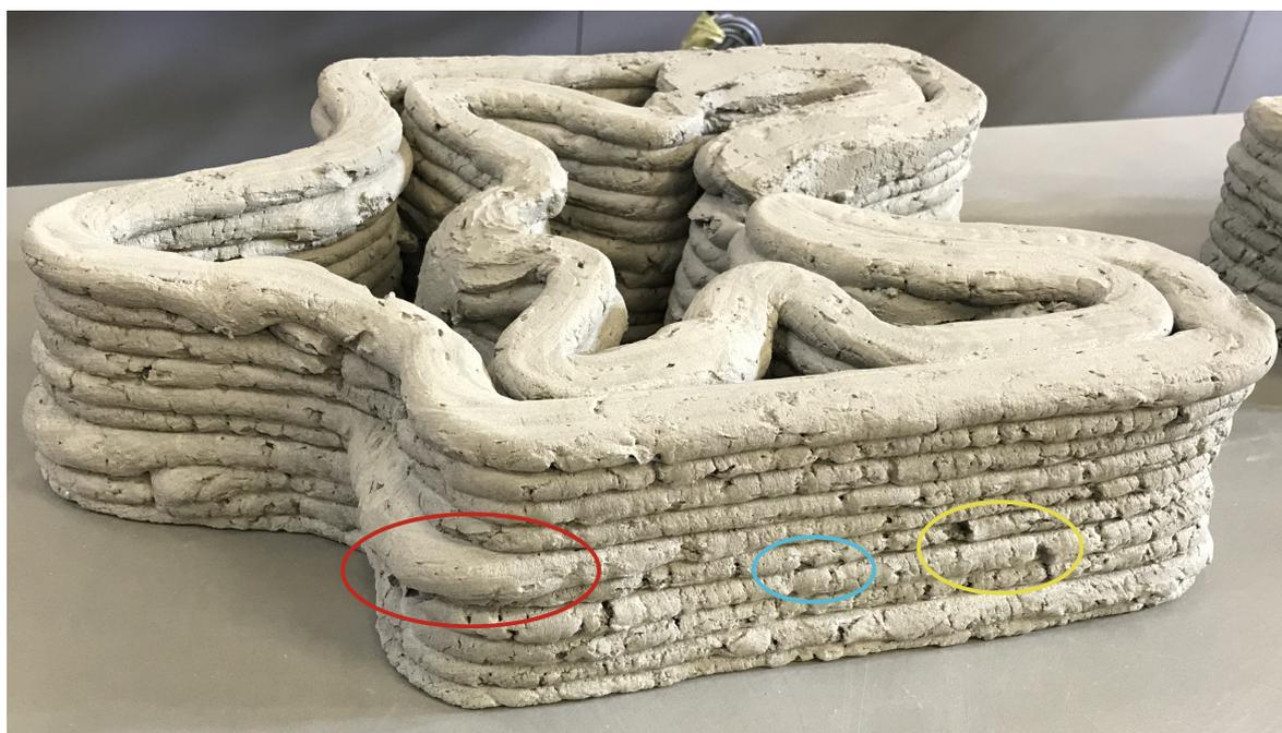
Figura 128 - Ripresa fotografica del blocco ad incastro maschio-femmina esposto al SAIE di Bologna nel mese di ottobre 2020, con evidenziazione dei principali difetti presenti allo stato indurito: "scivolamenti" (in rosso), "spaccature" (in giallo) e cavità dovute alla presenza di bolle di dimensioni eccessiva (in azzurro).
