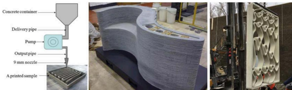
Figura 10 – Funzionamento del processo di 3D Concrete Printing (sinistra). Esempi di realizzazioni: muro panchina (centro) e elemento di facciata progettato in modo parametrico da Bruil (2017) [20].
