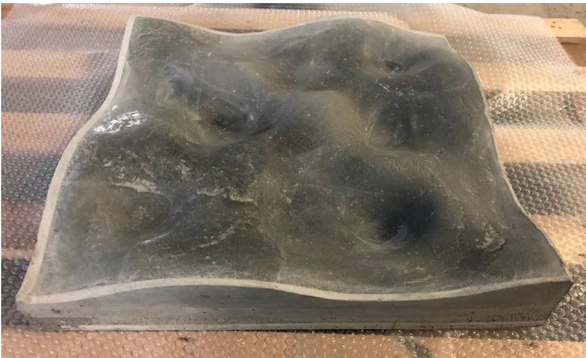
*Figura 113 – Riprese fotografiche eseguite alla fine del processo di scasseratura del pannello colato a densità fresca pari a  $600 \text{ kg/m}^3$ .*
