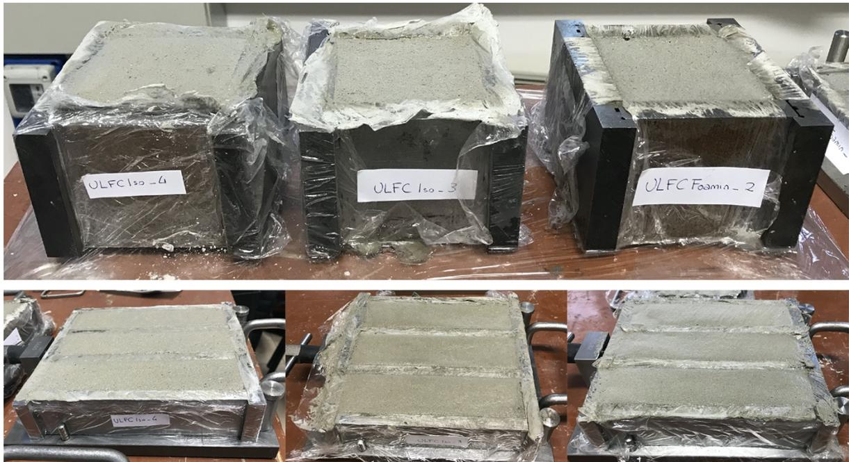
Figura 40 – Riprese fotografiche dei campioni cubici e prismatici allo stato fresco relativi agli impasti ULFC Iso\_4 (sinistra), ULFC Iso\_3 (centro) e ULFC Foamin\_2 (destra).
