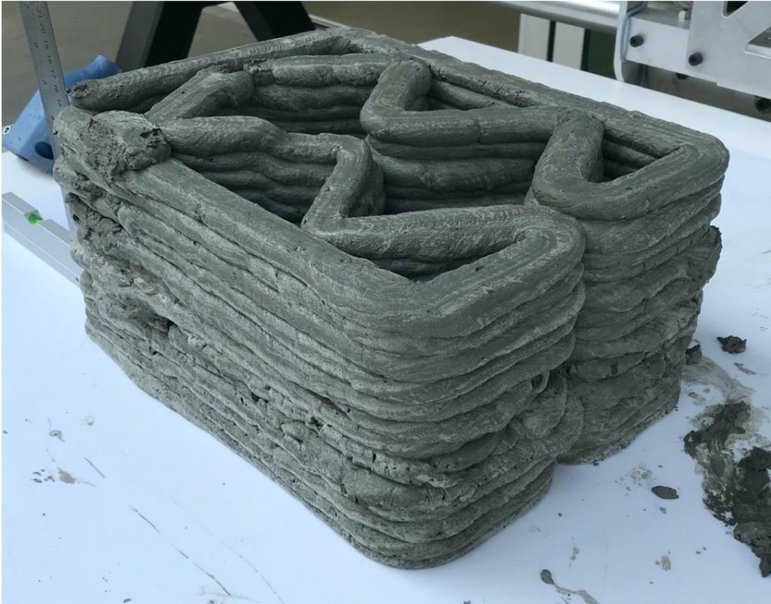
*Figura 134 - Ripresa fotografica eseguita lateralmente alla fine del processo estrusivo del componente effettivamente realizzato in seguito al ridimensionamento della soluzione 1 progettata per la fabbricazione in situ.*
