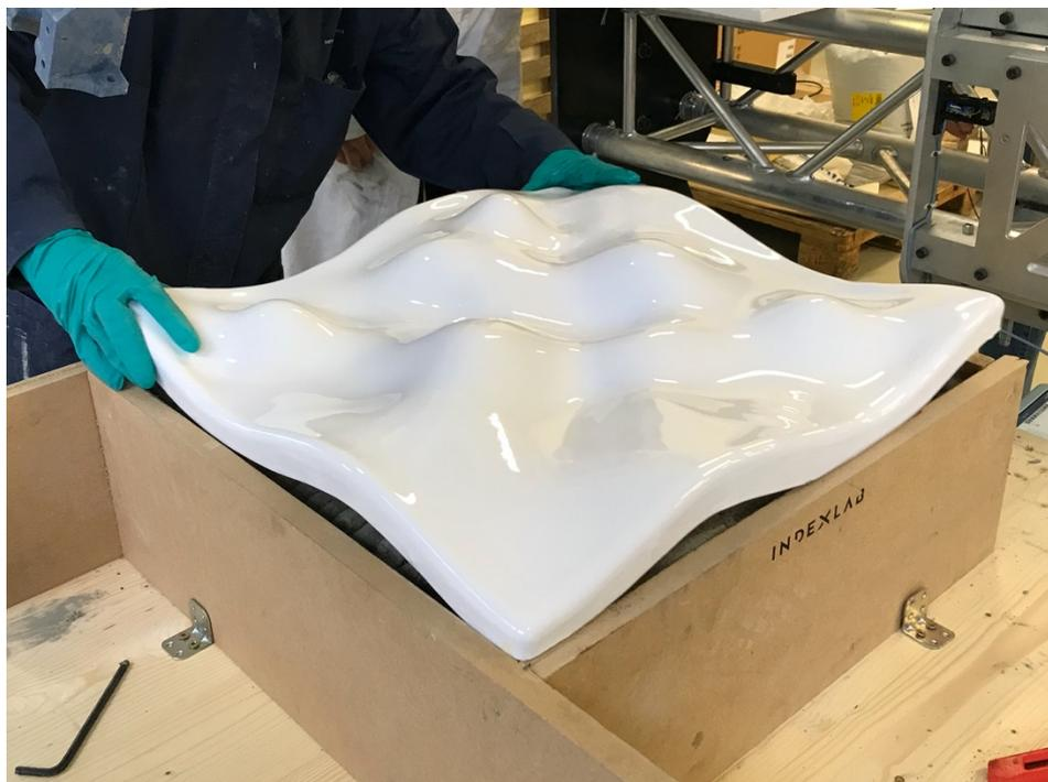
*Figura 119 – Ripresa fotografica eseguita al momento del posizionamento della superficie superiore di chiusura della cassaforma removibile impiegata per la realizzazione del pannello estruso.*
