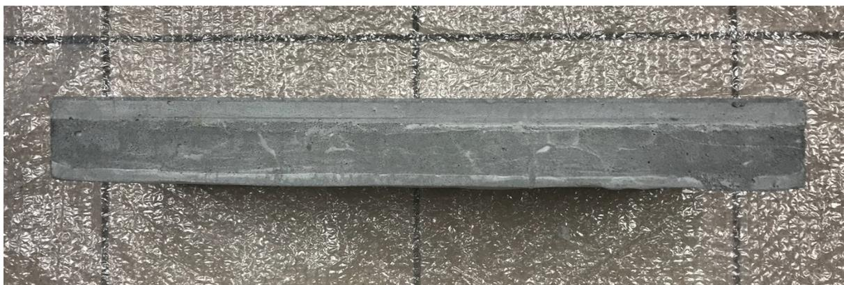
Figura 112 – Ripresa fotografica della stratificazione del pannello multistrato colato in cassaforma removibile. Si evidenzia l'adesione tra strati a differente densità.
