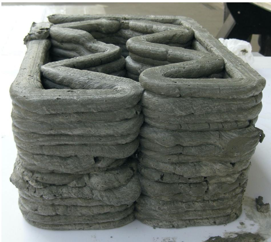
Figure 136 - Ripresa fotografica eseguita lateralmente alla fine del processo estrusivo del componente effettivamente realizzato in seguito al ridimensionamento della soluzione 1 progettata per la fabbricazione in situ.
