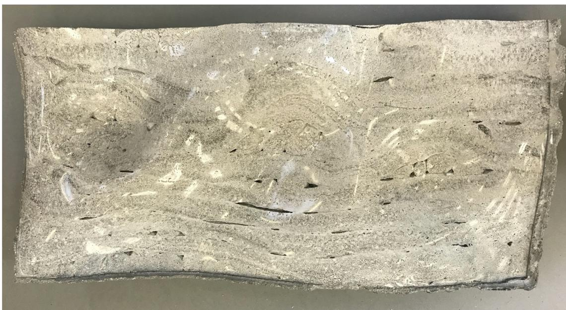
*Figura 120 – Ripresa fotografica della sezione di pannello estruso esposta al SAIE di Bologna nel mese di ottobre 2020. Si evidenziano la finitura lucida che caratterizza la superficie del pannello, la visibilità del percorso di stampa eseguito per la realizzazione dello strato superficiale, e la presenza di alcune cavità causate dalla presenza di bolle di dimensione eccessive nell'impasto impiegato per l'estrusione.*
