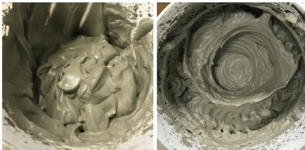
Figura 38 – Riprese fotografiche degli impasti finali realizzati con due differenti agenti tensioattivi schiumogeni: Foamin C (sinistra) e Isocem S/B (destra). Gli impasti appaiono differenti per consistenza e aspetto.
