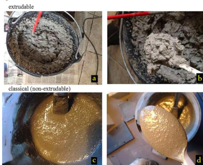
Figura 32 – Confronto qualitativo a livello di consistenza, coesione e viscosità allo stato fresco tra un impasto di calcestruzzo schiumato estrudibile (sopra) e uno di calcestruzzo schiumato classico (sotto) realizzati entrambi per ottenere una densità finale pari a  $600 \text{ kg/m}^3$  [9].
