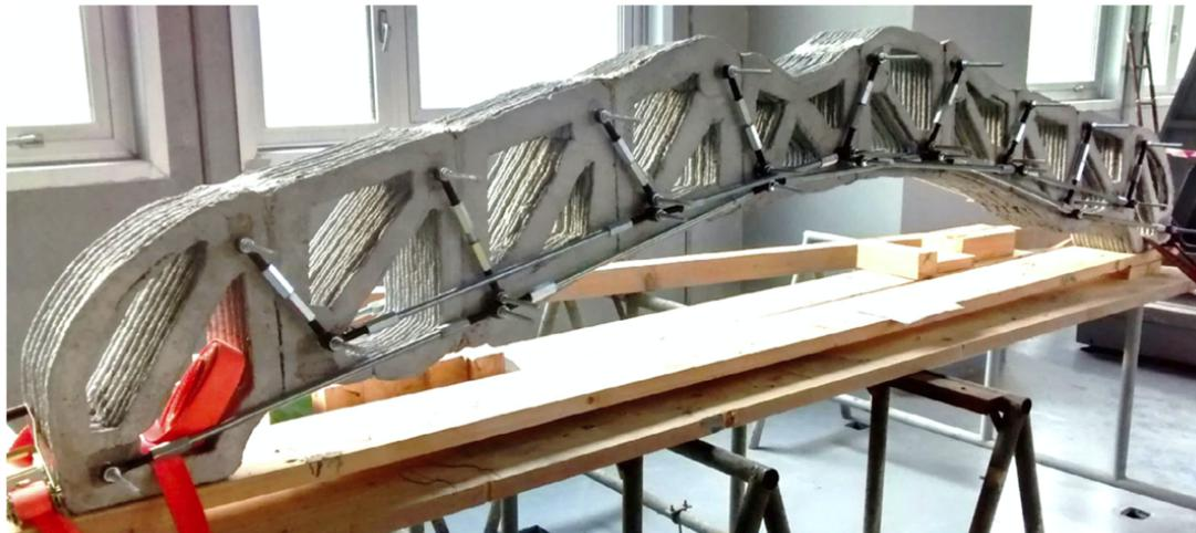
Figura 21 – Esempio di realizzazione di una trave a sezione variabile stampata in 3D con integrazione successiva delle armature di rinforzo in acciaio [1].
