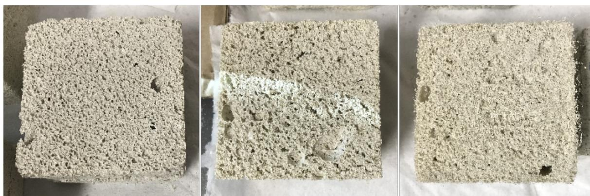
Figura 44 – Riprese fotografiche di una delle facce interne emerse in seguito al taglio del campione cubico realizzato con gli impasti ULFC Foamin\_2 (sinistra), ULFC Iso\_3 (centro) e ULFC Iso\_4 (destra).
