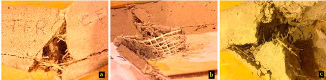
Figura 20 – Provini con rinforzo in griglia bidirezionale in fibra di vetro e fibre disperse in seguito alla prova di trazione per flessione [9].
