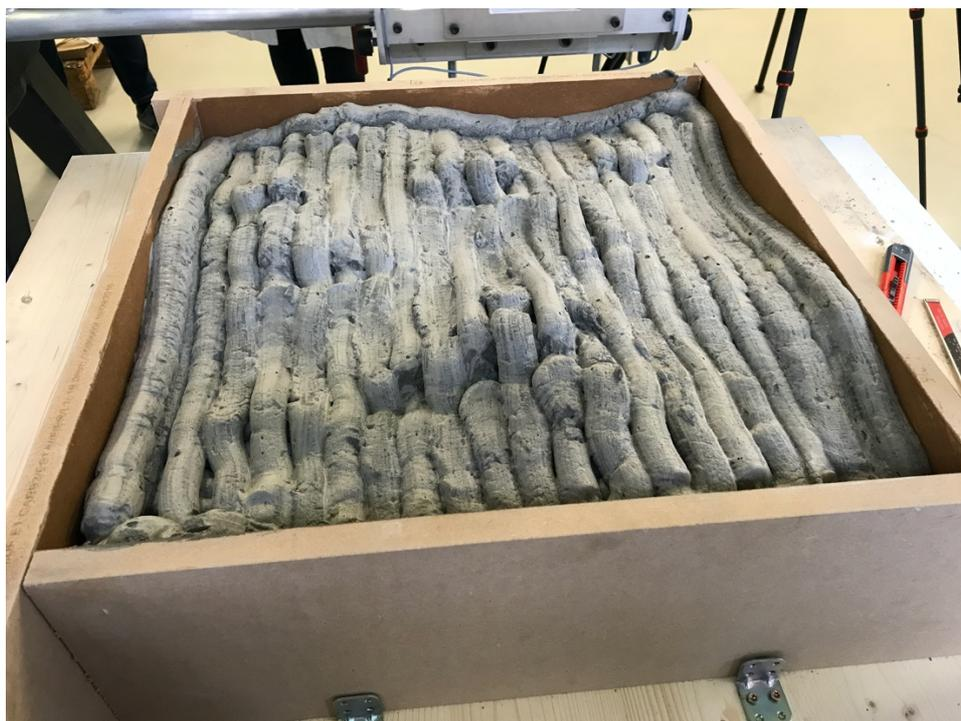
*Figura 118 – Ripresa fotografica eseguita alla fine del processo estrusivo di realizzazione del pannello estruso in cassaforma removibile.*
