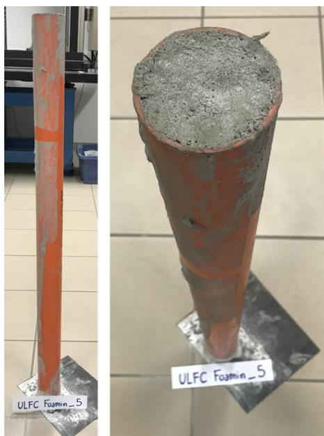
Figura 75 – Riprese fotografiche eseguite sulla colonna alta 1 m in seguito all'indurimento. Si evidenzia il mancato collasso del materiale.
