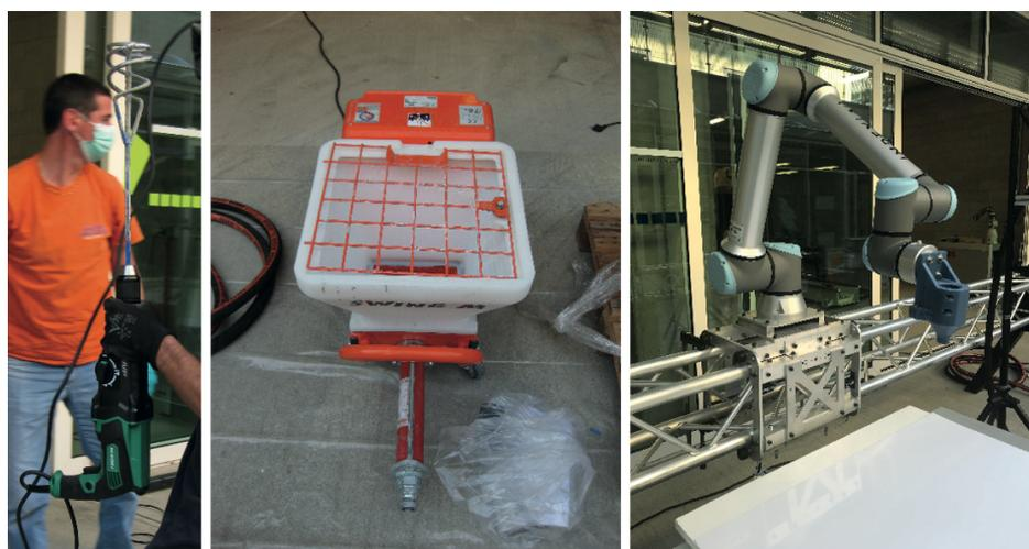
Figura 106 – Riprese fotografiche degli strumenti impiegati durante il processo di realizzazione dei componenti: miscelatore (sinistra), pompa per calcestruzzo (centro) e robot collaborativo (destra).
