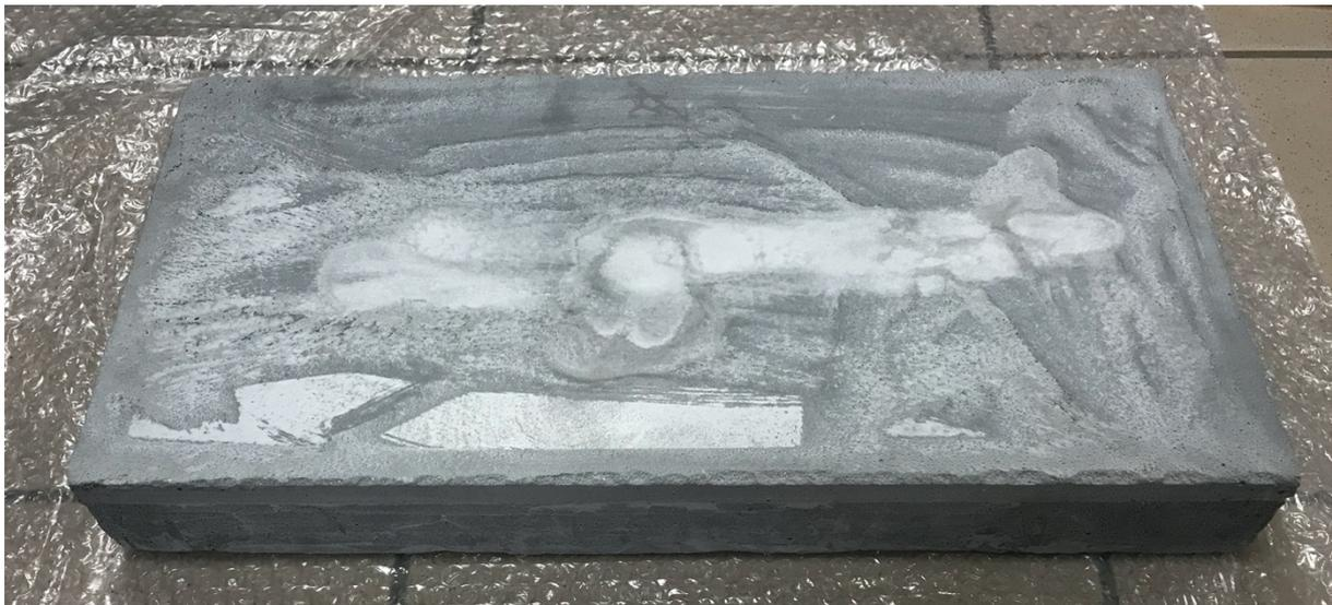
*Figura 111 – Ripresa fotografica del pannello multistrato colato in cassaforma removibile.*
