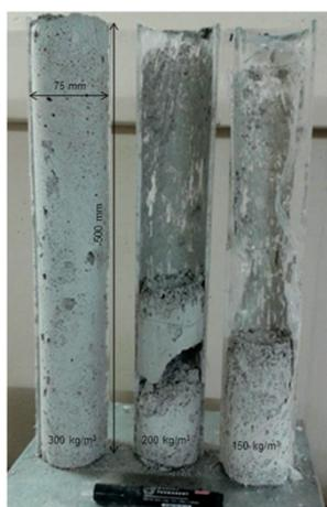
Figura 27 – Esempio di instabilità del mix fresco sperimentata in laboratorio in impasti ultra-low density di calcestruzzo schiumato. Partendo da sinistra la densità finale del mix è pari a 300, 200 e 150 kg/m<sup>3</sup> [14].
