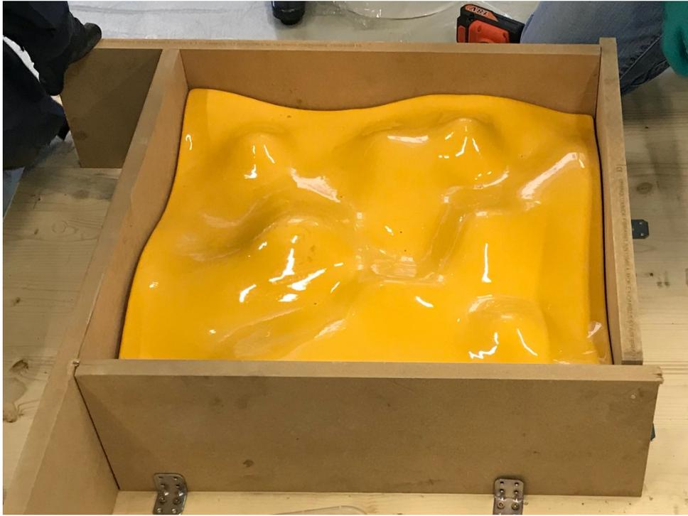
*Figura 110 – Ripresa fotografica della cassaforma impiegata per la realizzazione dei pannelli colati a mono-densità e del pannello estruso.*
