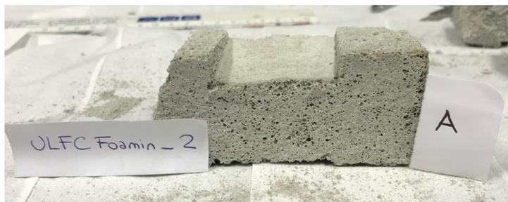
Figura 66 – Ripresa fotografica realizzata alla fine della prova di resistenza a compressione svolta sul campione ULFC Foamin\_2 – A1. Si evidenzia che la compressione esercitata sul campione ha prodotto solamente lo schiacciamento dello stesso per via dell'elevata porosità che caratterizza il campione.
