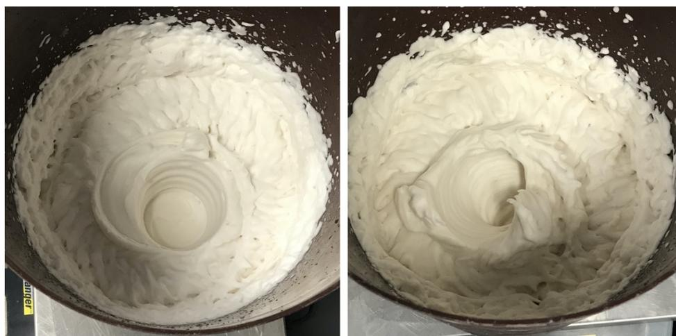
Figura 37 – Riprese fotografiche delle schiume preformate realizzate con due differenti agenti tensioattivi schiumogeni: Focamin C (sinistra) e Isocem S/B (destra). Le schiume appaiono differenti sia per consistenza che per colore (bianca la prima e giallina la seconda).
