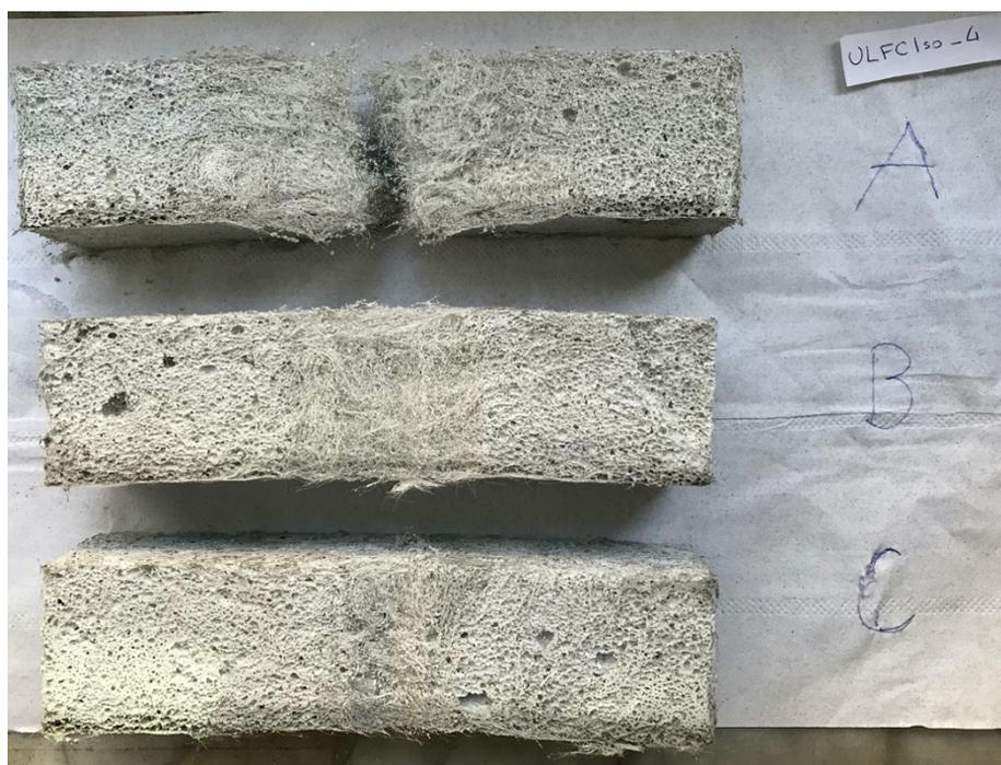
Figura 55 - Ripresa fotografica dei monconi ottenuti alla fine delle prove di trazione per flessione eseguite sui campioni realizzati con l'impasto ULFC Iso\_4. Si evidenzia che nei campioni B e C non è avvenuta la netta separazione dei due monconi.
