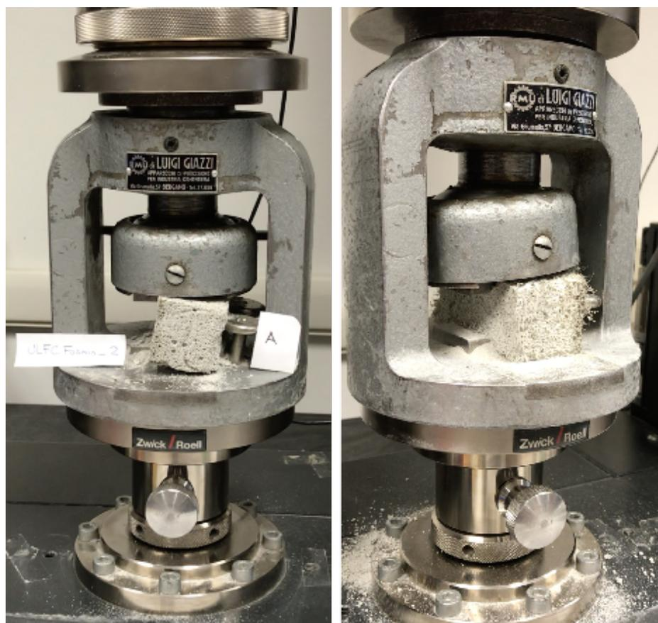
Figura 65 - Riprese fotografiche realizzate al termine della prova di resistenza a compressione svolte sui campioni ULFC Foamin\_2 – A1 (sinistra) e ULFC Iso\_4 – A1 (destra).
