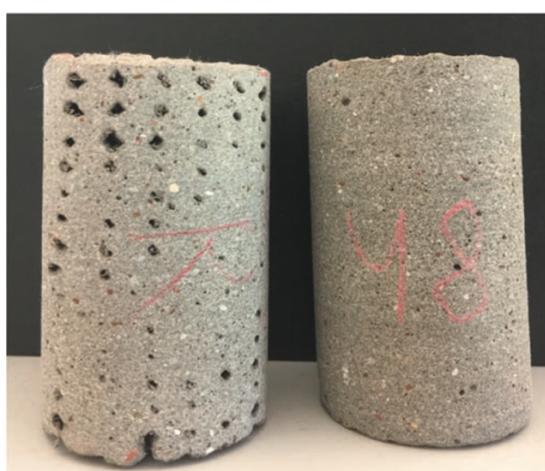
Figura 14 – Esempio di elementi caratterizzati da densità di filamento variabile (sinistra) e costante (destra). Nel primo caso si possono riconoscere chiaramente i vari strati e si riscontra la presenza di vuoti di varie dimensioni, mentre nel secondo l’elemento risulta omogeneo, coerente, frutto di un’estrusione di qualità [4].
