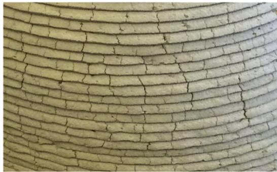
Figura 15 – Esempio di fessurazioni da ritiro in un elemento realizzato tramite *3D Concrete Printing* [6].
