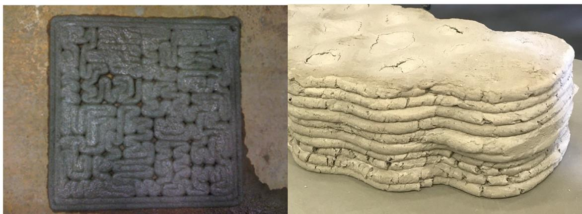
Figura 16 – Esempio di «tratteggio» in cui è evidente l'effetto del cambiamento di direzione dell'ugello sulla densità dello strato (sinistra) [4] ed esempio di riempimento colato all'interno di un perimetro estruso (destra) [fotografia dell'autore].
