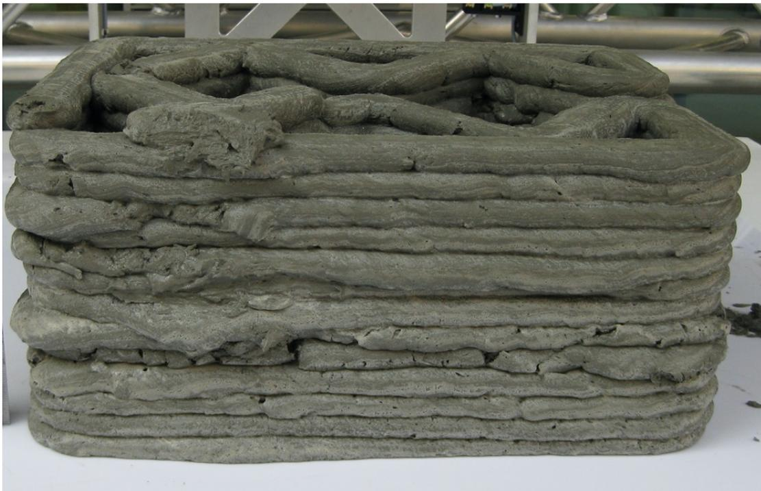
*Figura 135 - Ripresa fotografica eseguita frontalmente alla fine del processo estrusivo del componente effettivamente realizzato in seguito al ridimensionamento della soluzione 1 progettata per la fabbricazione in situ.*
