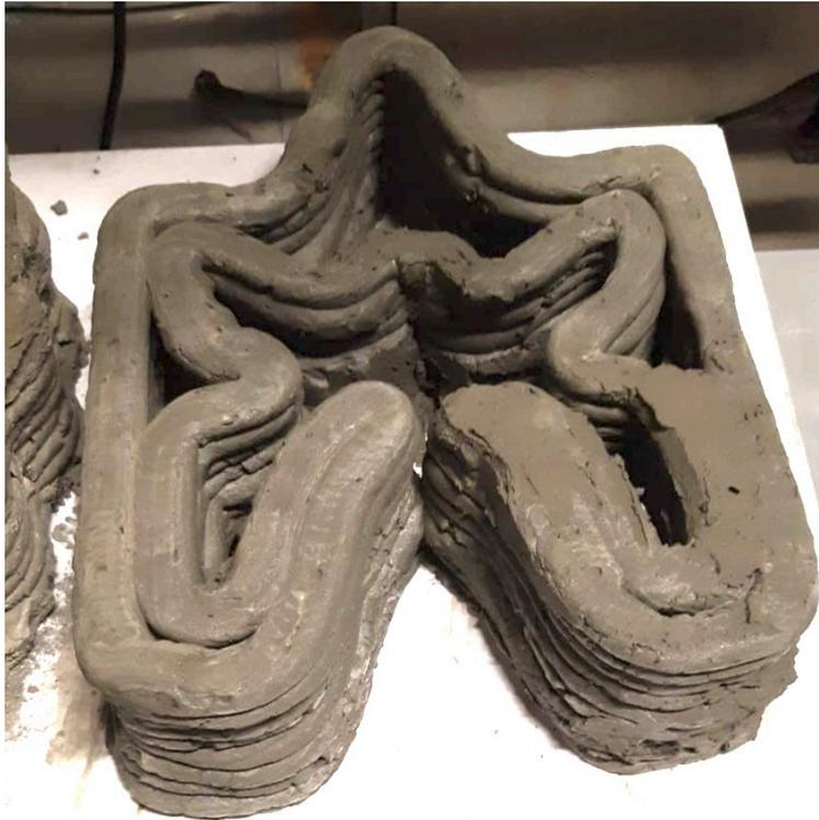
*Figura 125 – Ripresa fotografica eseguita alla fine del processo estrusivo svolto per la realizzazione del blocco ad incastro-maschio femmina.*
