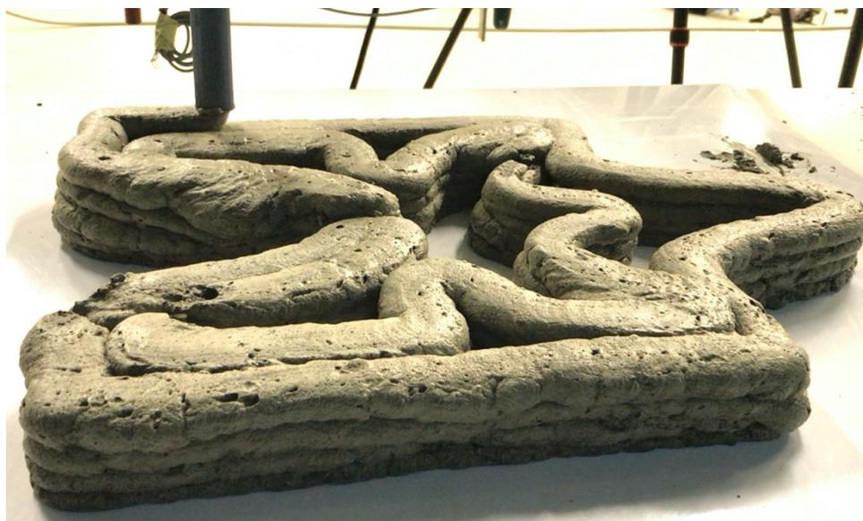
*Figura 124 – Ripresa fotografica eseguita durante il processo estrusivo svolto per la realizzazione del blocco ad incastro maschio-femmina.*
