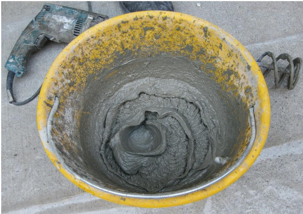
Figura 108 – Ripresa fotografica eseguita alla fine del processo di miscelazione del calcestruzzo schiumato estraibile impiegato per il processo estrusivo.
