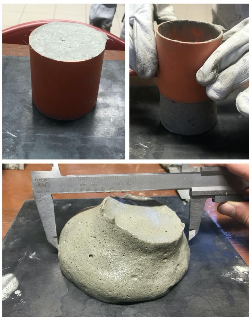
Figura 42 – Riprese fotografiche realizzate in durante lo svolgimento dello slump test realizzato con l'impasto ULFC Foamin\_5.
