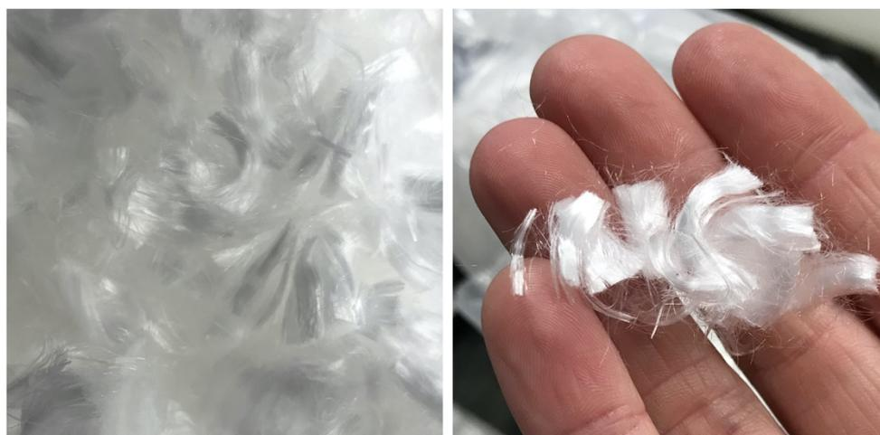
Figura 39 – Riprese fotografiche delle microfibre in polipropilene Masterfiber012 impiegate nella realizzazione degli impasti ULFC Iso\_4 e ULFC Foamin\_5.
