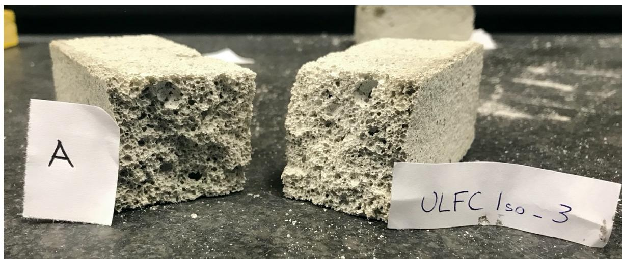
Figura 56 - Ripresa fotografica dei due monconi ottenuti alla fine della prova di trazione per flessione eseguita sul campione ULFC Iso\_3 - A.
