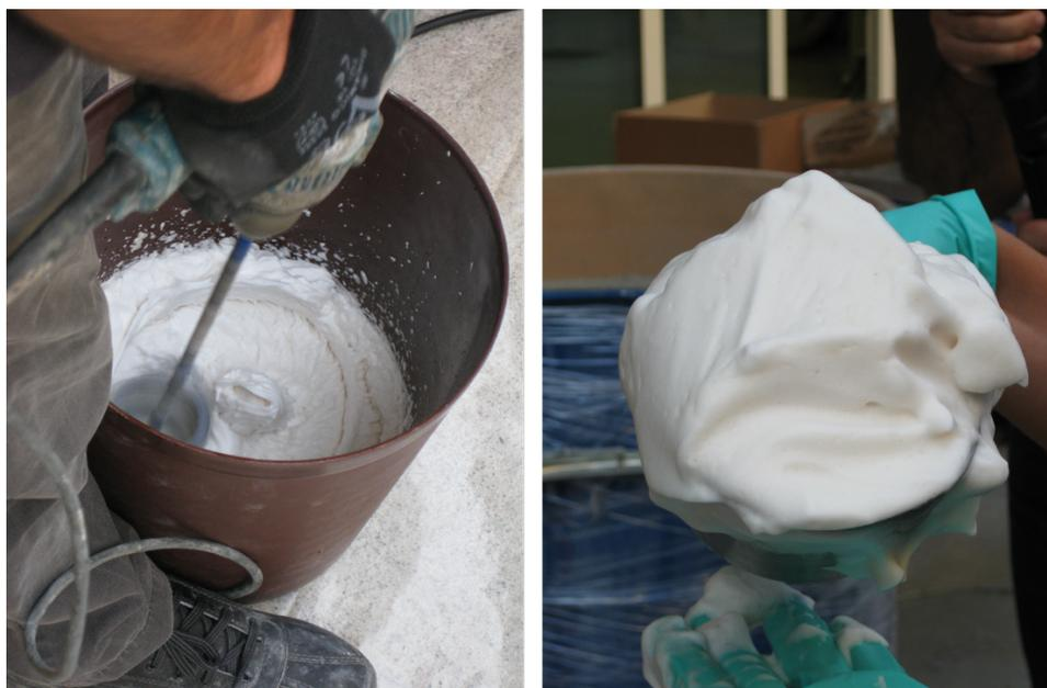
Figura109 – Riprese fotografiche della schiuma preformata impiegata per la realizzazione dei pannelli colati. Fase di miscelazione di acqua e tensioattivo schiumogeno (sinistra) e schiuma alla fine del processo di miscelazione (destra).
