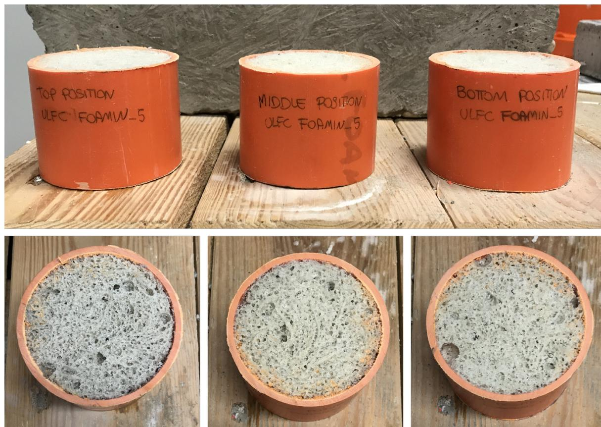
Figura 76 – Riprese fotografiche delle sezioni cilindriche effettuate sulla colonna alta 1 m a differenti quote: nella metà superiore (sinistra), in posizione mediana (centro) e nella metà inferiore (destra).
