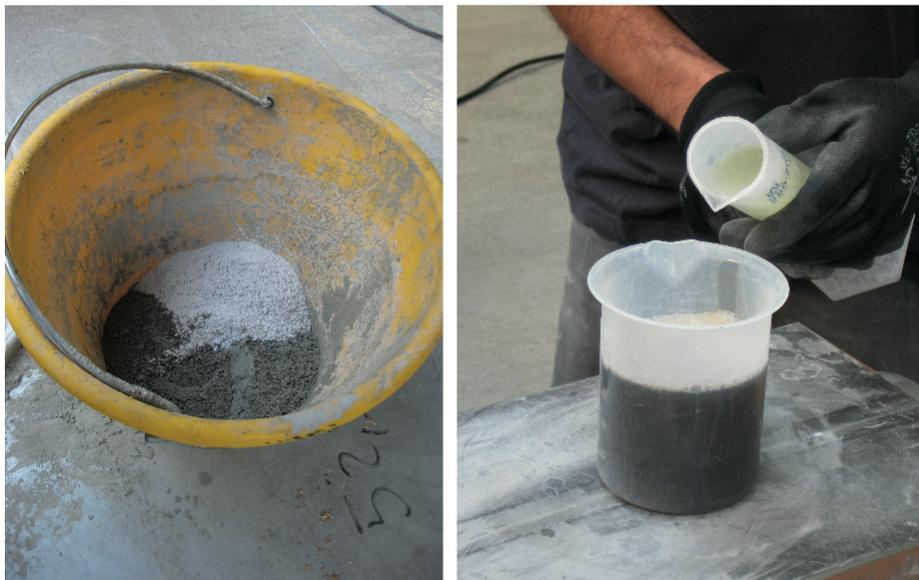
Figura 105 – Riprese fotografiche degli ingredienti in stato di polveri (sinistra) e di liquidi (destra) impiegati per la realizzazione del calcestruzzo schiumato estrudibile. Tra le polveri vi sono il cemento e il viscosizzante; mentre tra i liquidi vi sono l'acqua, il tensioattivo schiumogeno e l'additivo superfluidificante.
