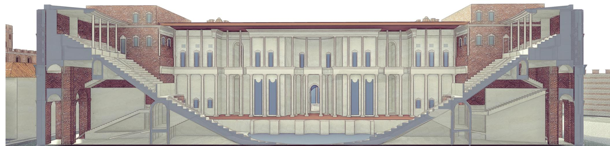
FIG 3.34 - Sezione del teatro romano per evidenziarne la struttura. (III FASE)
